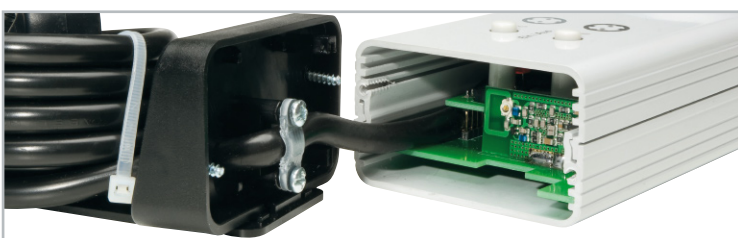
Bild 14: Elektronik-Platine, Taster und Netzkabel sitzen richtig, jetzt sind nur noch die Endkappen anzuschrauben.
