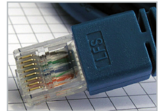
Bild 3: 8 Schleifkontakte im RJ45-Stecker gleiten beim Einstecken über die korrespondierenden Kontaktfedern der Buchse.
