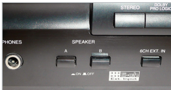
Bild 2: Manche Stereo-Receiver und -Verstärker ermöglichen bereits intern den Anschluss und die Auswahl mehrerer Lautsprecherpaare
