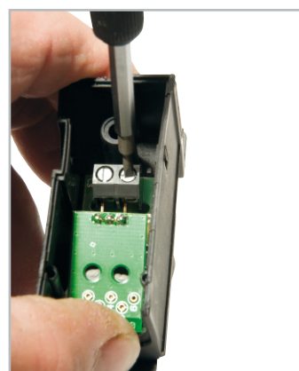
Bild 4: Anschluss der Interfaceplatine an die Schraubklemme des Impulsnehmers
