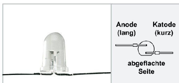
Bild 4: Im ersten Schritt werden die LED-Anschlüsse um 90 Grad abgebogen.
