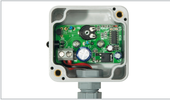
Bild 4: Im zugehörigen Gehäuse eingebaute IR-Sendeplatine
