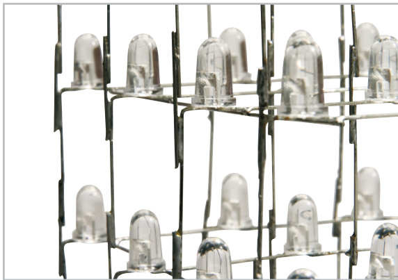
Bild 9: Ein Beispiel für das Verlöten der Katodenanschlüsse. Hier sind Silberdraht-Stücke eingefügt, um eine exakte Würfelform realisieren zu können.
