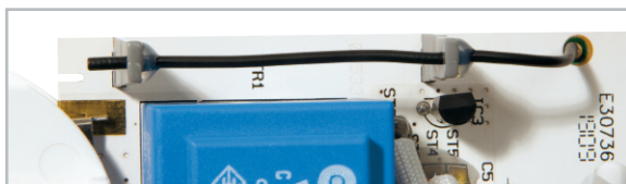
Bild 2: Fixierung der Antenne in den Antennenhaltern
