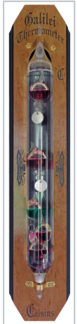
Bild 5: Das Prinzip des Galilei-Thermometers: Mit zunehmender Temperatur fällt die Dichte von Wasser, die Schwimmkörper erhalten weniger Auftrieb und sinken. (Quelle: Wikipedia)
