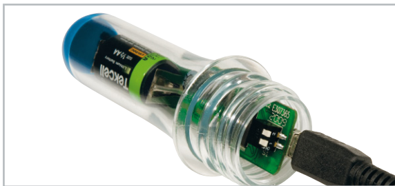
Bild 2: Der Anschluss des USB-Kabels am Datenlogger. Auch die Lage der DIP-Schalter ist hier gut zu sehen
