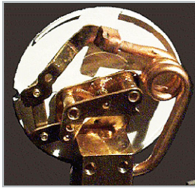
Bild 7: Eine Bourdonfeder streckt sich bei zunehmendem Druck des inneren Gases. (Quelle: Wikipedia)
