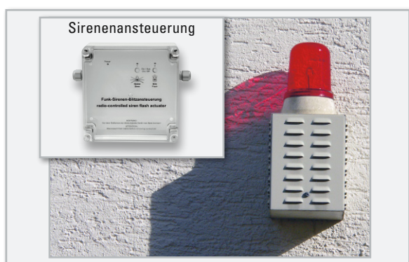
Bild 6: Die Funk-Sirenenansteuerung steuert 12-V-Signalgeräte (Sirenen/Blitzleuchten) an, versorgt diese und leitet die Meldungen der Sabotagesicherungen dieser Geräte an die Zentrale weiter.
