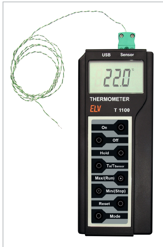
Bild 16: ELV T 1100: ein handliches, genaues Temperaturmessgerät (-40...+1000 °C) auf Thermoelementbasis mit Datenlogger
