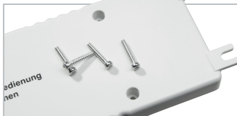
Bild 13: Das Verschrauben der beiden Gehäusehälften erfolgt von der Unterseite mit 4 Schrauben für Kunststoff 2,0 x 12 mm.
