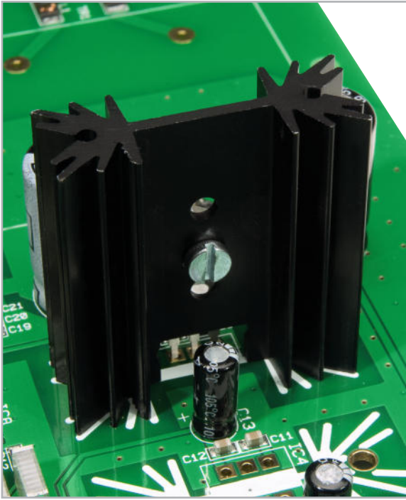
Bild 8: Korrekte Montage des Spannungsreglers IC 1 und dessen Kühlkörper
