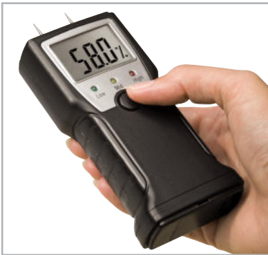
Bild 18: Über eine Widerstandsmessung zwischen zwei Einstechelektroden lassen sich mit diesem Messgerät Aussagen über den Feuchtegrad von Holz machen.
