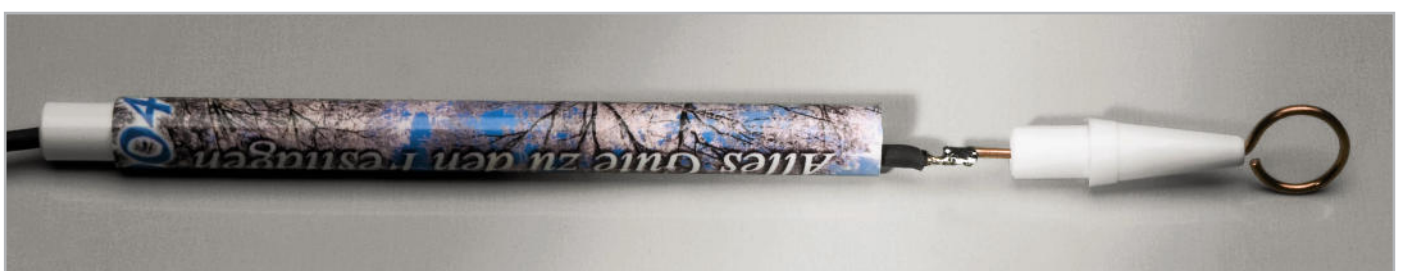
Bild 6: Der Einbau des Verbindungskabels und der Anschluss an die Drahtschleife
