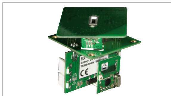
Bild 15: Die Anordnung der Platinen des fertig vormontierten FS20 PIRU, hier zur besseren Übersicht ohne Abdeckplatte.
