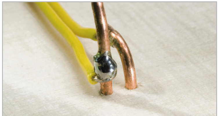
Bild 5: So erfolgt die Verbindung zwischen Parcours-Draht und Anschlussleitungen.
