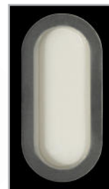
Bild 11: Das PIR-Abdeckfenster besteht aus infrarotdurchlässigem Kunststoff, es wird von hinten in die Abdeckplatte eingelegt.
