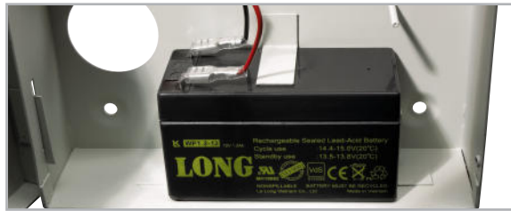
Bild 12: Der Blei-Gel-Notstromakku ist an die dafür vorgesehene Position im Gehäuseunterteil zu setzen.
