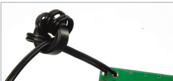
Bild 4: Die Leitung des Temperatursensors ist in vier Windungen um den Ferritkern zu wickeln.
