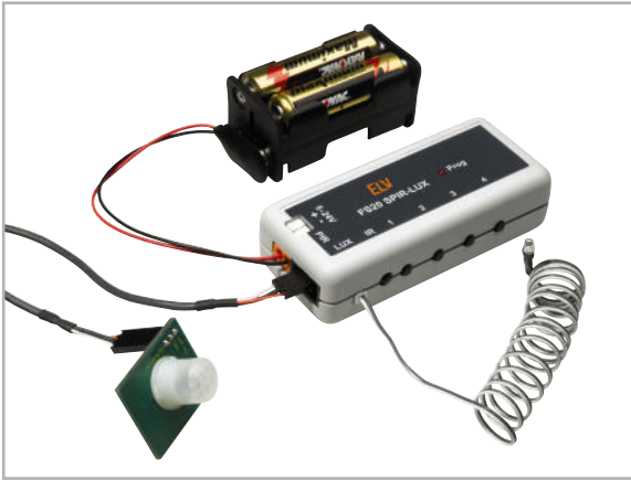
Bild 10: Komplett beschaltetes Sendemodul mit PIR 13, Helligkeitssensor und Batteriestromversorgung
