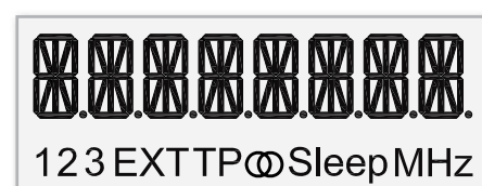
Bild 6: Die Segmente des Displays
