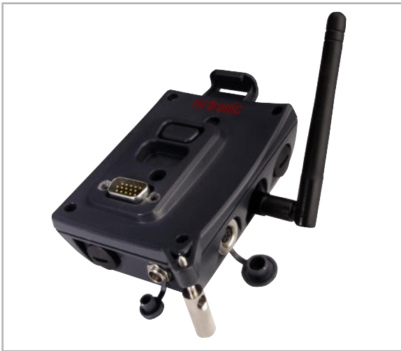
Bild 31: Eine Dockingstation bindet Messfühler drahtlos in ein Datennetzwerk ein. (Quelle: Rotronic)
