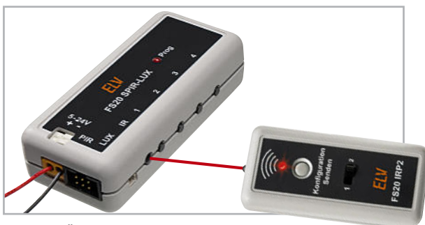
Bild 16: Die Übertragung der Infrarot-Signale muss mit genau aufeinander ausgerichteten Geräten und auf kurze Distanz erfolgen (der rote Strahl im Bild symbolisiert den Übertragungsweg)
