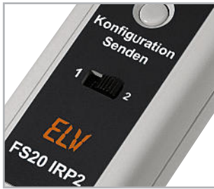
Bild 15: Auswahlschalter für die zwei Konfigurations-Speicherplätze
