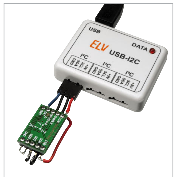
Bild 10: „Fliegende Verbindung“ des 3D-BS mit dem USB-I 2 C-Interface
