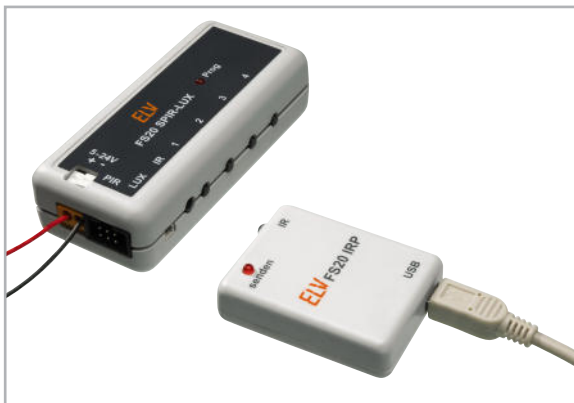
Bild 3: So erfolgt die Übertragung der bequem am PC erarbeiteten Konfiguration via Infrarot-Interface, hier mit dem FS20 IRP.
