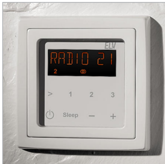
Bild 2: Das Radio in der Unterputz-Schalterdose
