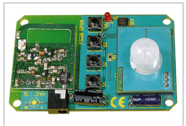
Bild 1: Der Vorgänger FS20 SPIR war für das direkte Auflöten des PIR 13 vorgesehen.
