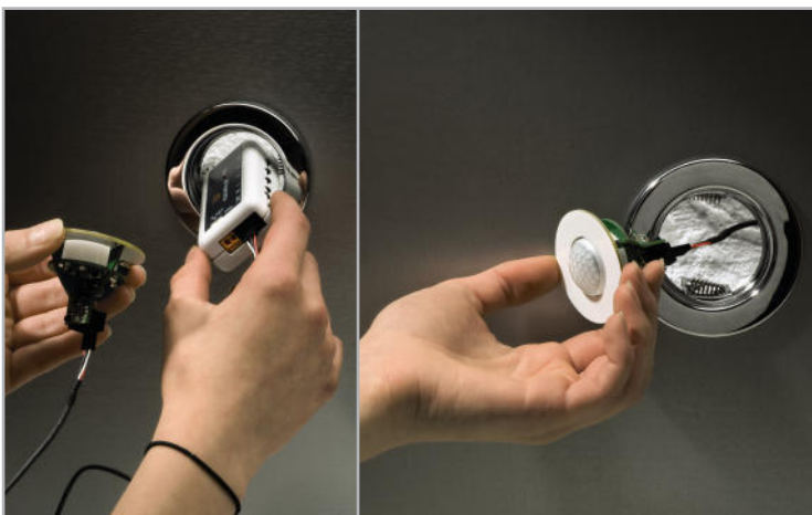
Bild 5: Der FS20 SPIR-LUX lässt sich einfach durch die Montageöffnung der Halogenlampenfassung hindurch einsetzen. Hier ist der PIR MR16 angeschlossen.
