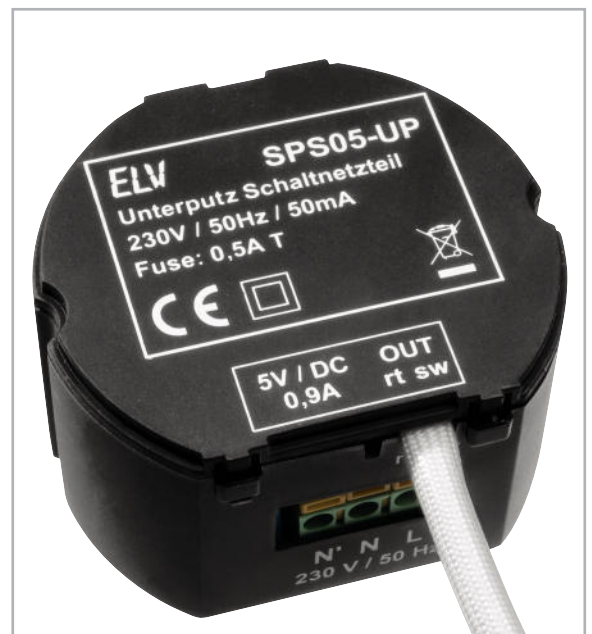
Bild 8: Fertig aufgebautes Schaltnetzteil SPS05-UP im UP-Gehäuse
