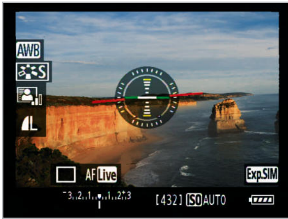
Bild 2: Kamera mit Beschleunigungssensor: optische Unterstützung zur einfachen Ausrichtung des Bildhorizonts (Foto: Canon)
