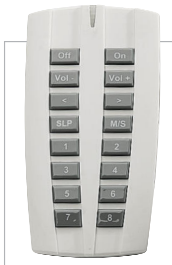
Bild 4: Die Tasten der Fernbedienung FS20 S16 UP sind mit allen Bedienfunktionen des Radios bedruckt.
