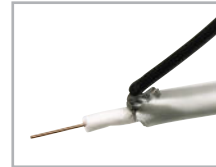
Bild 6: Ein Schrumpfschlauch-Abschnitt dient zur Isolation der Koax-Kabel-Abschirmung.
