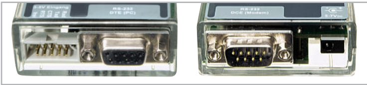
Bild 1: Hier sind die Schnittstellen des SDS1 gezeigt. Von links nach rechts: 3-bis-5-V-TTL-Eingang, RS232-Buchse, RS232-Stecker, externe 5-bis-7-Vdc-Versorgung.
