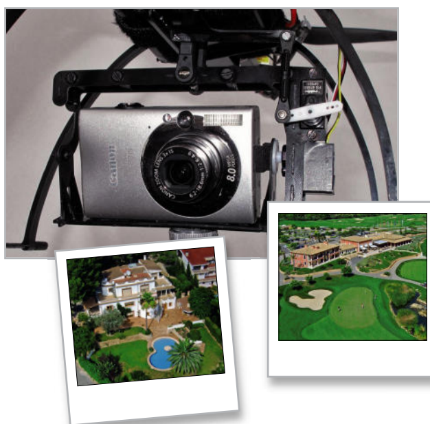
Bild 15: Mit einer solchen professionellen Kamerahalterung (oben) mit Nick-/Roll-Steuerung gelingen Top-Luftbilder. (Luftbild: BerlinVR.de)
