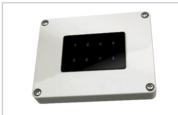
Bild 10: Frontplatte ohne Gehäusedurchbruch vor ein IP-65-Gehäuse geklebt
