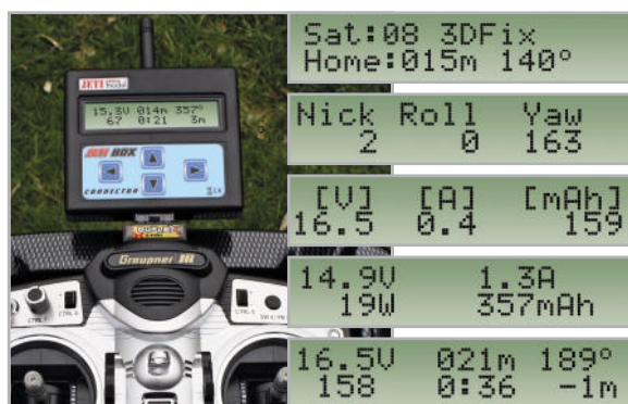
Bild 14: Die Jeti-Box holt sich alle wichtigen Flugparameter aus dem Datenstrom zwischen 2,4-GHz-Sender und Empfänger und zeigt diese direkt an.
