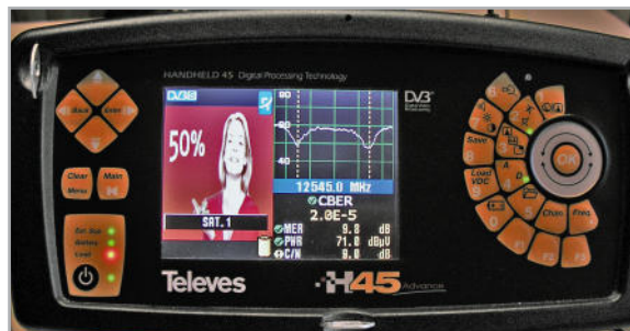
Bild 15: Die Frequenzgangdelle in Bild 14 oben rechts manifestiert sich in mäßigen Werten für C/N und MER. Die Screenshots stammen vom Messempfänger Teles H45 advance.
