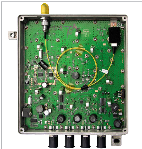
Bild 12: Das Innenleben eines Virtual Quads. Oben ist der optische Eingang zu sehen, von dem eine Glasfaser zum optisch-elektrischen Wandler führt, unten erkennt man die vier coaxialen Ausgänge.
