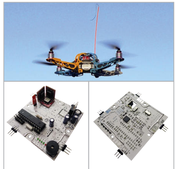
Bild 2: Das QuadroControl-III-Projekt fällt durch flexible Gyro-Bestückung, integrierte Stromverteilung und die weitgehende Bestückung mit bedrahteten Bauteilen auf. Oben der kompakte und agile Logocopter des QuadroControl-Entwicklers in Aktion
