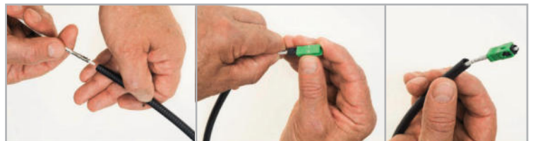
Bild 16: Bei Miniflex-Kabeln wird nur das Kabel mit ankonfektionierter Ferrule eingezogen. Am Ausgang des Leerrohrs wird die Ferrule durch wenige Handgriffe zum vollständigen Stecker ergänzt. (Quelle: Anpeq)
