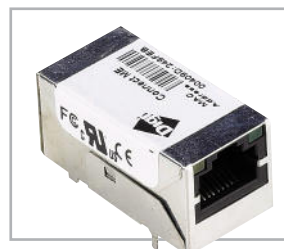
Bild 1: Modernste Web-Server sind nicht viel größer als eine Ethernet-Buchse, hier der Digi Connect ME® aus unserem WSEB1-Projekt.
