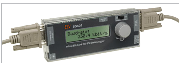
Bild 2: Der SDS1 lässt sich, wie gezeigt, zum Aufzeichnen in eine bestehende Datenverbindung einfügen, ohne diese zu beeinflussen.
