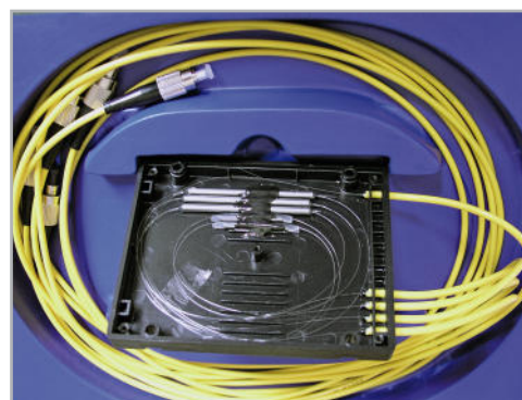
Bild 10: In einem optischen Vierfachverteiler wird das optische Eingangssignal auf vier optische Ausgangssignale gesplittet.
