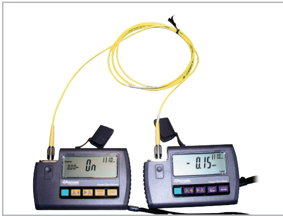
Bild 18: Eine optische Quelle für 1310 und 1550 nm (links) und ein optischer Leistungsmesser für dieselben Wellenlängenbereiche (KI 9800 Pocket Series von Kingfisher) sind für die qualifizierte Beurteilung des optischen Verteilsystems unerlässlich.
