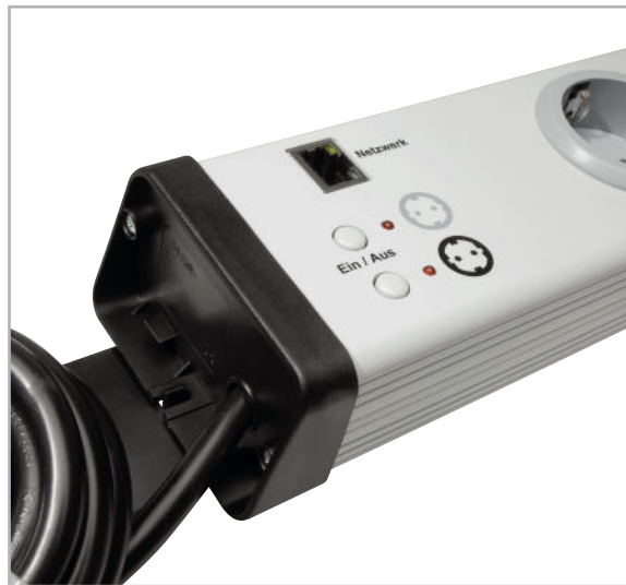
Bild 32: Nach abschließender Sichtkontrolle zum richtigen Sitz von Netzbuchse, Tastern und LEDs können die Endkappen aufgeschraubt werden.
