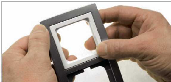
Bild 33: Der Adapterrahmen zur Aufnahme der Lautsprecher-Frontplatte wird in den Abdeckrahmen geklebt.
