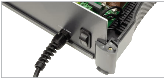
Bild 18: Das Netzkabel wird zuerst von außen durch einen Knickschutz geführt.
