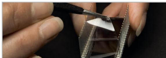
Bild 22: An der Displayunterseite ist die dünne Schutzfolie vorsichtig abziehen.
