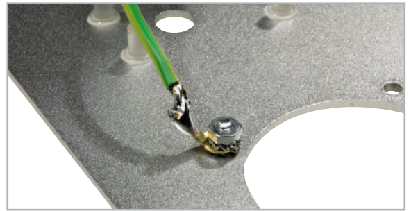
Bild 23: Verschrauben der Schutzleiteröse mit der Frontplatte
