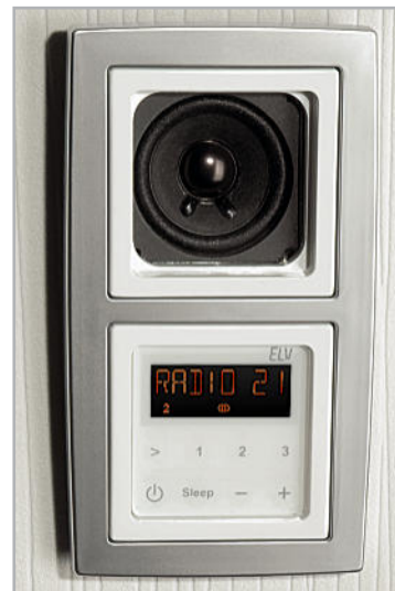
Bild 34: Montage der Radio-Frontplatte mit Adapter- und Abdeckrahmen
