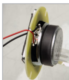
Bild 27: Das Unterputz-Netzteil SPS05-UP ist bei abgeschalteter Netzspannung anzuschließen und, wie abgebildet, in eine tiefe Schalterdose einzusetzen.
