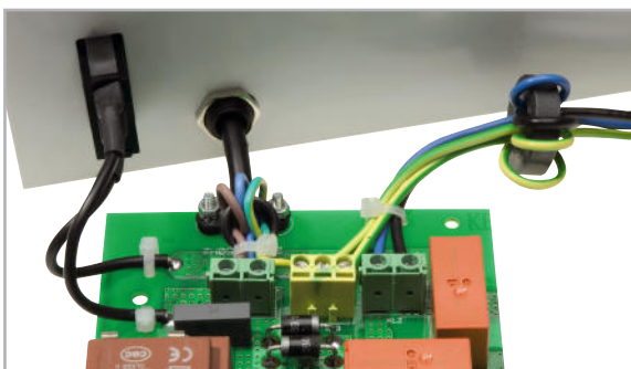
Bild 20: Anschluss der Steckdosenleitungen und Einbau des Ein-/Ausschalters in die Rückwand
