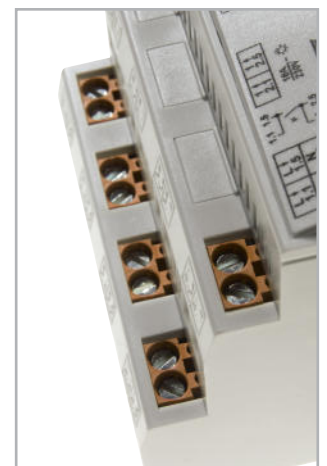
Bild 8: Nur bei exakter Lage der Elektronik-Einheit im Gehäuse lässt sich diese bis zum Anschlag einschieben, so dass die Schraubklemmen sauber in den zugeordneten Öffnungen sitzen.
