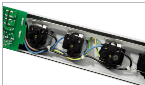
Bild 29: Vor dem Zusammenbau des Gehäuses werden die einzelnen Adern, wie hier gezeigt, mit Kabelbindern fixiert.
