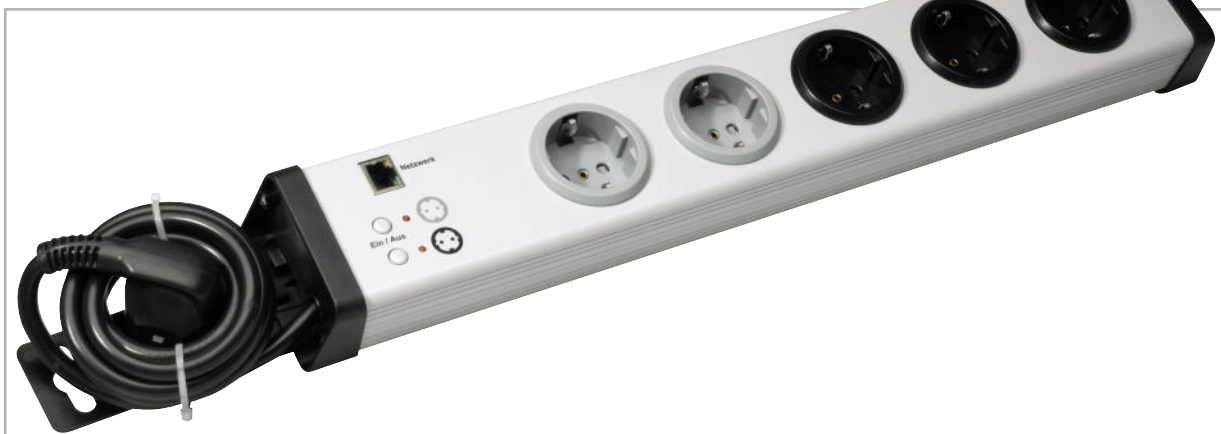
Bild 33: Die fertig montierte IP-Steckdosenleiste
