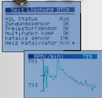
Klartext-Ausgabe und grafische Darstellung von Verläufen für eine schnelle Fehlerdiagnose
