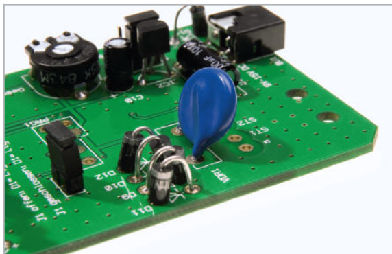
Bild 3: So erfolgt die stehende Bestückung der Dioden.
