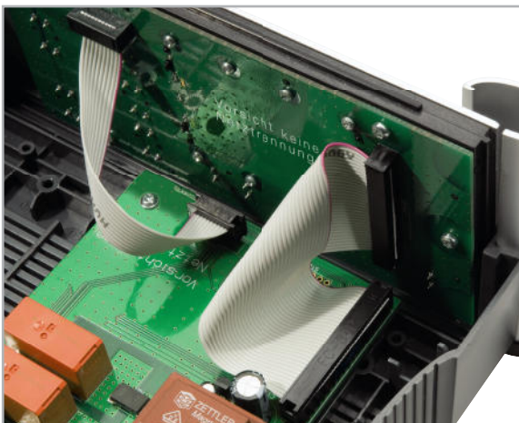
Bild 29: Anschluss der Flachbandleitungen an die Basisplatine
