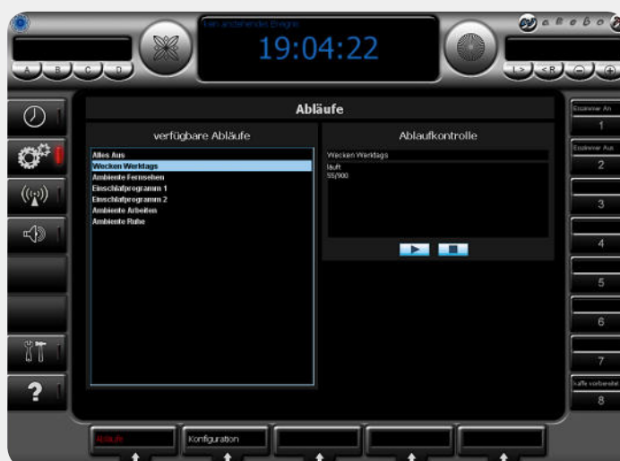
Bild 10: Neben der automatisierten Ablaufsteuerung kann man auch manuell Abläufe starten, stoppen und deren Status kontrollieren.
