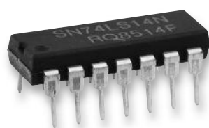
Urform des DIL-Chips: 14-poliges DIL-Gehäuse im 2,54-mm-Raster
