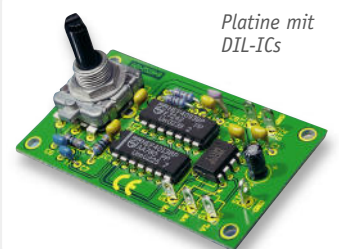
Alles im Raster – der FS20 SM8 ist konsequent im 2,54-mm-Raster ausgeführt, auch die Stiftleisten zueinander.
