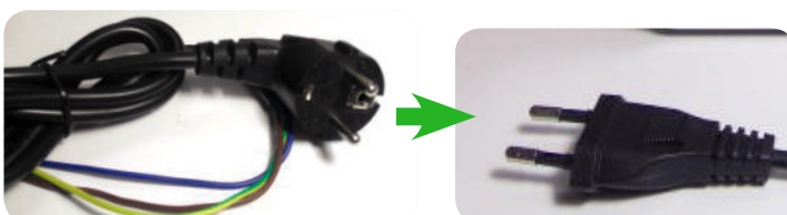
Das Schutzkontakt-Netz Kabel wurde gegen ein Euro-Netz Kabel getauscht und passt nun auch sauber in die Kabeldurchführung.
