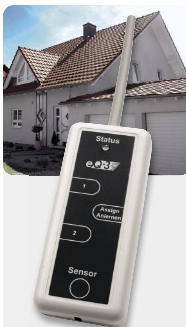
Bild 2: Gab den Ausschlag für HomeMatic: der Funk-Lichtthupensensor
