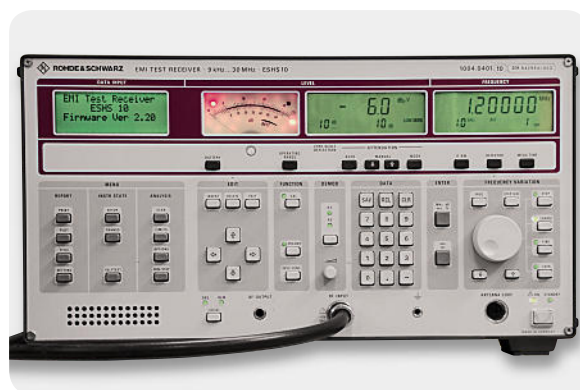
Bild 1: Hochempfindlich und präzise: Messempfänger bis 30 MHz ESHS10 von Rohde & Schwarz
