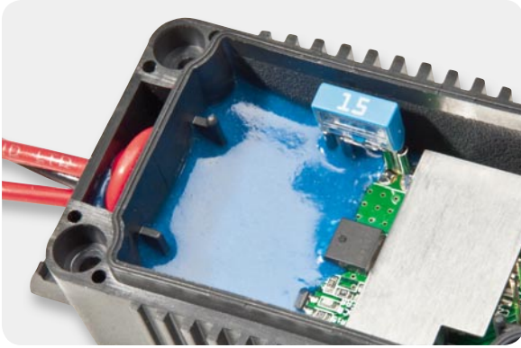
Bild 20: Vergussmasse im Bereich der Kabeleinführung
