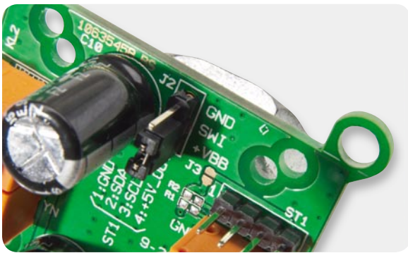
Bild 13: In der Platine sind Montagelöcher für die unterschiedlichen Motorgrößen vorhanden.
