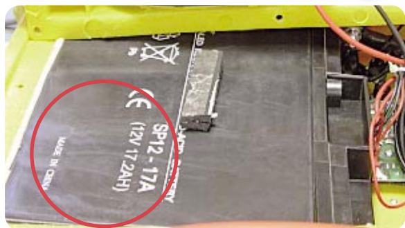
Bild 1: Hält nicht, was er verspricht – der interne Akku des Gerätes
