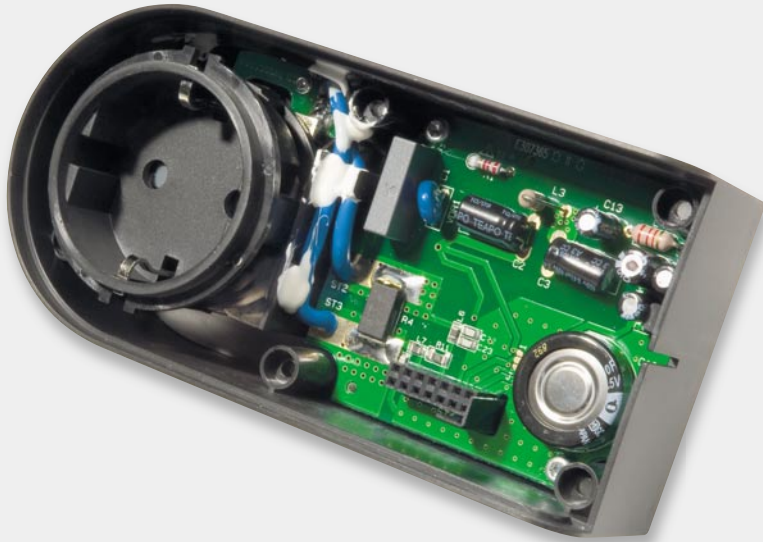
Bild 21: Innenansicht des fertig aufgebauten Gehäuseunterteils
