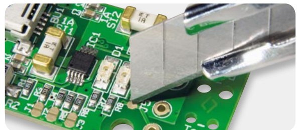
Bild 6: J 5 ist bei angeschlossenem Temperatursensor aufzutrennen.
