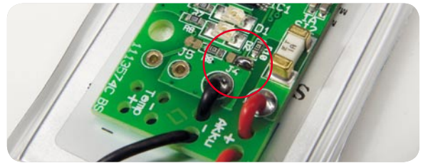
Bild 4: Codierbrücke J 4 zur Einstellung des maximalen Ladestroms in der 500-mA-Konfiguration
