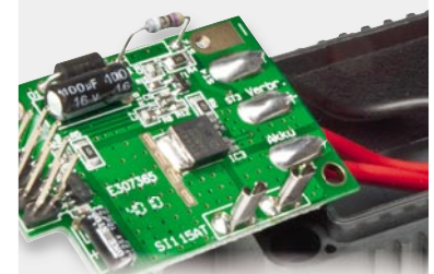
Bild 16: Verlöten der Anschlussleitungen
