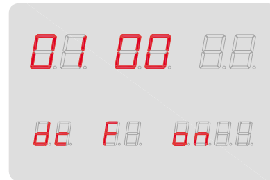
Bild 1: Das DCF-Menü, hier in der Betriebsart „DCF on“
