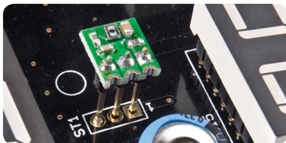
Bild 6: Der Lichtsensor wird mit den Stiftleisten so montiert, dass er eine Aufbauhöhe von 13 mm aufweist.
