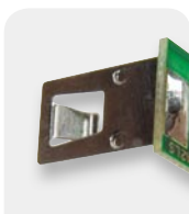
Bild 38: Anlöten des Batterie-Minuskontaktes
