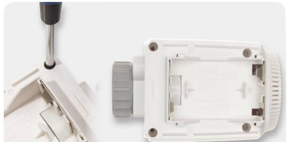
Bild 35: Verschrauben der beiden Gehäusehälften
