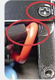
Bild 5: Unsichere Erdungsverbindung und Gefahr für die Isolierung der Netzleitung an der scharfen Kante
