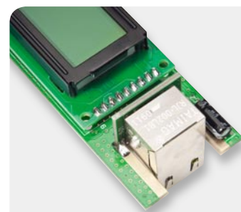
Bild 16: Montage und Verlöten der Netzwerkbuchse (Oberseite)
