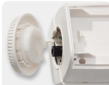
Bild 34: Montage der beiden Gehäusehälften
