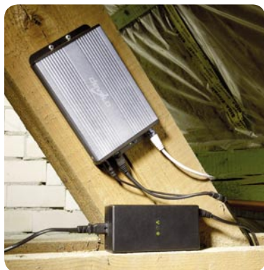
Bild 3: Typischerweise findet der Network Attached Tuner (ins IP-Netz eingebundener Sat-Tuner) seinen Platz in der Nähe des Multischalters. Quelle: devolo
