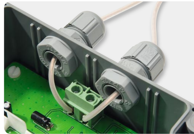
Bild 10: Einführen der Sensorleitungen in das Gehäuse
