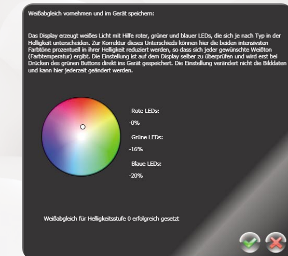
Bild 4: Über den Menüpunkt „Konfiguration“ kann der Weißpunkt des angeschlossenen Gerätes nach Geschmack präzise angepasst werden.
