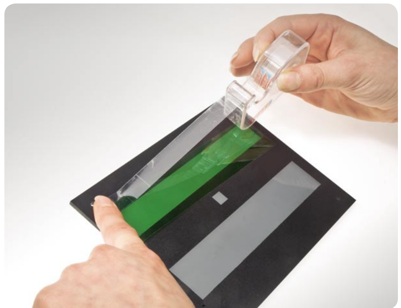
Bild 10: Die Farbfolien werden mit Klebefilm auf der Rückseite der Frontplatte fixiert.
