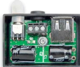
Innenansicht des Fahrrad-Lademoduls
