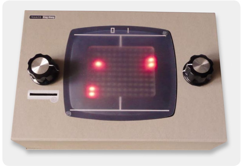
Bild 6: Das mit dem AVR-Board aufgebaute Franzis-Ping-Pong. Eine Diffussorscheibe sorgt für eine flächigere Darstellung der einzelnen Leuchtpunkte.
