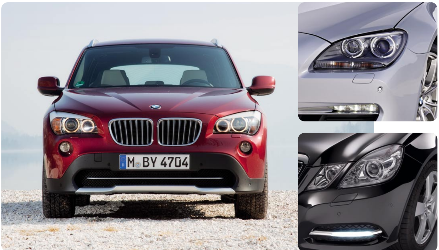
Bild 5: Beispiele für perfekt ins Fahrzeugdesign einbezogene Tagfahrleuchten, auch die seit Langem eingeführten typischen Leuchtringe bei BMW kommen nun als Tagfahrlicht daher. Quellen: BMW, Mercedes-Benz
