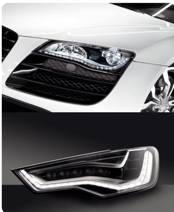
Bild 6: Designers Traum: oben eine Studie eines voll mit LED bestückten Scheinwerfers von Philips, unten, ebenfalls für Audi, von Hella
