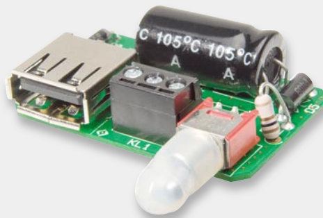
Bild 11: Spritzwasserschutz des Schalters mit Silikonhaube
