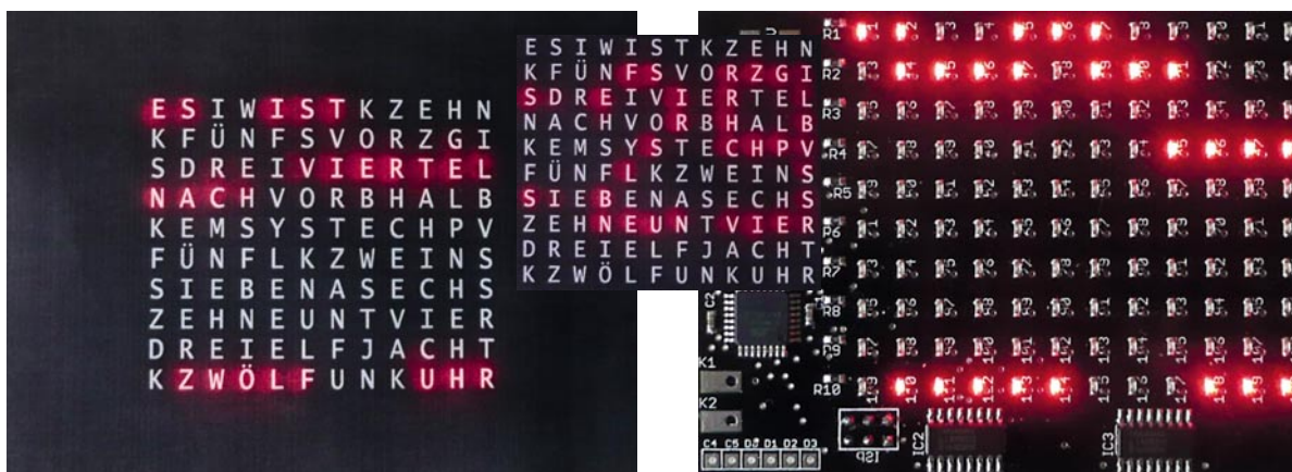
Bild 12: Wordclock in Aktion, links die laufende Zeitanzeige, in der mitte die Anzeige beim Stellen. Bereits am einfachen Laboraufbau mit einer auf dem Laserdrucker gedruckten Papierfolie kann man die Anzeige gut erkennen. Mit einem Abstandshalter, der das Überstrahlen der einzelnen LEDs verhindert, sowie einer Acrylplatte erhält man ein optisch sehr attraktives Ergebnis, wie in [4] zu sehen. Das erst die Frontplatte ein ablesen möglich macht, zeigt das Bild rechts (11:25 Uhr).
