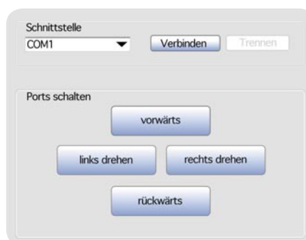
Bild 4: Der Lehrgang zeigt auch, wie man mit Visual Basic eine direkte Steuerung des Franzis-Bots vom PC aus realisieren kann. Hier eine modifizierte Version der Lehrgangsoftware.
