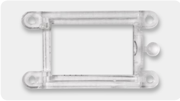
Bild 4: Das kopfüber in die Displayabdeckung eingelegte Display. Rechts ist deutlich die Anguss-Nase zu sehen, die die richtige Lage markiert.
