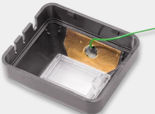
Bild 16: Einkleben der Sensorfläche im Gehäuseoberteil
