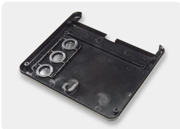
Bild 9: Die Tastenabdeckungen, in die Gehäuserückwand eingelegt
