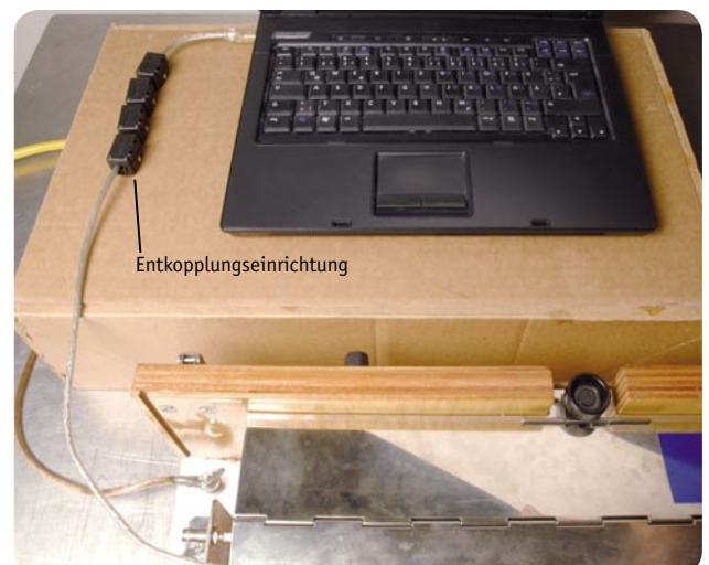
Bild 8: Ungenügende Entkopplungseinrichtung – die Folge war ein Ausfall der Verbindung zum Prüfling.
