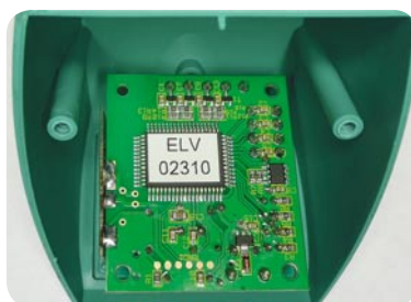
Bild 6: Der Funkschalter fand seinen Platz an der Stelle, an der ehemals die Original-Steuerplatine saß.
