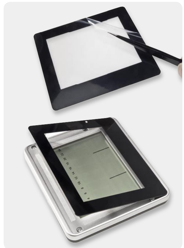
Bild 16: Nach einem Funktionstest des Gerätes sind die Schutzfolien von der Frontplatte (oben) und von den Klebestreifen zu entfernen, und die Frontplatte ist wie unten gezeigt einzukleben.
