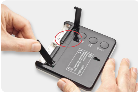
Bild 8: Das Einsetzen der Standfüße in die dafür vorgesehenen Aussparungen und der abgeklebte Programmieradapter
