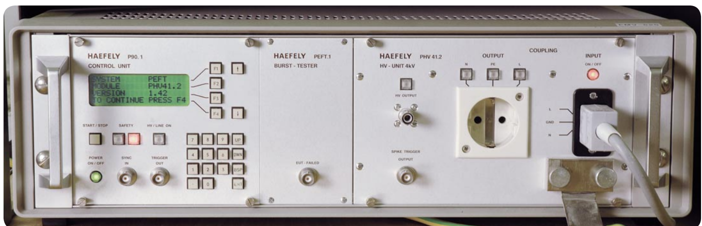
Bild 4: Ein Burstgenerator kann sowohl die Einzelimpulse als auch Burstpakete für die Prüfung nach EN 61000-4-4 erzeugen.
