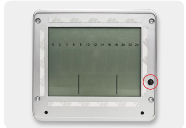
Bild 10: Beim Aufkleben des doppelseitigen Klebebandes ist darauf zu achten, dass die Öffnung für die IR-Diode nicht abgedeckt wird.
