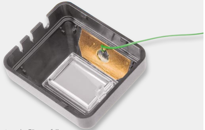
Bild 18: Einsetzen der Tönungsfolie
