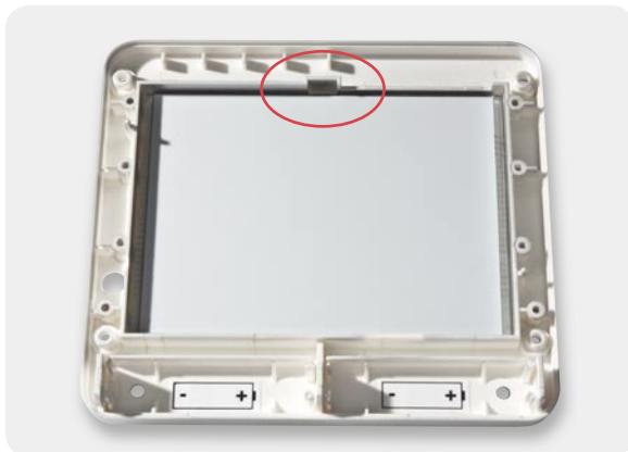
Bild 11: Das Display ist so einzulegen, dass der Display-Anguss genau in der dafür vorgesehenen Gehäusenut liegt. Achtung: Display-Schutzfolie entfernen!
