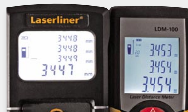
Bild 12: LDM-100 kann nur zwei Messergebnisse im Display-stack speichern.
