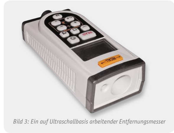
Bild 4: Aus der Öffnung neben dem großen Schalltrichter wird eine kreisförmige Laserlichtmarkierung gestrahlt, die auf der Reflexionsfläche des Schalls vollständig sichtbar sein muss.
