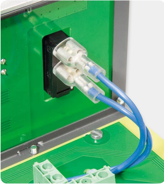
Bild 19: Der Anschluss des Hauptschalters
