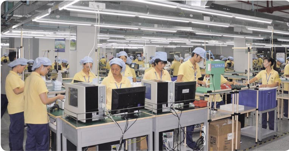
Bild 10: Montagezellen nach dem One-Piece-Flow-Prinzip
