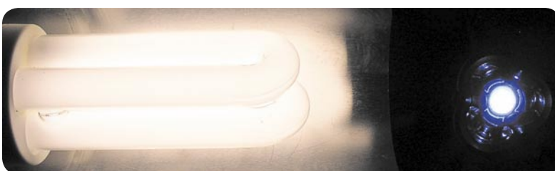
Bild 11: Obwohl die Leuchtdiode nur ein Prozent der Lichtstärke einer Glühlampe hat, erscheint sie uns heller als eine Energiesparlampe.
