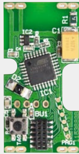
Fertig aufgebaute Prozessorplatine, links von der Seite des Funkmoduls, rechts von der Prozessorseite, jeweils mit zugehörigem Bestückungsplan
