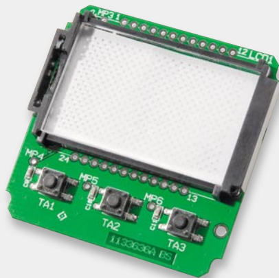
Bild 17: Einsetzen der Lichtverteilerplatte
