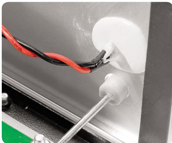
Bild 26: Die Kontroll-LED wird direkt in das Frontprofil geklebt.
