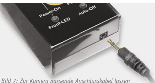
Bild 7: Zur Kamera passende Anschlusskabel lassen sich dank der Klinkenbuchse sekundenschnell wechseln.
