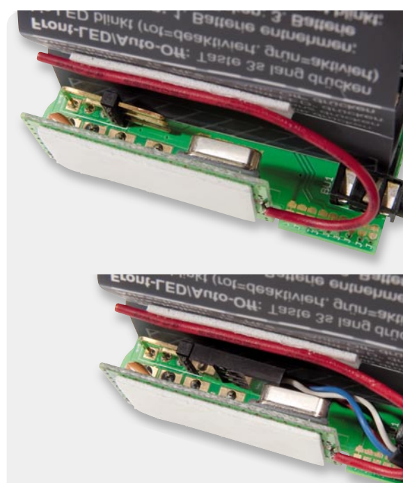
Bild 13: Die im Bild gezeigte Stiftleiste ST 1 wird im Normalfall nicht bestückt. ST 1 kann statt BU 1 optional bestückt werden, wenn eines der Kabel mit den Bestell-Nrn. JL-085052, JL-085053, JL-085342, JL-092085 verwendet werden soll. Deren 3-polige Buchse lässt sich wie im Bild unten auf ST 1 aufstecken.
