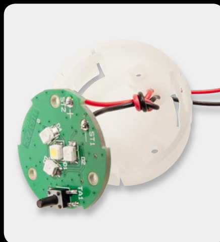
Bild 6: Die Montager Reihenfolge: Leitungen unten durch die Gehäuseöffnung führen – gegen unerwünschtes Herausziehen mit einem Knoten sichern – abisolierte Enden von unten durch die Platinenbohrung führen und auf der Platinenoberseite verlöten – Platine einsetzen – Deckel („Flamme“) so aufsetzen, dass der Tasterstößel genau in der dafür vorgesehenen Öffnung sitzt – Gehäuse verschrauben.
