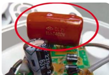
Bild 5: Gefährlicher Kondensator – an diese Stelle gehört ein X2-Typ!
