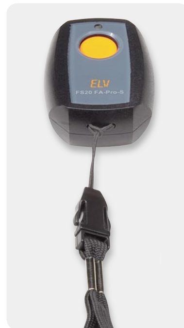
Bild 21: Durch die beiden seitlichen Bohrungen am Handsender kann bei Bedarf z. B. eine Handschlaufe oder ein Schlüsselband gezogen werden.
