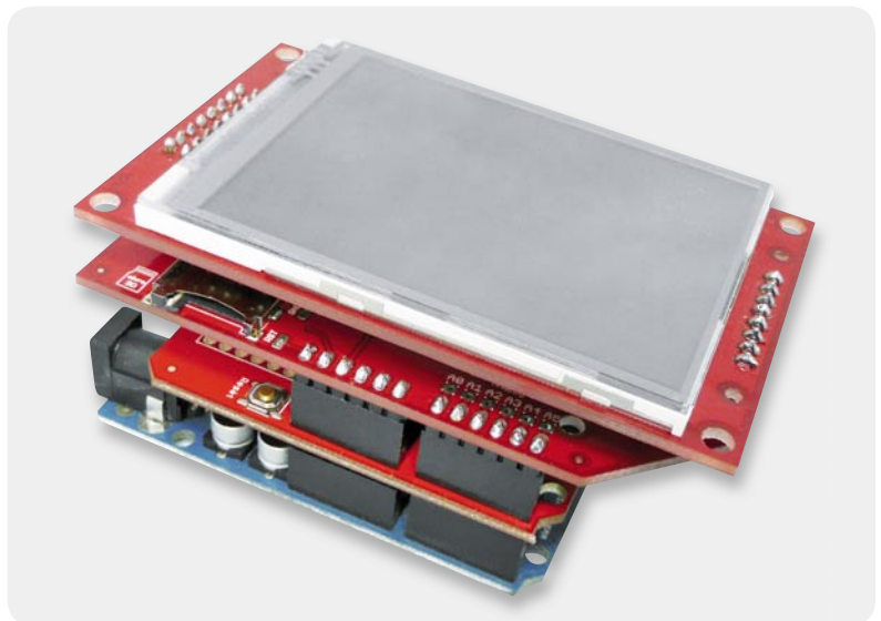
Bild 12: Auch hieraus entsteht gerade ein komfortabler Si4735-Weltempfänger: Arduino-Board, Si4735-Shield und Touchscreen-Shield mit zugehörigem mSD-Shield. Alles bei [13] erhältlich!
