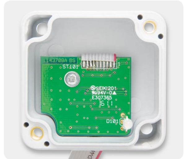
Bild 9: Die im Gehäuse verschraubte Platine
