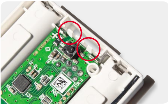
Bild 11: Die Platinenhalterungen müssen einrasten, so dass die Platine fest sitzt.
