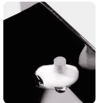
Bild 26: Einkleben eines Lichtleiters für die Duo-LED im Gehäuseoberteil
