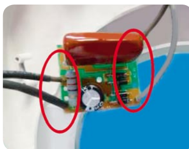
Bild 2: Nicht fixierte Leitungsenden auf der Netzteilplatine
