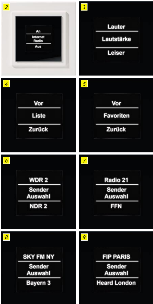
Bilder 2 bis 9: Display-Anzeigebeispiel bei der Verwendung des FS20-Display-Wandtasters in Verbindung mit dem FS20-Internetradio
