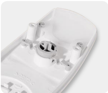
Bild 19: Das Einsetzen der Tastkappe und des Lichtfensters
