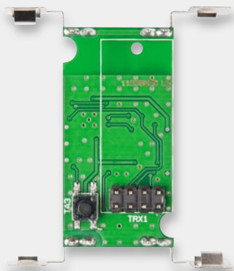
Bild 6: Die Platine mit bestückter Stiftleiste
