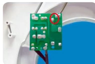
Bild 6: Kurzschlussgefahr – zu geringe Abstände auf der Platine zwischen den Potentialen
