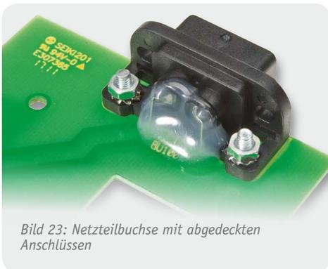
Bild 23: Netzteilbuchse mit abgedeckten Anschlüssen
