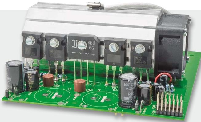
Bild 16: Transistoren und Gleichrichter am Kühlkörper links
