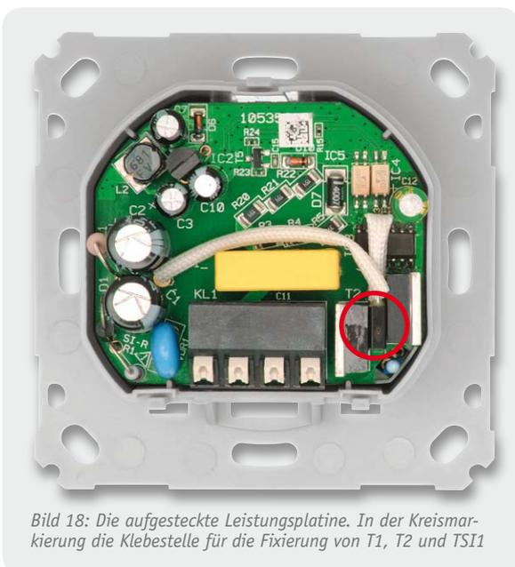
Bild 18: Die aufgesteckte Leistungsplatine. In der Kreismarkierung die Klebestelle für die Fixierung von T1, T2 und TS11
