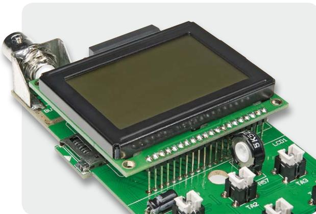
Bild 18: Fertig eingebautes Displaymodul
