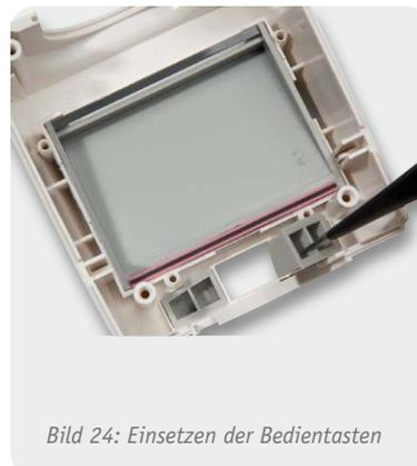
Bild 24: Einsetzen der Bedientasten
