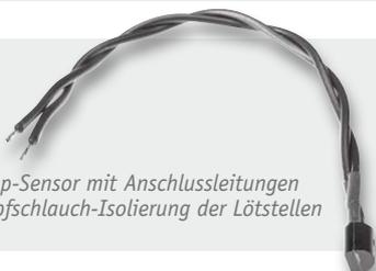
Bild 19: Temp-Sensor mit Anschlussleitungen und Schrumpfschlauch-Isolierung der Lötstellen
