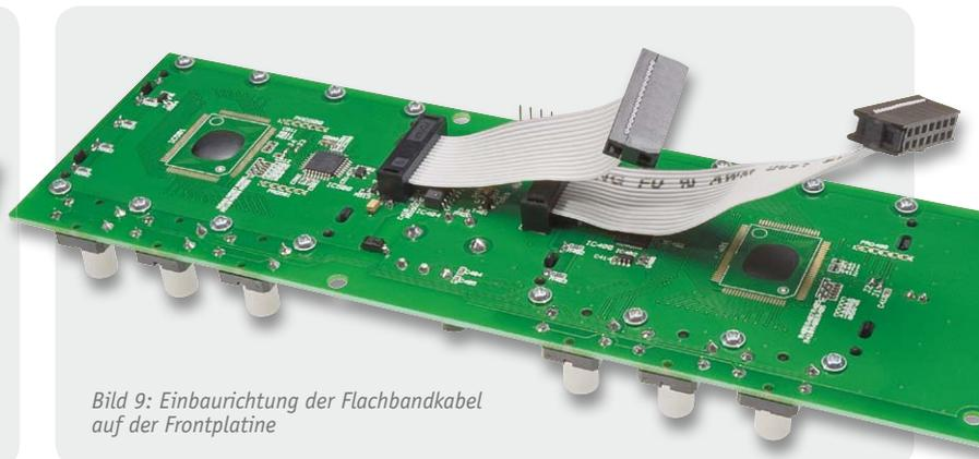
Bild 9: Einbaurichtung der Flachbandkabel auf der Frontplatine
