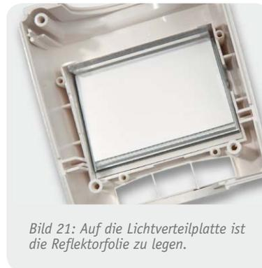
Bild 21: Auf die Lichtverteilplatte ist die Reflektorfolie zu legen.
