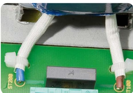
Bild 25: Festsetzen der Primär-Trafoleitungen auf der Netzplatine
