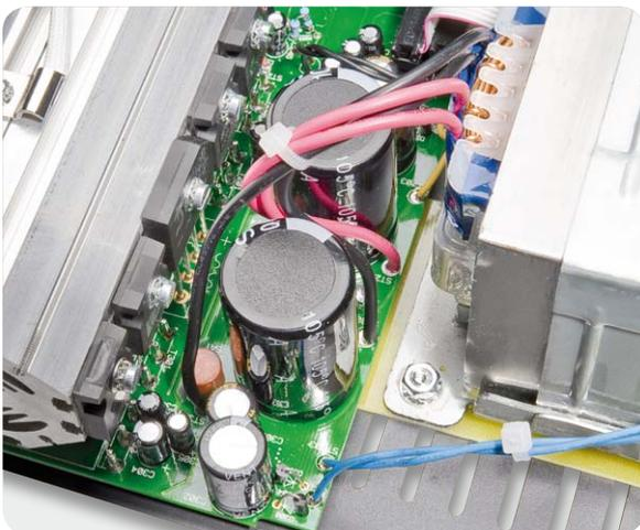
Bild 31: Die Sekundärleitungen des Trafos mit Kabelbindern
