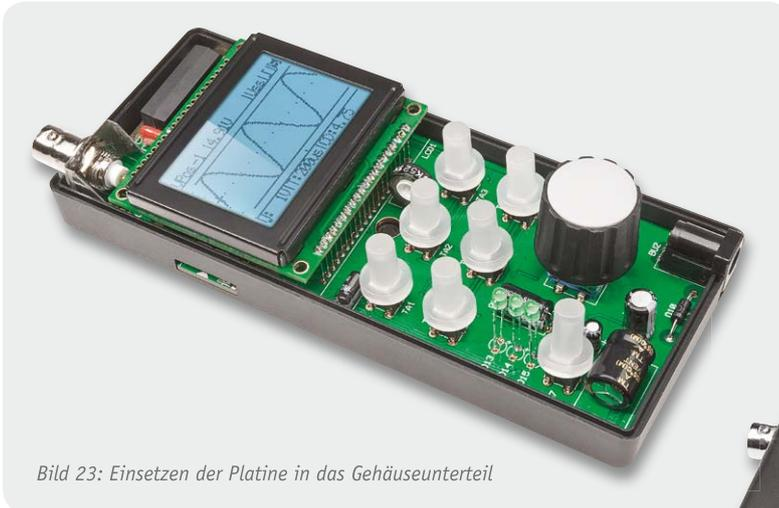
Bild 23: Einsetzen der Platine in das Gehäuseunterteil
