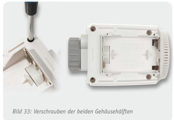
Bild 33: Verschrauben der beiden Gehäusehälften
