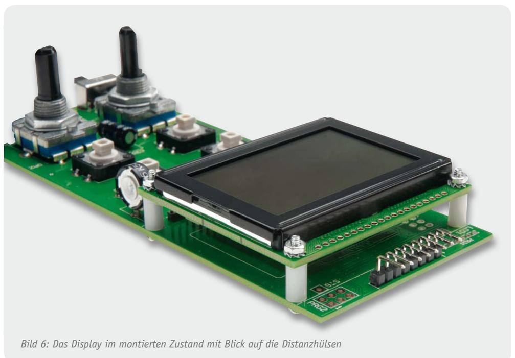
Bild 6: Das Display im montierten Zustand mit Blick auf die Distanzhülsen
