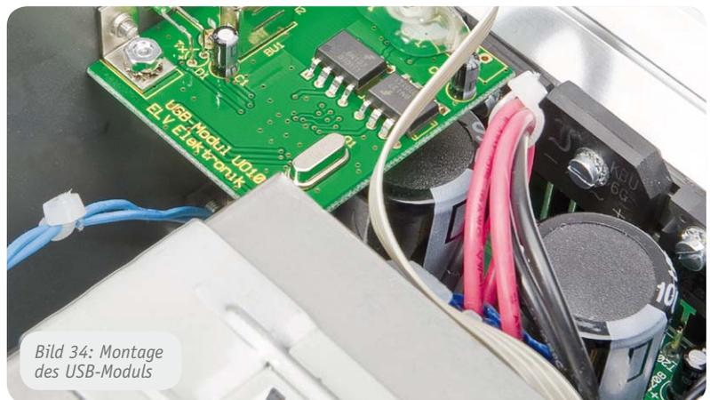
Bild 34: Montage des USB-Moduls
