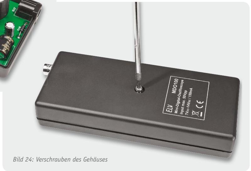
Bild 24: Verschrauben des Gehäuses
