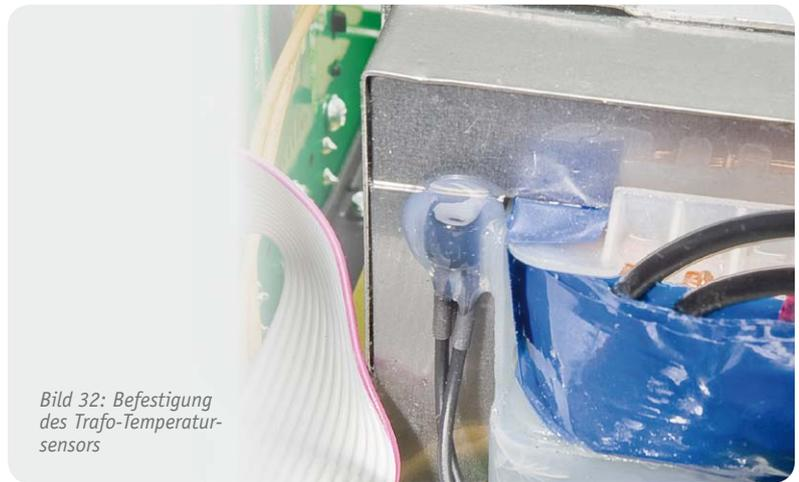
Bild 32: Befestigung des Trafo-Temperatur-sensors
