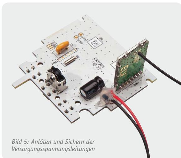
Bild 5: Anlöten und Sichern der Versorgungsspannungsleitungen
