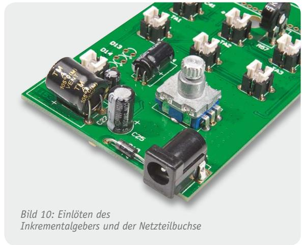
Bild 10: Einlöten des Inkrementalgebers und der Netzteilbuchse
