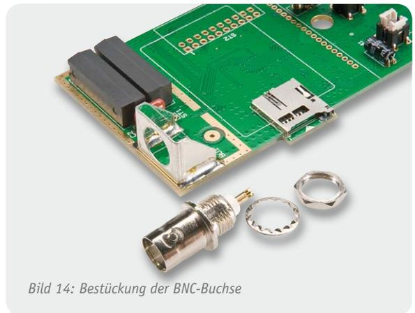
Bild 14: Bestückung der BNC-Buchse
