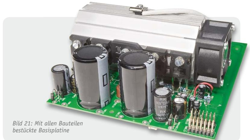
Bild 21: Mit allen Bauteilen bestückte Basisplatine
