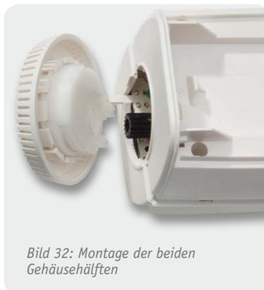
Bild 32: Montage der beiden Gehäusehälften
