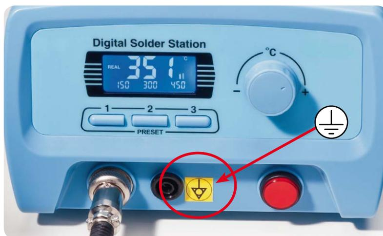
Bild 1: Die falsche Kennzeichnung des Potentialausgleichs
