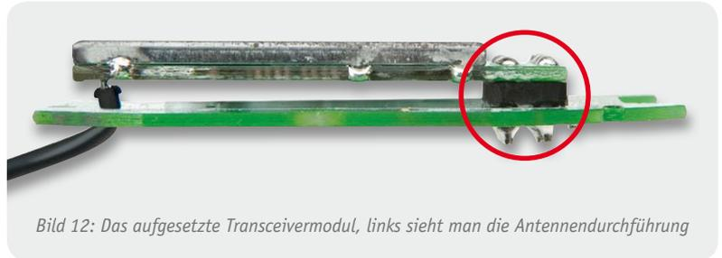
Bild 12: Das aufgesetzte Transceivermodul, links sieht man die Antennendurchführung
