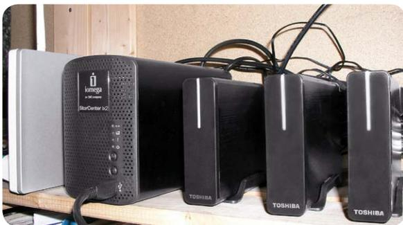
Bild 9: Das Iomega StorCenter ix2 stellt mit seinen beiden internen Festplatten 1 TByte gespiegelte und über seine drei USB-Ports, an denen je eine 2-TByte-Festplatte angeschlossen ist, 6 TByte ungespiegelte Kapazität zur Verfügung. Das sollte für Daten-Backups und die Multimedia-Bibliothek fürs Erste ausreichen. Links ist das DSL-Modem/Router mit WLAN-Access-Point und 100-Mbit/s-4-Port-IP-Switch (Speedport W700V) zu sehen.
