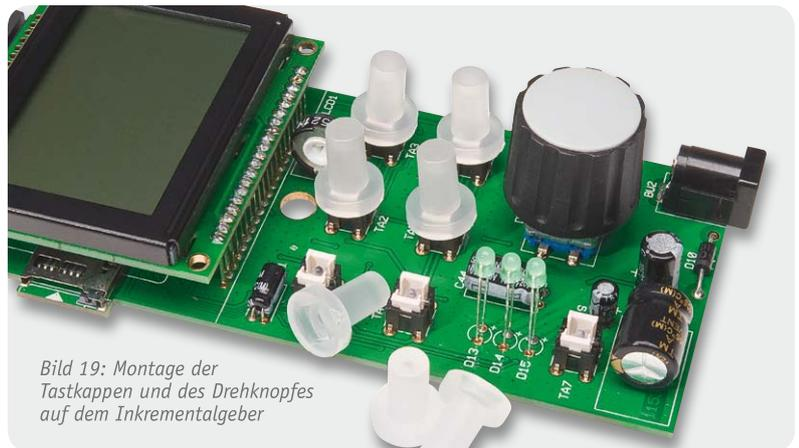
Bild 19: Montage der Tastkappen und des Drehknopfes auf dem Inkrementalgeber
