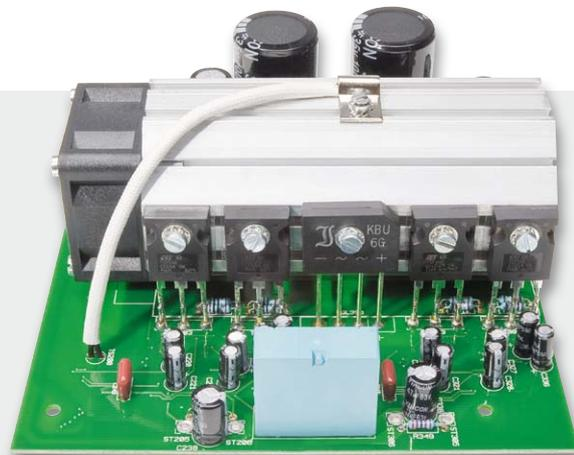
Bild 17: Transistoren und Gleichrichter am Kühlkörper rechts
