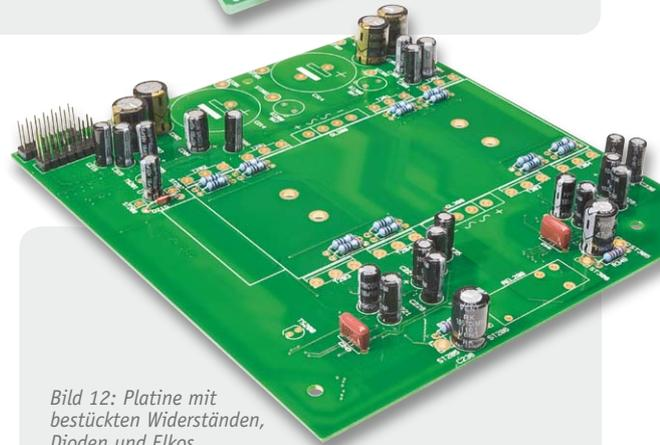
Bild 12: Platine mit bestückten Widerständen, Dioden und Elkos
