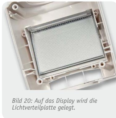
Bild 20: Auf das Display wird die Lichtverteilplatte gelegt.
