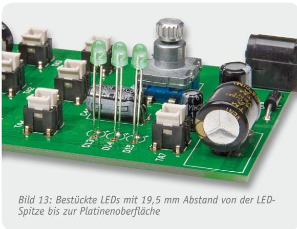
Bild 13: Bestückte LEDs mit 19,5 mm Abstand von der LED-Spitze bis zur Platinenoberfläche
