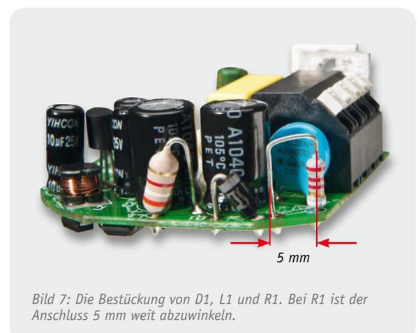
Bild 7: Die Bestückung von D1, L1 und R1. Bei R1 ist der Anschluss 5 mm weit abzuwinkeln.
