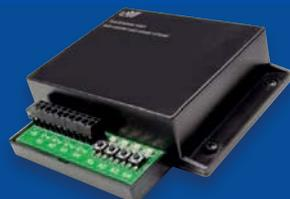
Stellt 4 Schaltkanäle mit Relaisausgang zur Verfügung. Ein weiterer Spannungsbereich von 7 V bis 15 V erlaubt vielfältige Anwendungen im Niederspannungsbereich. Durch das angewendete bidirektionale BidCoS®-Protokoll mit Empfangsbestätigung ist der Betrieb des Empfängers besonders funktionssicher.
