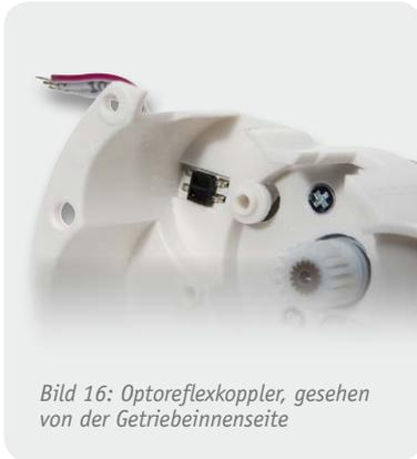
Bild 16: Optoreflexkoppler, gesehen von der Getriebeinnenseite
