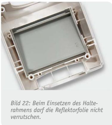
Bild 22: Beim Einsetzen des Halterahmens darf die Reflektorfolie nicht verrutschen.
