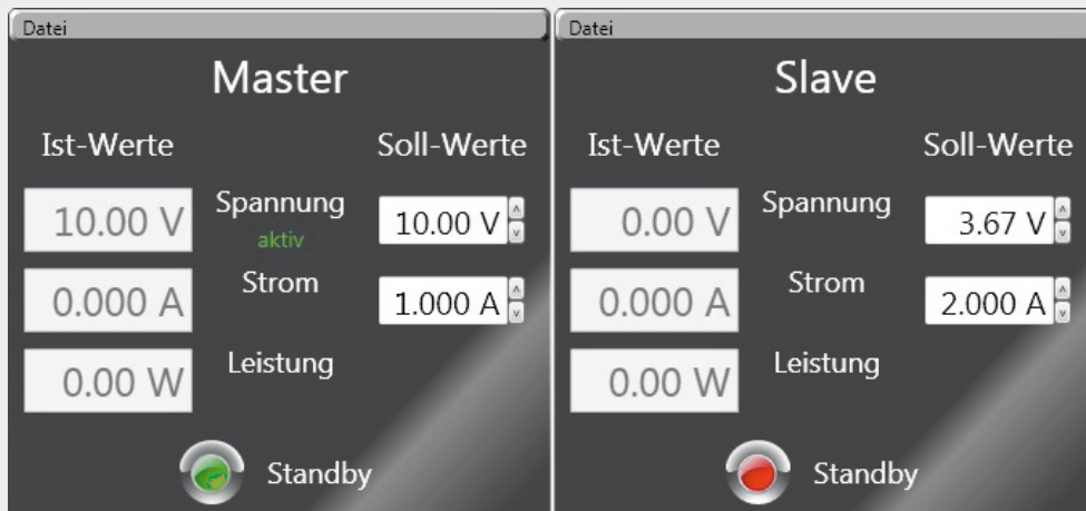
Bild 41: Kanalfenster des DPS 5315 im Master-Slave-Betrieb
