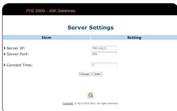
Bild 7: Im Menü „Server Settings“ erfolgen Verbindungseinstellungen zur Kommunikation mit dem Computer, auf dem die PC-Software ausgeführt wird.
