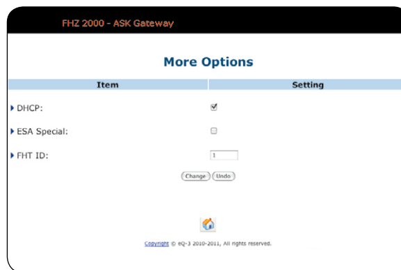
Bild 8: Unter „More Options“ erfolgen die DHCP-Aktivierung sowie Einstellungen zum ESA- und FHT-System.
