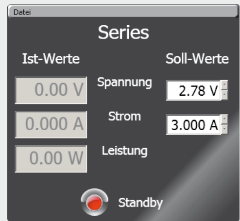
Bild 43: Betrieb des DPS 5315 im Series-Betrieb
