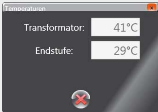
Bild 40: Anzeige der Trafo- und Endstufen-Temperatur des DPS 5315
