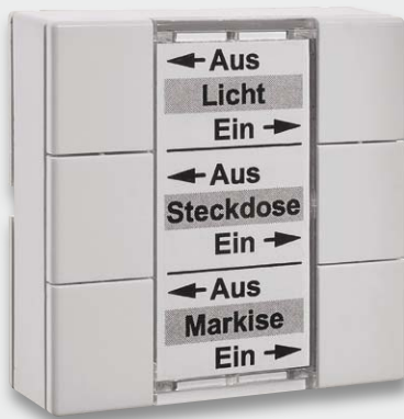
Bild 23: Fertig aufgebaute Sendeeinheit FS20 S6A
