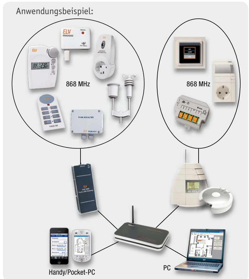
Bild 4: Unter der neuen homeputer-Softwareoberfläche sind alle von der FHZ 2000 verarbeitbaren Protokolle und das HomeMatic-System zusammengeführt.
