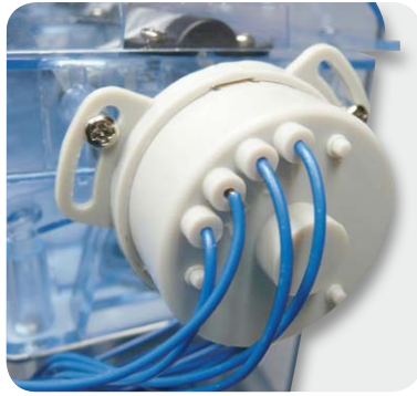
Bild 5: Auch ein real arbeitender Zündverteiler mit Zündzeitpunktverstellung ist vorhanden.
