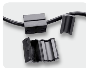
Bild 13: Auf das Koaxialkabel aufgeschobene Ferrithülsen dämpfen hochfrequente Mantelströme. Ist das Aufschieben nachträglich nicht mehr möglich, kann man klappbare Hülsen einsetzen.
