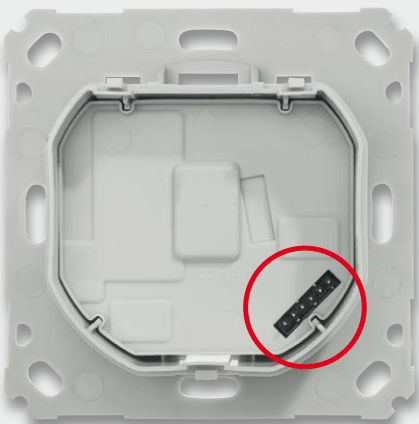
Bild 15: Die Isolierplatte zwischen Controller- und Leistungsplatine ist eingelegt. Rechts unten ist die Steckerleiste für die Verbindung beider Platinen zu sehen.
