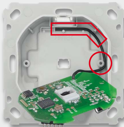
Bild 13: Die Antenne des Transceivers ist genau wie hier gezeigt einzulegen.
