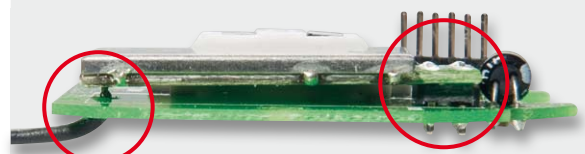
Bild 10: Das aufgesetzte Transceivermodul, links sieht man die Antennendurchführung.
