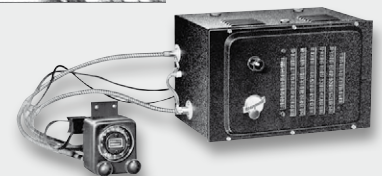
Bild 1: Das erste europäische Autoradio, der AS5 von Blaupunkt, wurde 1932 vorgestellt. Er hatte eine Lenkradfernbedienung. Quelle: Blaupunkt
