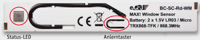
Bild 8: Anlerntaster, Status-LED und Antennenführung
