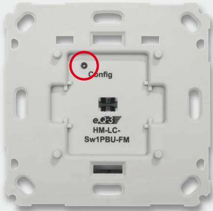
Bild 18: Der Tasterstößel ist auf Leichtgängigkeit zu prüfen.
