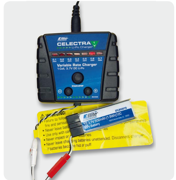
Bild 8: Einfach zu bedienen und an die Aufgabe anpassbar – der mitgelieferte LiPo-Lader
