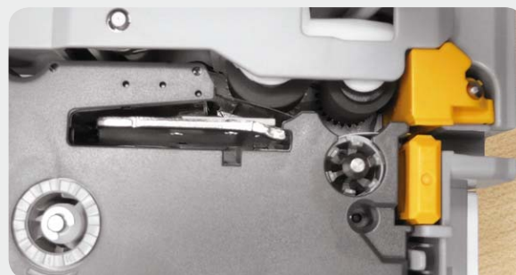
Bild 4: Die Anordnung des Druckkopfs für den Hinterband-Druck
