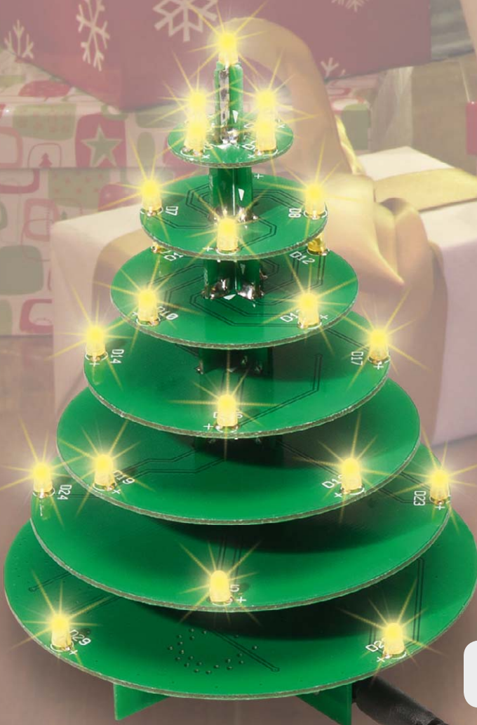
Bild 15: Der fertig aufgebaute LED-Weihnachtsbaum mit Steckernetzteil
