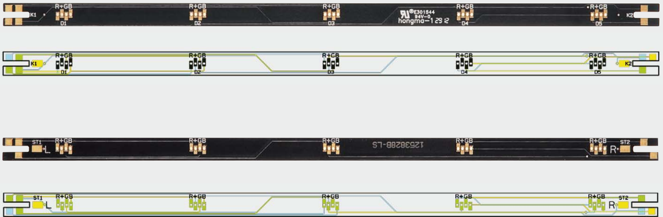
Bild 8: LED-Trägerplatine mit dazugehörigem Bestückungsdruck. Oben die Bestückungsseite, unten die Lötseite
