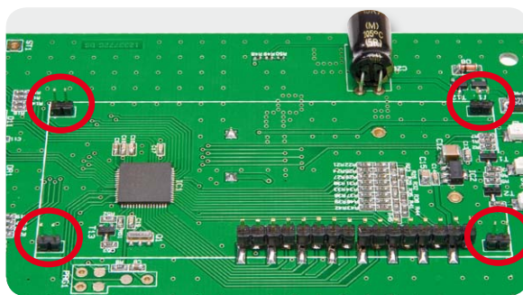
Bild 8: Die 4 zweipoligen Stiftleisten für die Montage des Displays
