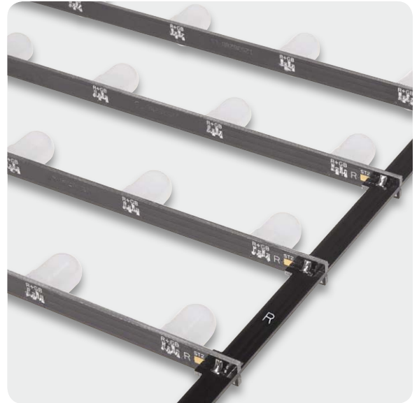
Bild 15: Detailansicht eines zusammengelöteten LED-Trägerelements mit den Markierungen auf den Platinen
