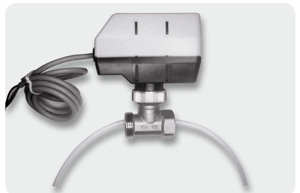
Bild 3: Zum Quetschventil umgebautes Thermostatventil mit elektromotorischer Betätigung
