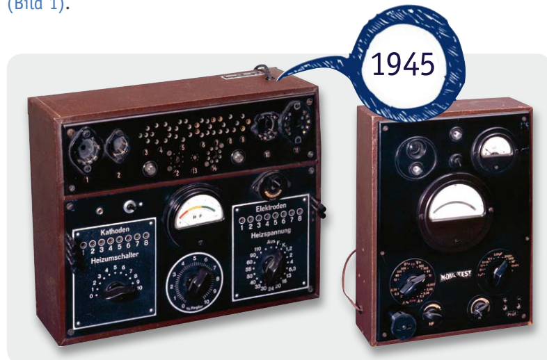
Bild 1: Damit fing es nach dem zweiten Weltkrieg an: links das Röhrenprüfgerät Tubatest, rechts das Multimeter Novatest
