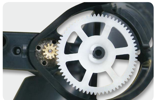
Bild 4: Hohe Untersetzung bringt ein großes Drehmoment an den Tragschrauben.
