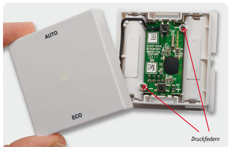
Bild 7: Schließen des Eco-Taster-Gehäuses
