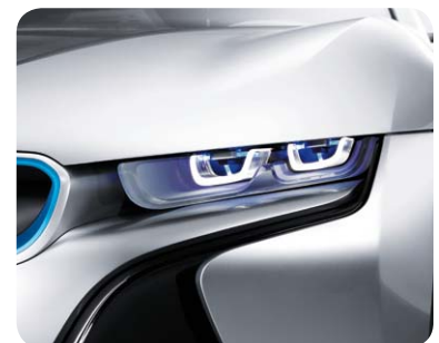
Bild 7: Bereits in der Entwicklung – Fahrbahnbeleuchtung durch Laserdioden
