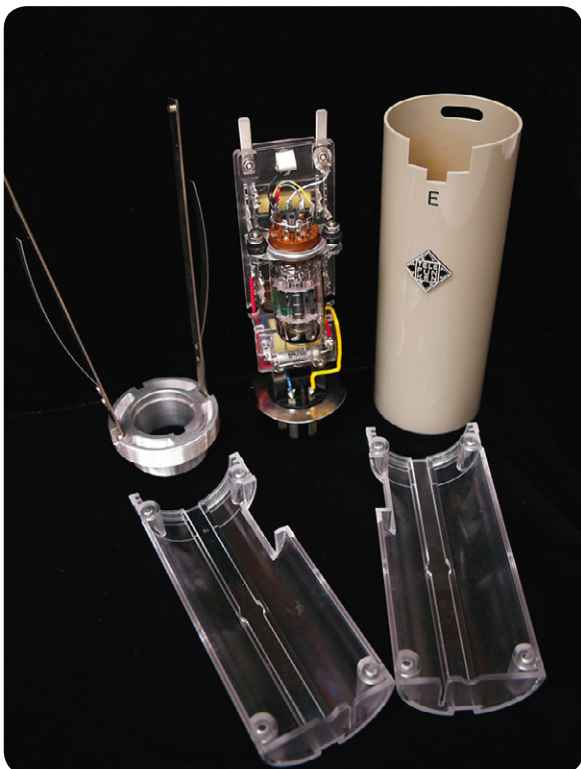
Bild 10: Telefunken-Retro-Technik vom Feinsten: Neuauflage des legendären Studiomikrofons ELA M251 bei Telefunken Akustik. Quelle: Telefunken Akustik
