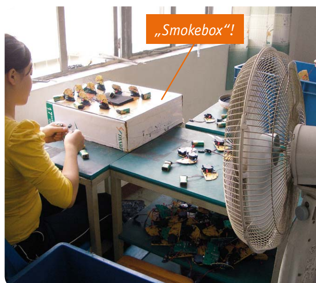
Bild 9: Test von Rauchmelder-Platinen in einer chinesischen Fabrik für Billigprodukte
