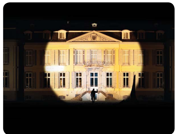
Bild 1: Lichtverteilung bei der Linse: kreisrund und homogen, rechts ein Beispiel (Schloss Morsbroich)
