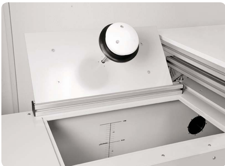
Bild 7: Montage des Prüflings am Drehteller
