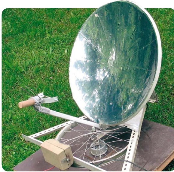
Bild 8: Vorbild für die kommerzielle Anwendung: Ein als Sonnenlicht-Reflektor präparierter Parabolspiegel konzentriert das Sonnenlicht so, dass es direkt auf den Stirlingmotor gelenkt wird.
