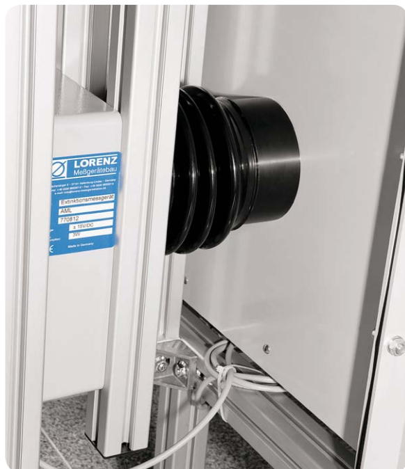
Bild 6: Extinktionsmessgerät zur Erfassung der Aerosolkonzentration
