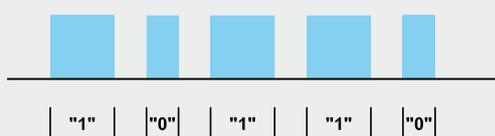
Bild I: Grundprinzip der Pulslängenmodulation
