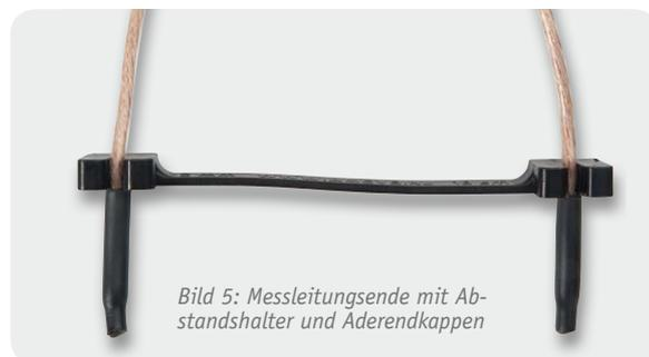
Bild 5: Messleitungsende mit Abstandshalter und Aderendkappen
