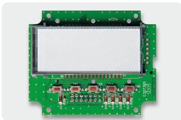
Bild 10: Einsetzen der Lichtverteilterplatte mit dem Punktraster nach unten
