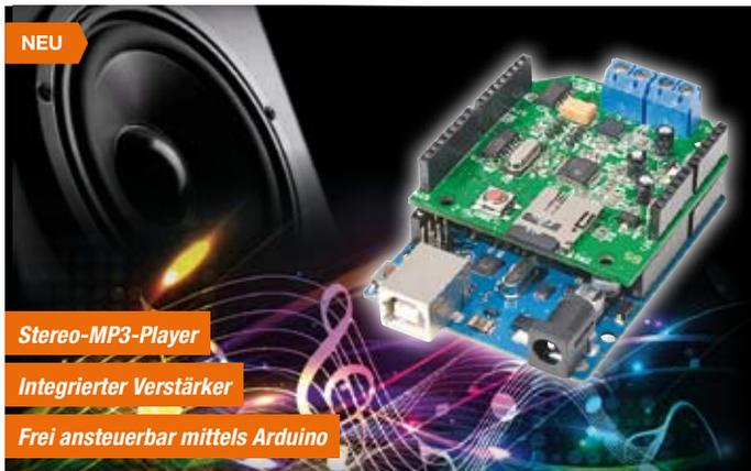
**Mit dem „Audio Shield for Arduino“ kann ein Arduino-Board in einen MP3-Player verwandelt werden.**
