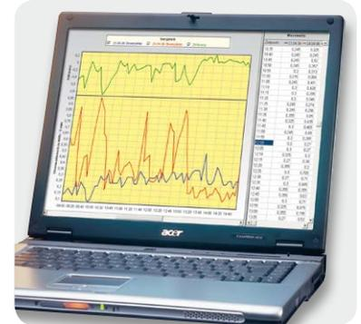
Bild 4: Über ein Datenloggersystem mit PC-Auswertung kann man sehr genaue Verbrauchs- und Langzeitanalysen vornehmen.
