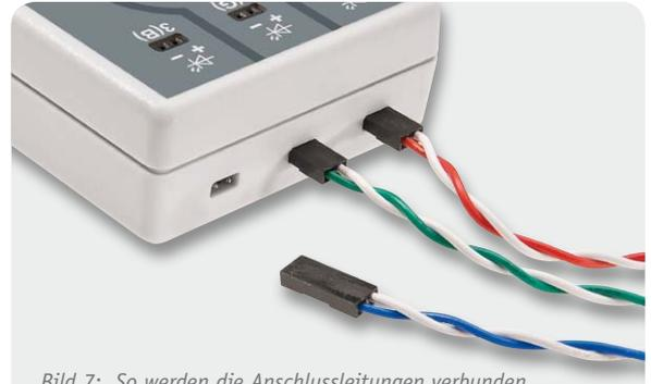
Bild 7: So werden die Anschlussleitungen verbunden.
