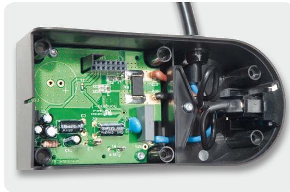
Bild 29: Einsetzen des Netzschalters in die Gehäuseführung
