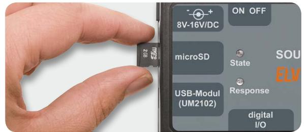
Bild 10: Das Einsetzen der microSD-Karte in den Kartenschacht
