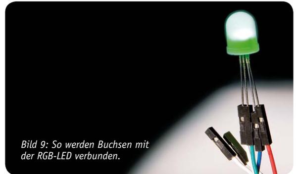
Bild 9: So werden Buchsen mit der RGB-LED verbunden.
