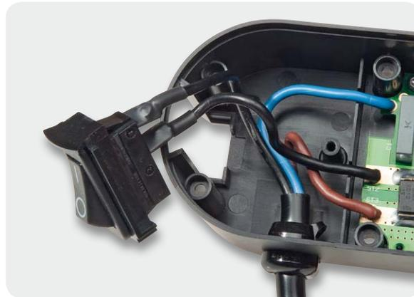
Bild 27: Zugentlastung des Netzkabels mit einer Einpress-Zugentlastung
