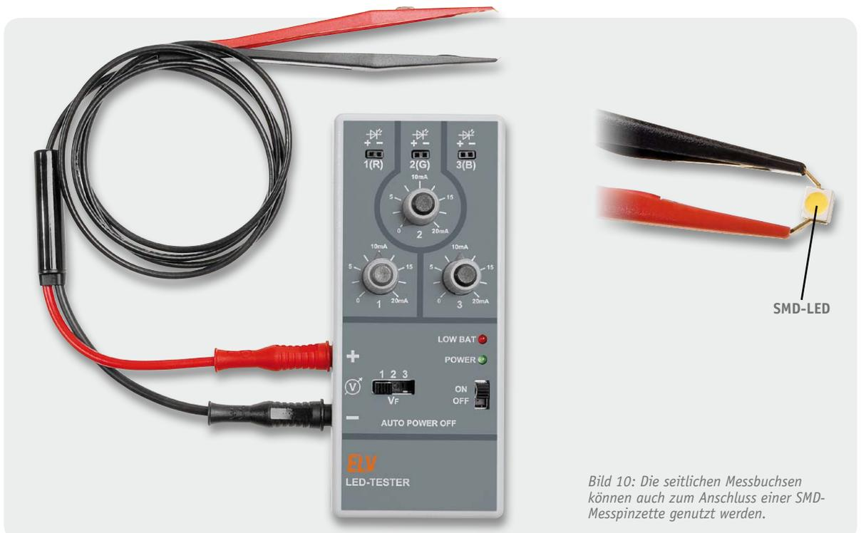
Bild 10: Die seitlichen Messbuchsen können auch zum Anschluss einer SMD-Messpinzette genutzt werden.
