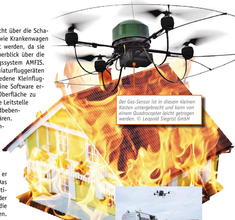
Der Gas-Sensor ist in diesem kleinen Kasten untergebracht und kann von einem Quadrocopter leicht getragen werden. © Leopold Siegrist GmbH
