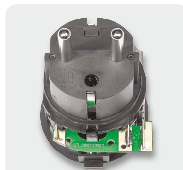
Bild 7: Die auf die Anschlussbleche gesetzte und angelötete Adapterplatine (drei Lötunkte)
