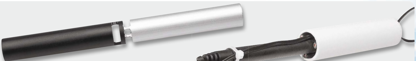
Bild 10: Grundlage für den Sonnensensor ist ein Aluminiumrohr, dessen eine Hälfte geschwärzt und das in der Mitte für geringe Wärmeübertragung mit Schlitzeln versehen wurde.
