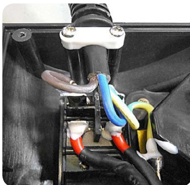
Bild 5: Nun ordentlich fixiert und verlötet: der Netzanschluss
