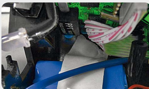
Bild 9: Nur einfach isolierte Leitungen bei der alten Version, rechts sind in der neuen Version alle Leitungen doppelt isoliert.
