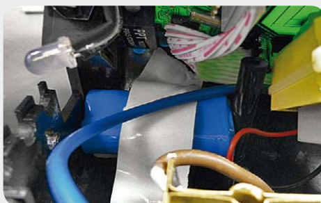
Bild 10: Der sperrige Akku in der Ursprungsversion, der zu Quetschungen der umliegenden Kabel führte, ist in der neuen Version (Bilder rechts) verschwunden und hat einer sicher eingelöteten Platinenversion Platz gemacht.
