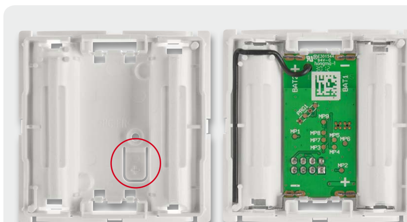
Bild 6: Nach dem Aufkleben der Schaumstoffstreifen (links) kann die Basisplatine eingesetzt und eingerastet werden (rechts). Dabei ist die richtige Lage des Gehäuseunterteils zu beachten, also Tasterstößel unten rechts. Die Antenne des Transceiver-Moduls ist wie hier gezeigt zu verlegen.
