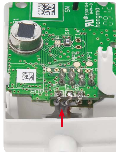
Bild 10: So wird das Verbindungskabel verlötet.
