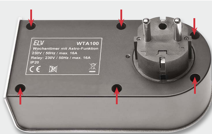
Bild 25: Das Verschrauben des Gehäuses erfolgt mit sechs Schrauben.
