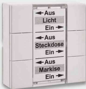
Bild 13: Fertig aufgebaute Sendeeinheit HM-PB-6-WM55
