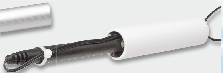
Bild 11: Der mit einem weißen Kunststoffrohr versehene und mit den Temperaturfühler bestückte Sonnensensor
