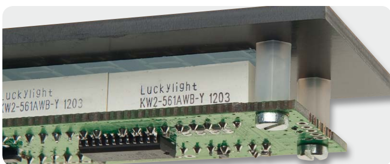
Bild 5: So werden die Abstandshalter montiert.
