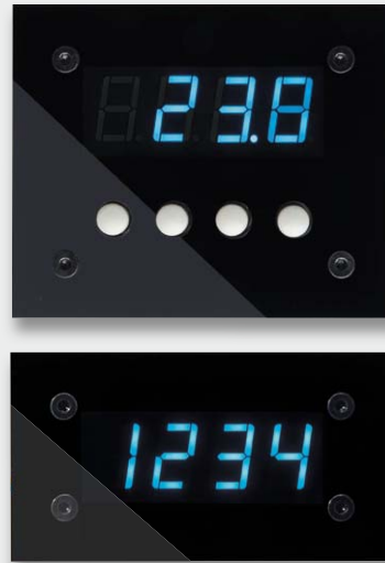
Bild 4: Die beiden zur Verfügung stehenden Frontplattenversionen, oben mit Tastenfeld, unten ohne Tastenfeld
