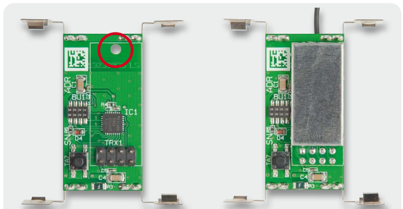
Bild 4: Die Bestückung der Stiftleiste für das Transceiver-Modul sowie des Moduls selbst. Die Antenne ist dabei durch das links markierte Loch zu führen.
