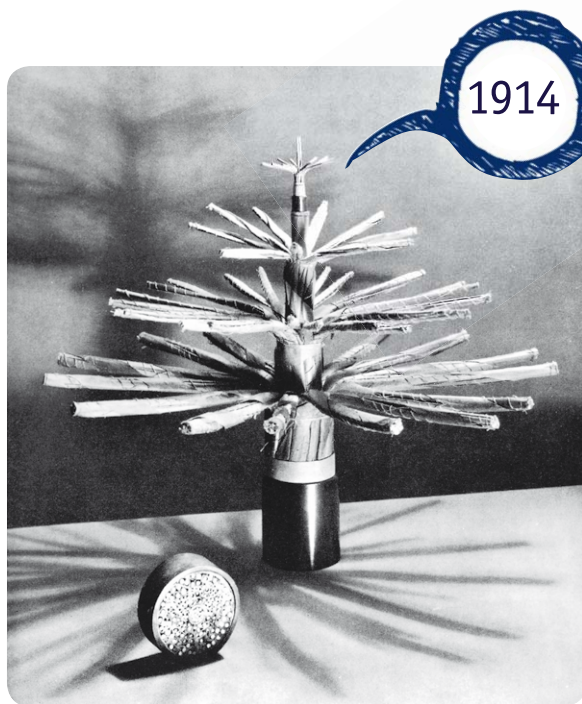
Bild 17: Hightech-Kabel von 1914 – pupinisiertes Fernmeldekabel
