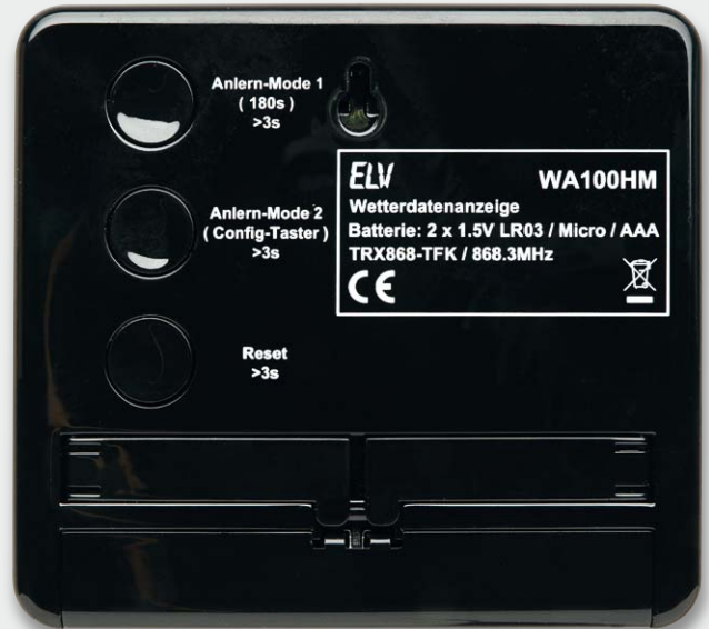
Bild 17: Die Rückseite der Wetterdaten-Anzeige WA100HM mit der Anordnung der Bedientasten
