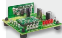
Anwendungsbeispiel: Einschaltautomat eingebaut in ein FS20- 4-Kanal-Sendemodul
