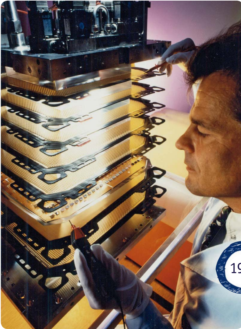
Bild 26: Weltmeister 1994 – die Hochtemperatur-Brennstoffzelle mit 1,8 kW Leistung
