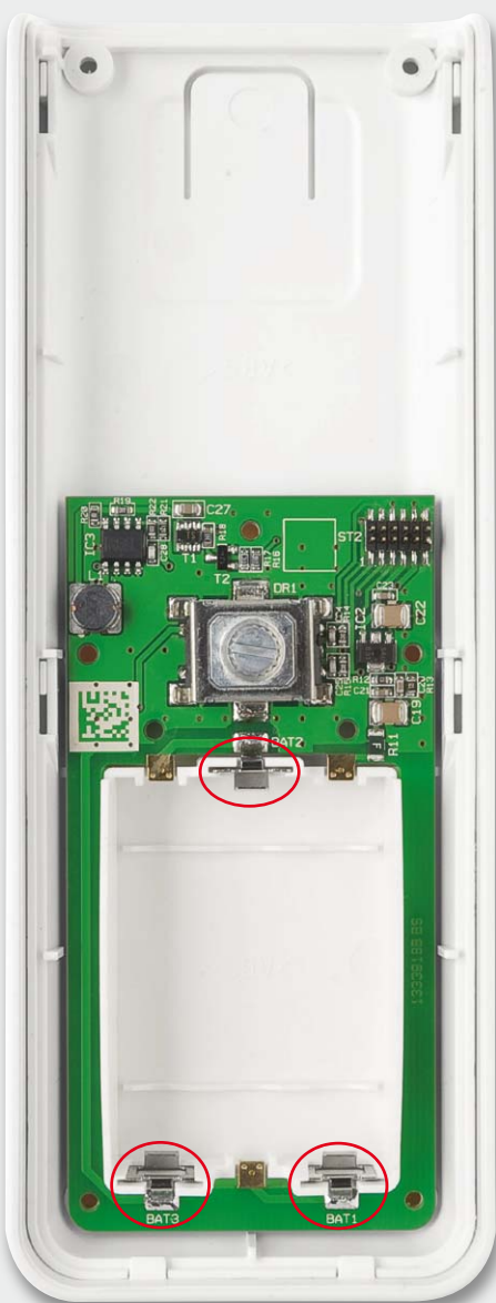
Bild 10: Mit Hilfe der in der Gehäuse-Unterschale eingelegten Encoderplatine lassen sich die Batteriekontakte genau ausrichten und korrekt verlöten.
