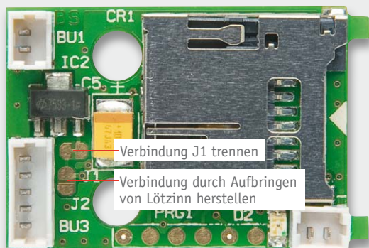
Bild 8: Die Maßnahmen bei Verwendung einer Betriebsspannung von 2,7 bis 3,3 V, dazu unbedingt die Ausführungen im Text beachten!
