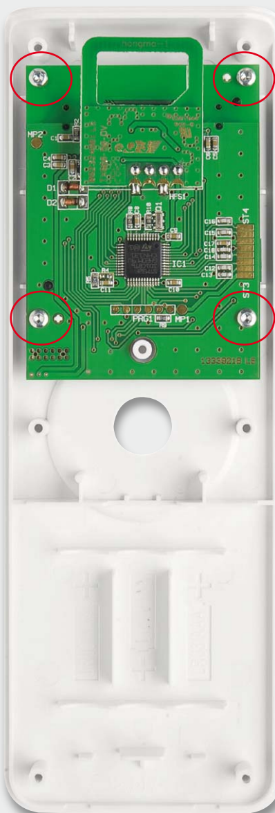
Bild 11: Die Displayplatine wird mit vier TORX-Schrauben im Gehäuseoberteil verschraubt.
