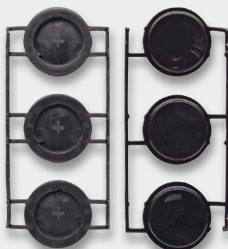
Bild 12: Die Vorbereitung der Tasterkappen, links unbearbeitet, rechts bearbeitet
