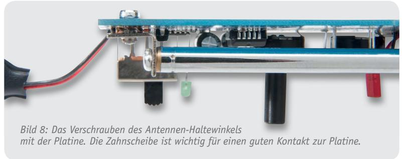
Bild 8: Das Verschrauben des Antennen-Haltewinkels mit der Platine. Die Zahnscheibe ist wichtig für einen guten Kontakt zur Platine.
