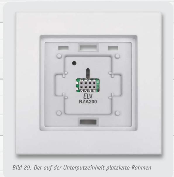
Bild 29: Der auf der Unterputzeinheit platzierte Rahmen
