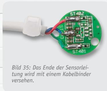
Bild 35: Das Ende der Sensorleitung wird mit einem Kabelbinder versehen.
