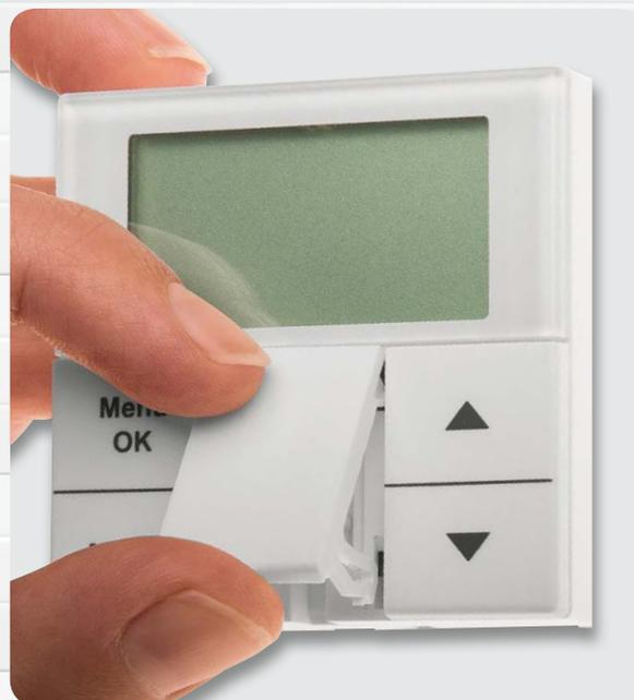
Bild 18: Das Einsetzen der Sensoranschluss-Abdeckung
