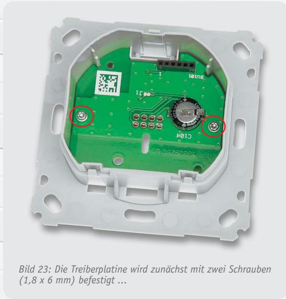
Bild 23: Die Treiberplatine wird zunächst mit zwei Schrauben (1,8 x 6 mm) befestigt ...
