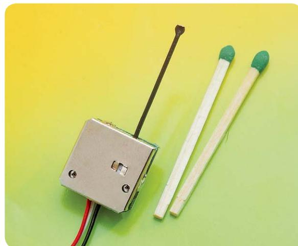
Bild 1: Videosender mit integrierter Kamera und Mikrofon
