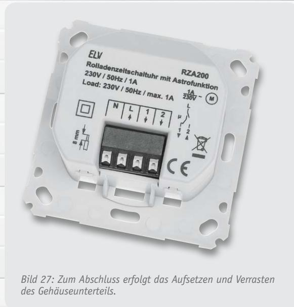
Bild 27: Zum Abschluss erfolgt das Aufsetzen und Verrasten des Gehäuseunterteils.
