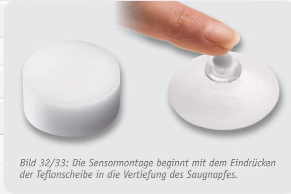
Bild 32/33: Die Sensormontage beginnt mit dem Eindrücken der Teflonscheibe in die Vertiefung des Saugnapfes.
