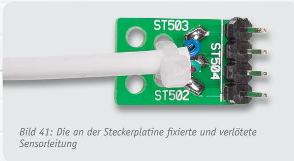
Bild 41: Die an der Steckerplatine fixierte und verlötete Sensorleitung
