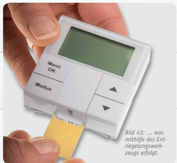
Bild 43: ... was mithilfe des Entriegelungswerkzeugs erfolgt.
