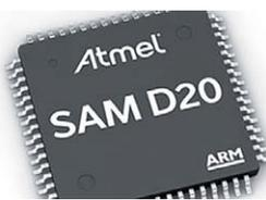
Mit dem ARM Cortex-M0+ will Atmel die Brücke für AVR-Anwender zum ARM-Prozessor schlagen. Der SAM D20 soll als flexible Plattform für Low-Power-/Low-Cost-Anwendungen im Industrie- und Consumerbereich agieren. Der mit 48 MHz getaktete ARM-Prozessor bietet bis zu sechs Kommunikationsschnittstellen, acht 16-Bit-Timer/-Zähler, einen Touch-Controller für bis zu 256 Kanäle, RTC, ADC/DAC und ein 8-Kanal-Event-System. [www.atmel.com/microsite/samd20/](http://www.atmel.com/microsite/samd20/)
