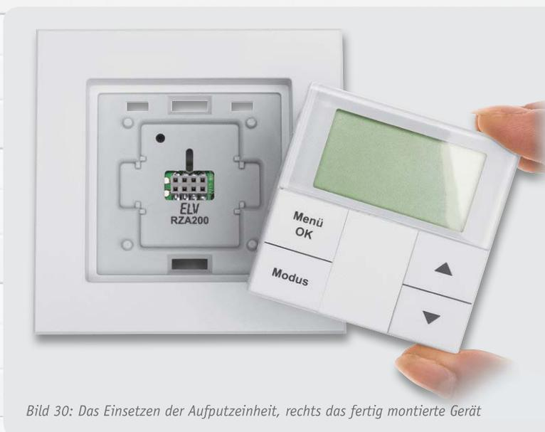
Bild 30: Das Einsetzen der Aufputzeinheit, rechts das fertig montierte Gerät
