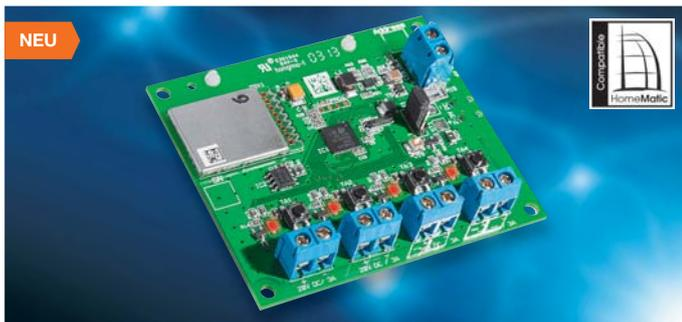
Der 4-Kanal-Schaltaktor ist besonders einfach einsetzbar, er verfügt nicht nur über einen weiten Spannungsbereich, als Schaltausgänge dienen leistungsfähige Open-Drain-Schaltausgänge.
