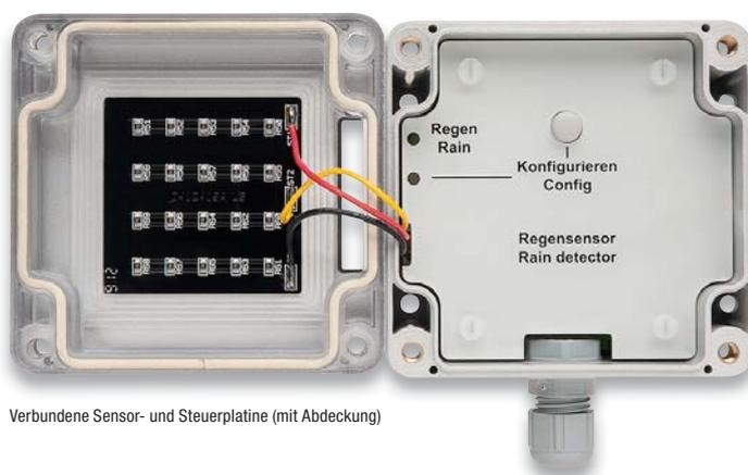
Verbundene Sensor- und Steuerplatine (mit Abdeckung)
