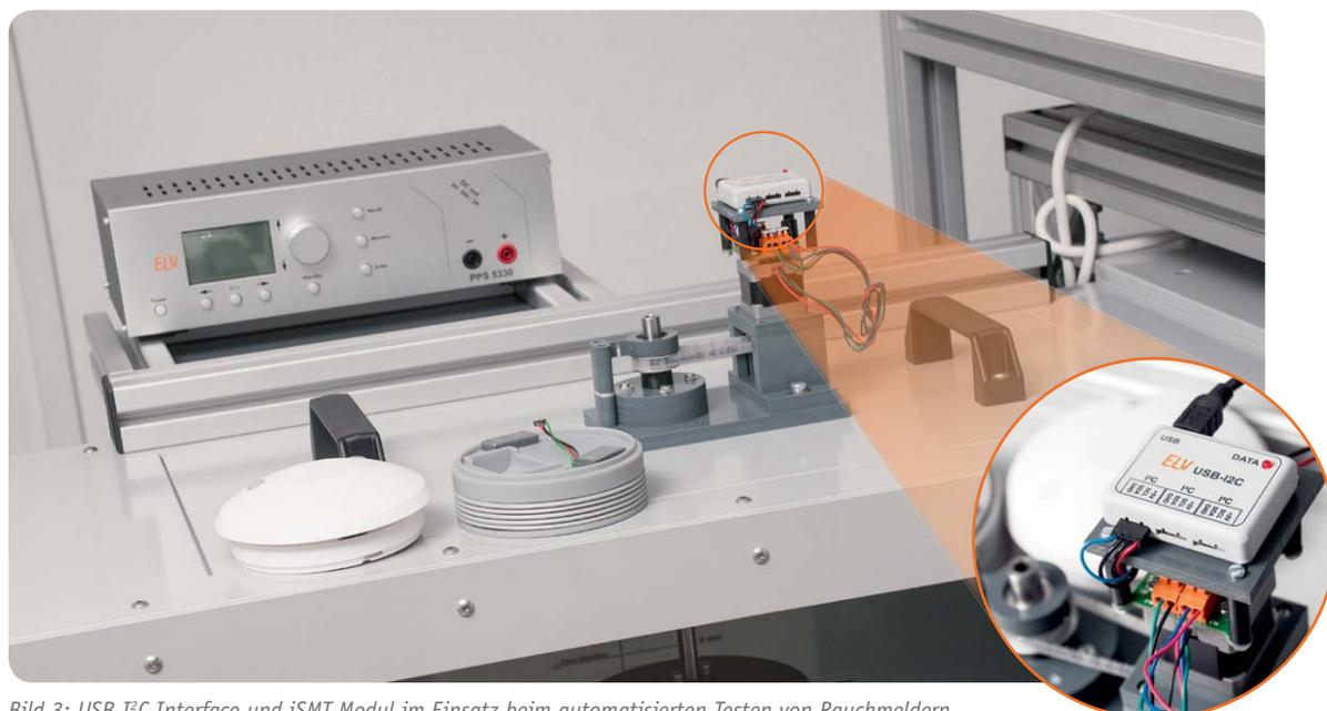
Bild 3: USB-I<sup>2</sup>C-Interface und iSMT-Modul im Einsatz beim automatisierten Testen von Rauchmeldern
