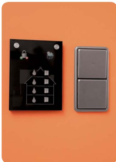
Bild 14: Die montierte Glasplatte der Statusanzeige
