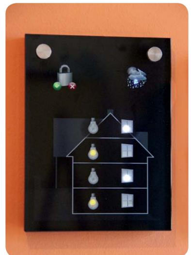
Bild 16: Perfekt! Die LEDs sind deutlich hinter den Symbolen der Glasplatte zu sehen.
