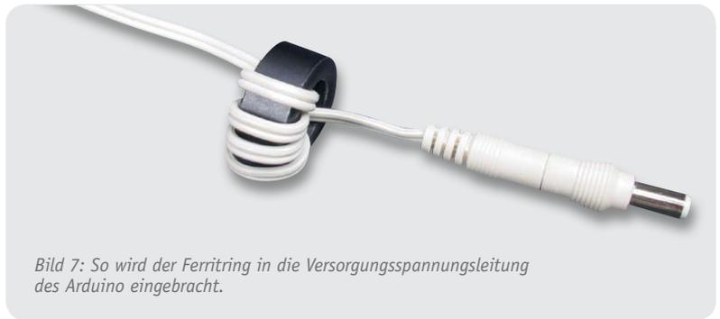
Bild 7: So wird der Ferritring in die Versorgungsspannungsleitung des Arduino eingebracht.
