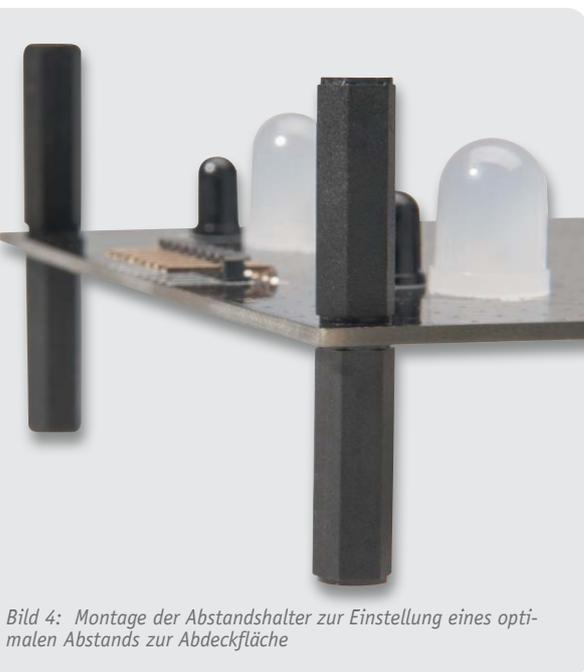
Bild 4: Montage der Abstandshalter zur Einstellung eines optimalen Abstands zur Abdeckfläche
