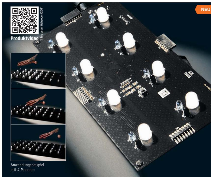
Ein Lichteffektgerät der besonderen Art: Sobald ein IR-Sensor eine Bewegung, z. B. eine überstreichende Hand, erkennt, löst er im steuernden Mikrocontrol-
