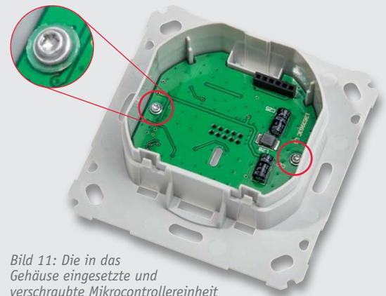
Bild 11: Die in das Gehäuse eingesetzte und verschraubte Mikrocontrollereinheit
