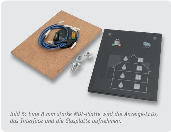
Bild 5: Eine 8 mm starke MDF-Platte wird die Anzeige-LEDs, das Interface und die Glasplatte aufnehmen.
