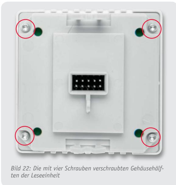
Bild 22: Die mit vier Schrauben verschraubten Gehäusehälften der Leseinheit
