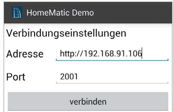
Bild 1: Der Startbildschirm der App: Setzen der Verbindungseinstellungen zum Auslesen der angelegerten Aktoren und Sensoren
