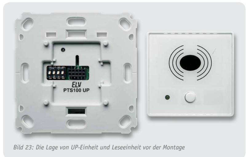
Bild 23: Die Lage von UP-Einheit und Leseinheit vor der Montage
