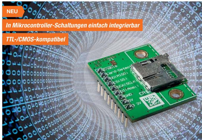
Kompakte Flash-Speicherkarten sind ein hervorragendes Speichermedium für die Daten- und Programmspeicherung in kleinen Mikroprozessorsystemen. Der MSDA1 ermöglicht genau diesen Einsatz.
