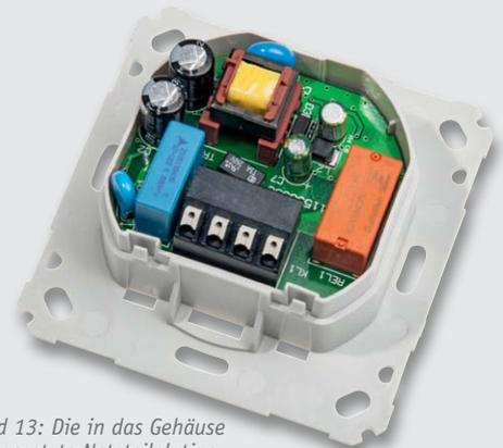
Bild 13: Die in das Gehäuse eingesetzte Netzteilplatine
