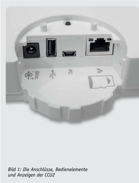
Bild 1: Die Anschlüsse, Bedienelemente und Anzeigen der CCU2
