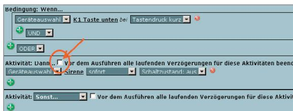
Im nachfolgenden Programmbeispiel bleibt nach Tastenbetätigung die Sirene dauerhaft ausgeschaltet, weil im Programm die parallel laufende Auslöseverzögerung in der CCU-Zentrale für die Sirene beendet wird.
