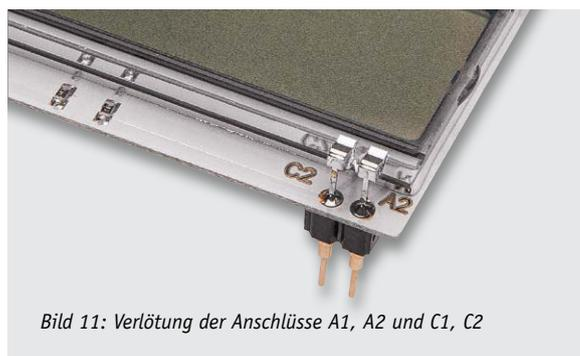
Bild 11: Verlötung der Anschlüsse A1, A2 und C1, C2
