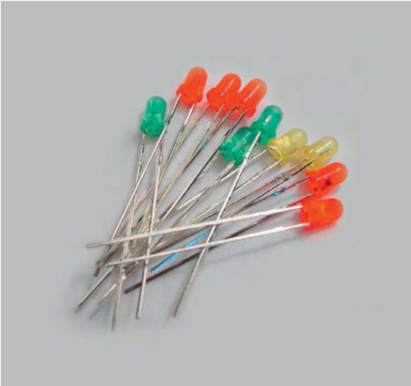
Bild 9: Geeignete LEDs für Mikrocontroller-Schaltungen
