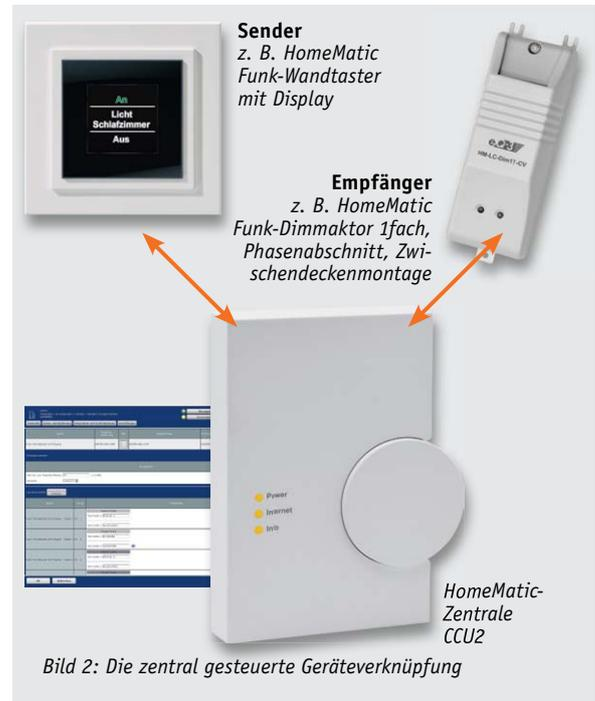
Bild 2: Die zentral gesteuerte Geräteverknüpfung
