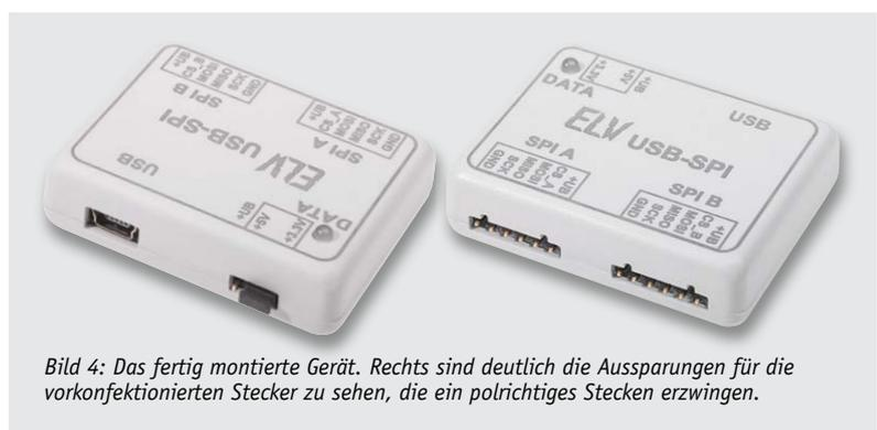
Bild 4: Das fertig montierte Gerät. Rechts sind deutlich die Aussparungen für die vorkonfektionierten Stecker zu sehen, die ein polrichtiges Stecken erzwingen.
