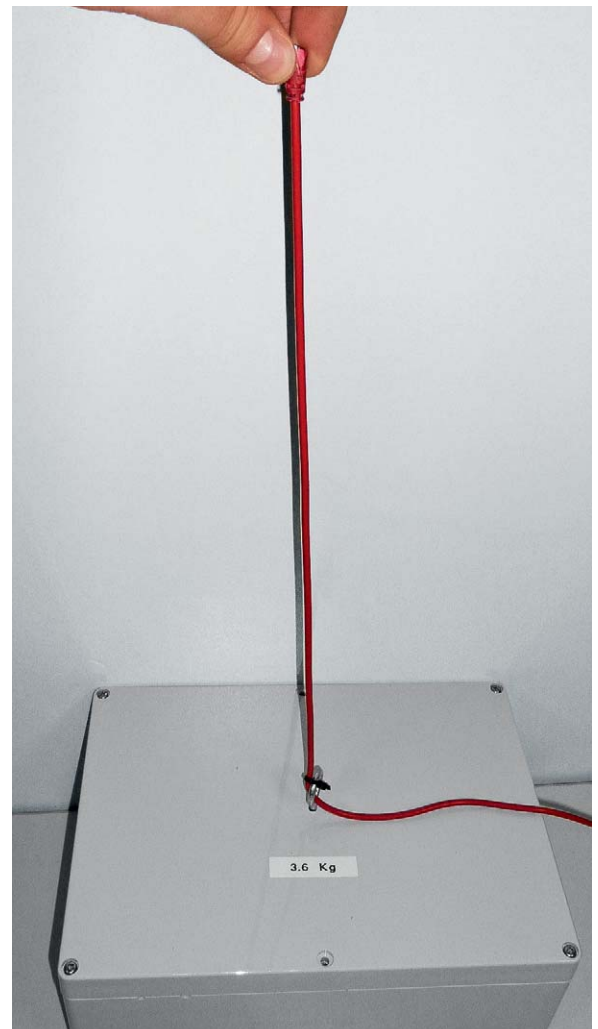
Bild 11: Wichtig für den Extremfall: Zugfestigkeitsprüfung für die Zugentlastung der Messleitung
