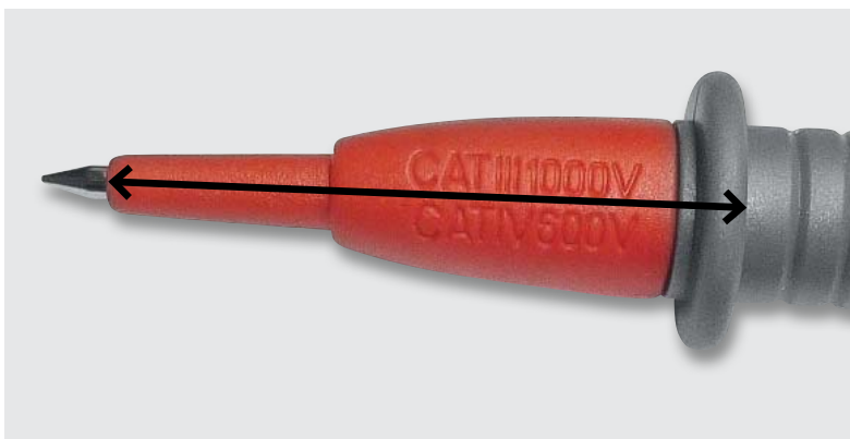
Bild 8: Auch der Abstand zwischen Messspitze und Sicherheitskragen ist einzuhalten: zum Beispiel mindestens 10,5 mm bei CAT II ab 600 V. Bei CAT IV sind dies sogar mindestens 24,3 mm.
