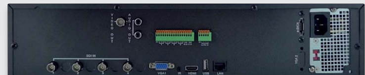
Bild 3: Äußerlich nicht von einem „herkömmlichen“ Digitalrecorder zu unterscheiden: ein HD-SDI-Recorder. Hier der BS HDVR 4X. Erst beim Blick auf die Kameraanschlüsse zeigt sich, dass er mit HD-SDI-Schnittstellen bestückt ist.
