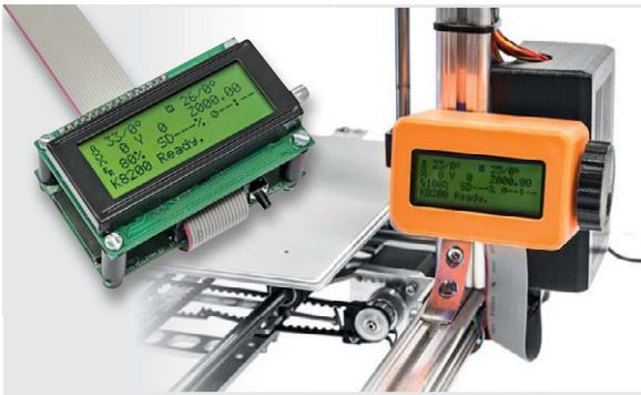
Bild 2: Über den RepRap-kompatiblen LCD-Controller kann der Drucker unabhängig von einem Computer arbeiten.
