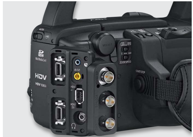
Bild 2: Bei professioneller Videotechnik schon lange Standard – die HD-SDI-Schnittstelle. Hier am Canon-Camcorder XHG1s. Quelle: Canon
