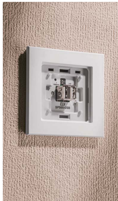
Bild 30: Montage des Abdeckrahmens
