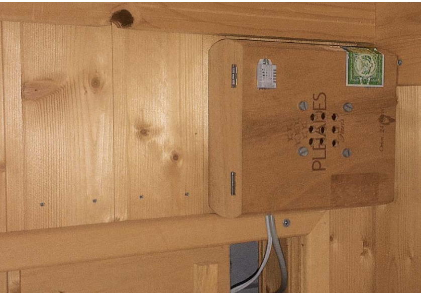
Bild 3: Lautsprecher und der DHT22 sind an einer vergleichsweise kühlen Stelle unter einer Liege untergebracht.
