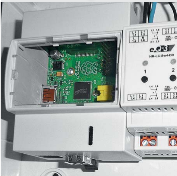
Bild 7: Spezialgehäuse für die DIN-Trageschienen-Montage, so ist der Raspberry Pi einfach integrierbar in eine Gebäudeautomationsanlage. Bild oben: www.modmypi.com
