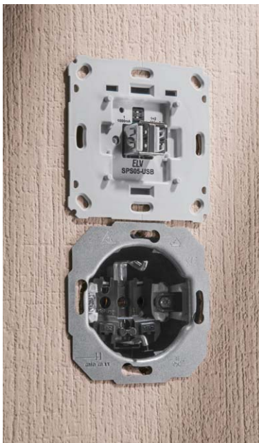
Bild 29: Einbau des SPS05-USB in eine Gerätedose
