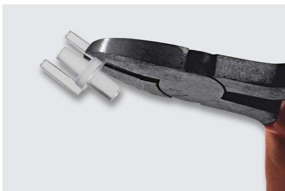
Bild 24: Vorbereitung der Lichtleiter
