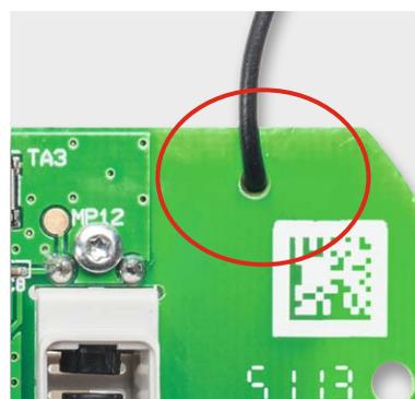
Bild 6: Hier ist die Antenne des Transceivermoduls hindurchzuführen.
