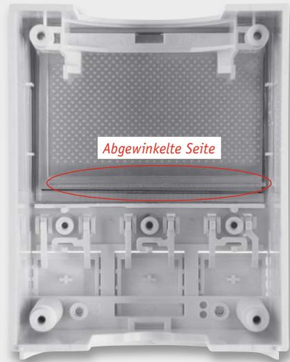
Bild 7: Auf die Diffusor-Folie wird die Lichtverteilplatte gelegt.
