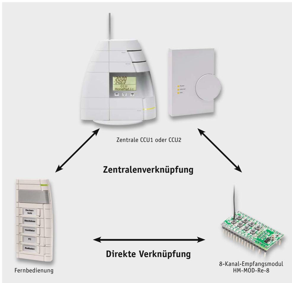
Bild 2: Unterschied zwischen direkter Verknüpfung und Zentralenverknüpfung
