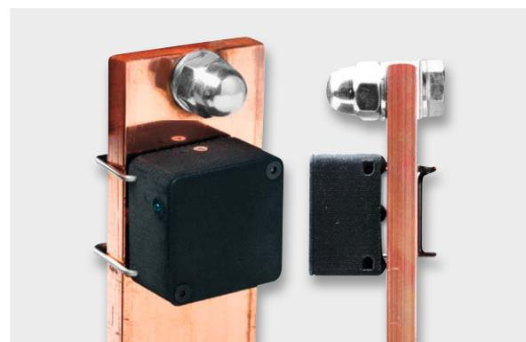
Bild 31: Dieser mNode-Funk-Sensor von Micropelt bezieht seine Energie aus dem Magnetfeld einer Stromschiene und überwacht ständig deren Temperatur, um Unregelmäßigkeiten im Betrieb aufdecken zu können. Quelle: Micropelt
