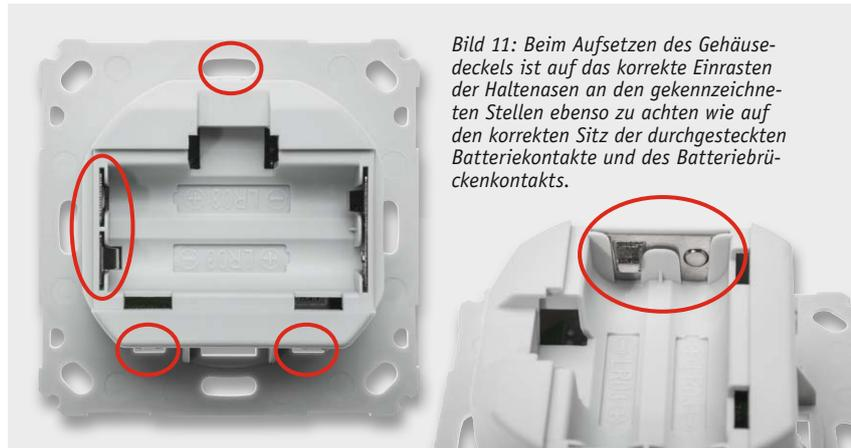
Bild 11: Beim Aufsetzen des Gehäusedeckels ist auf das korrekte Einrasten der Haltenasen an den gekennzeichneten Stellen ebenso zu achten wie auf den korrekten Sitz der durchgesteckten Batteriekontakte und des Batteriebrückenkontakts.
