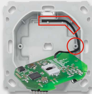
Bild 12: Die Antenne des Transceivers ist genau wie hier gezeigt einzulegen.
