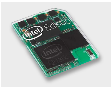
Bild 20: Intel-Linux-Winzling im SD-Kartenformat – der Edison. Bild: Intel
