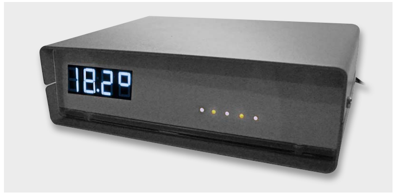
Bild 5: Im Eigenbau erstelltes \mu C-basiertes Computer-Thermometer mit Übertemperaturalarm und 5 Alarmausgängen zur Überwachung von Serverräumen
