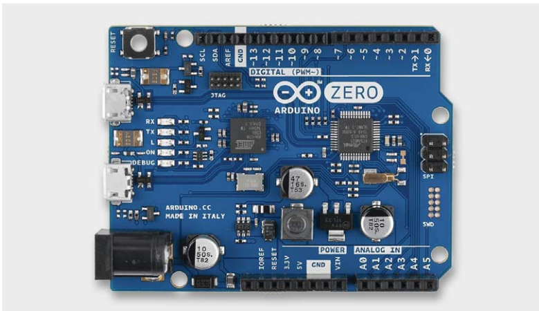
Bild 7: Erstes 32-Bit-Arduino-Original, der Arduino Zero. Bild: arduino.cc
