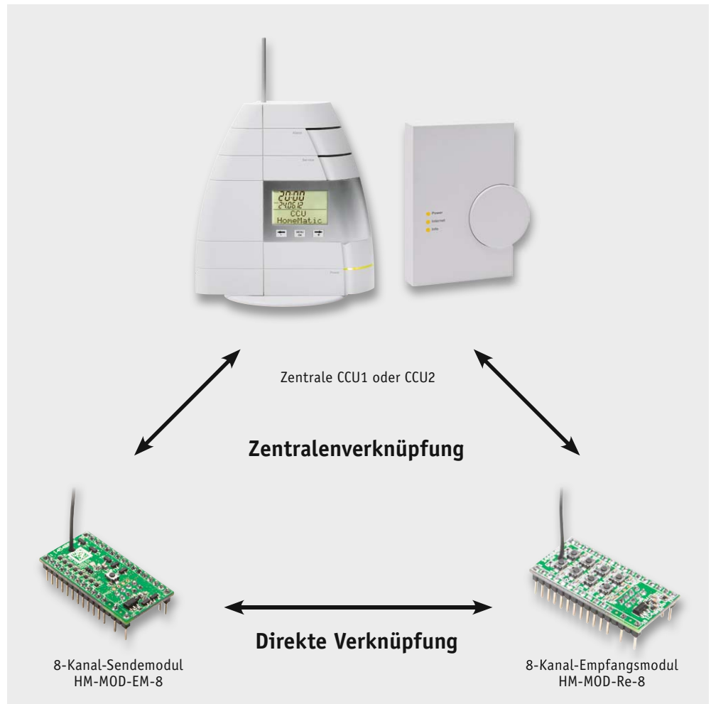
Bild 4: Unterschied zwischen direkter Verknüpfung und Zentralenverknüpfung
