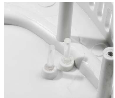
Bild 15: Nachgebessert: Die LEDs haben nun Lichtleiter erhalten.
