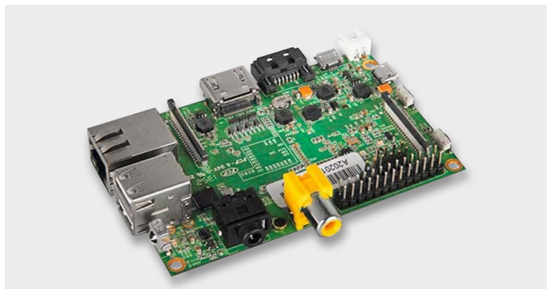
Bild 16: Leistungsfähige Alternative zum Raspberry Pi – der Banana Pi mit 1 GHz-Dual-Core-Processor, 1 GB RAM, SATA, IR-Fernbedienung und Gigabit-LAN. Bild: bananapi.org
