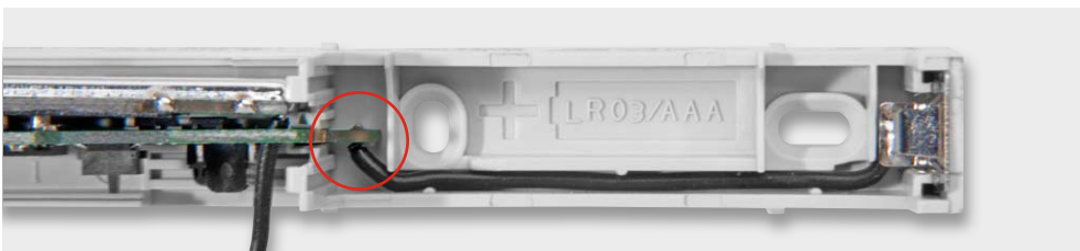
Bild 4: Der Batteriekontakt wird über eine passende Leitung mit der Platine verbunden. Hier sieht man die in das Gehäuse eingelegte Platine, den in der vorgesehenen Aussparung verlegten Draht zum Batteriekontakt sowie diesen an seinem Montageort.
