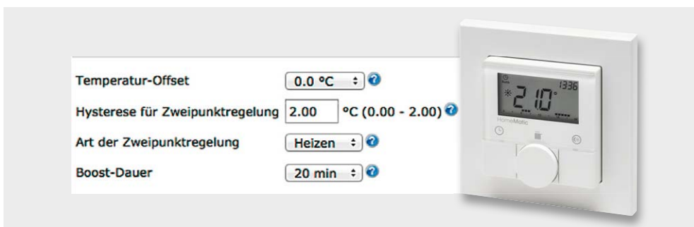
Bild 2: Das nützliche Feature „Zweipunktregler“ wird erst nach Anmelden des Thermostaten in der CCU sichtbar.
