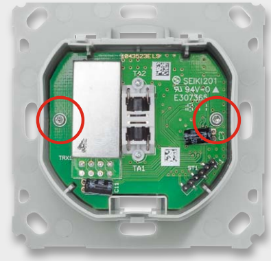
Bild 13: Die im Gehäuse verschraubte Controllerplatine
