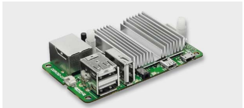
Bild 12: Rechenpower wie ein Großer – ODROID-U3 mit 1,7-GHz-Quad-Core. Bild: hardkernel.com
