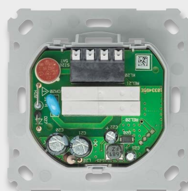
Bild 15: Die eingelegte und aufgesteckte Leistungsplatine, hier des Schaltaktors
