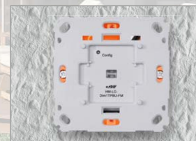
Schritt 4: Schließen Sie den neuen Unterputz-Schaltaktor, wie in der Bedienungsanleitung beschrieben, an und montieren diesen in der Unterputzdose.
