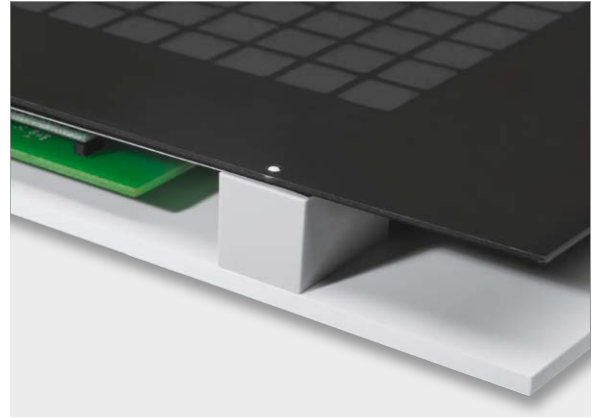
Bild 14: Die mittels der Zentriernasen in der Lichtmaske positionierten Folien (Diffusor/Farbfiler) und die Frontblende
