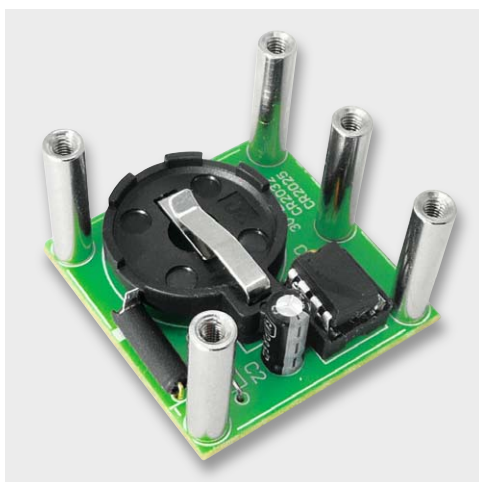
Bild 5: Die mit den Abstandshaltern versehene Prozessor-Platine
