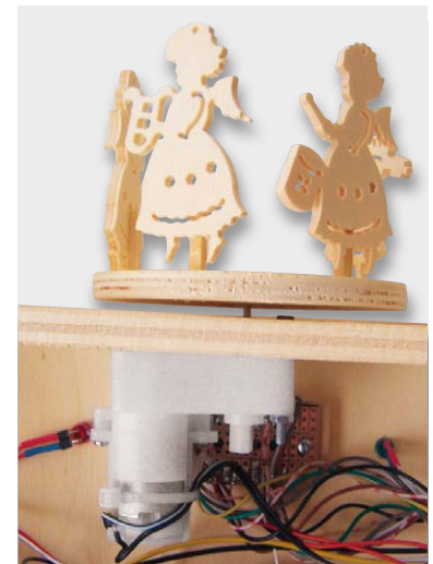
Bild 12: Getriebemotor mit Drehscheibe und aufgesteckten Pyramidenteilen
