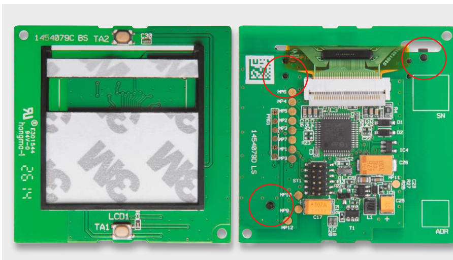
Bild 12: Der auf die Controllerplatine aufgesetzte Montagerahmen, rechts ist die Lage der Fixiernippel auf der Platinenunterseite markiert
