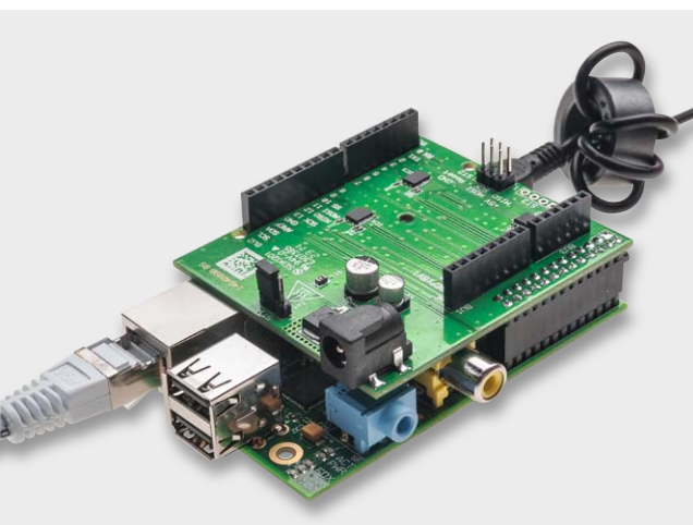
Bild 13: Die betriebsbereite Kombination aus Raspberry Pi mit Anschlusskabeln sowie dem RPi-AA1-Adapterboard.
