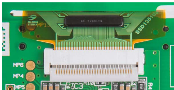
Bild 15: Die eingelegte und fixierte Displayleitung. Sie wird durch den eingerasteten beweglichen Teil des Verbinders fixiert.
