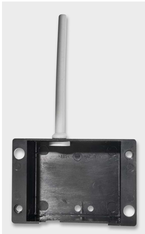
Bild 4: So wird das Gehäuseoberteil mit der Antennenhülle versehen.
