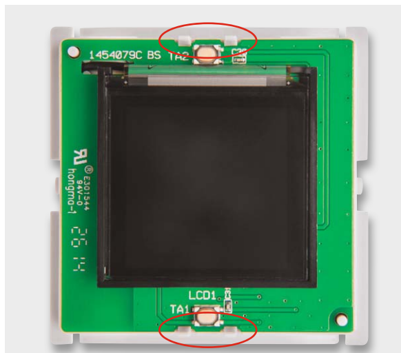
Bild 16: So erfolgt das Aufsetzen der Controllerplatine auf die Funkplatine. Dabei ist sorgfältig auf das Einführen der Steckkontakte des 12-poligen Steckverbinders sowie auf das saubere Einrasten der Platinenhalter zu achten.
