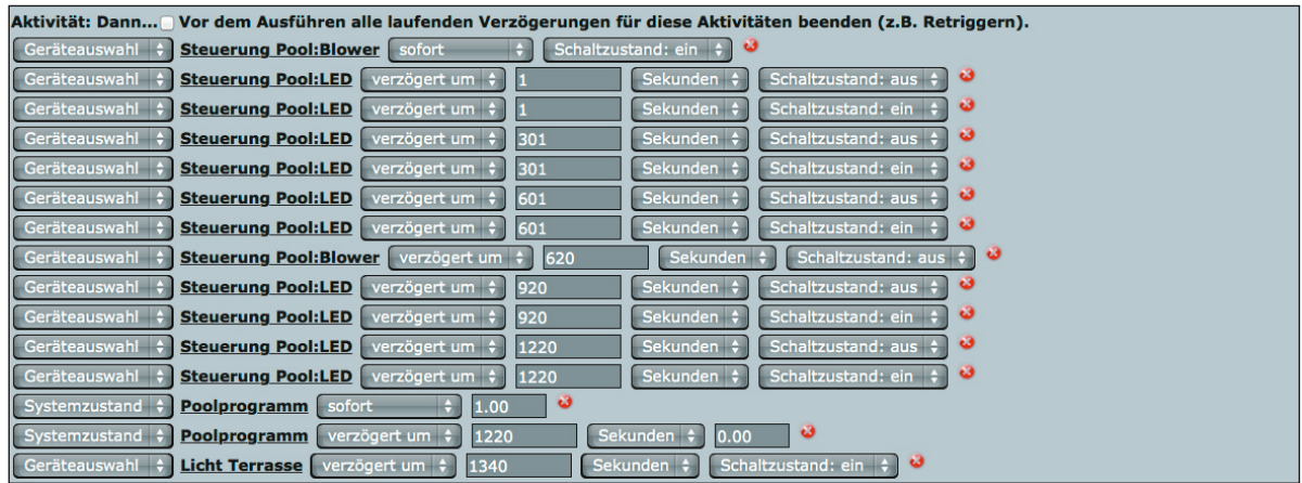
Bild 14: Das Programm zur Automatisierung bei der Pool-Benutzung
