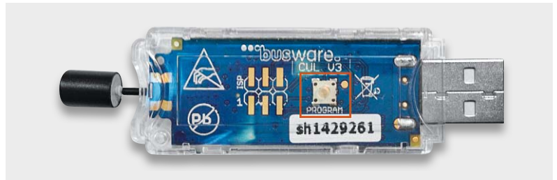
Bild 1: Die Lage der „Program“-Taste auf dem CUL-Stick
