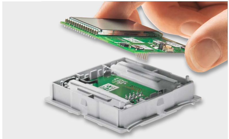
Bild 8: So wird die Basisplatine auf die Spannungsversorgungsplatine aufgesetzt.
