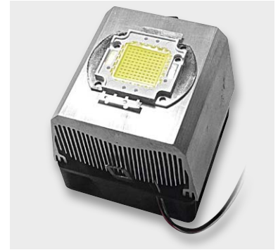
Bild 6: 100-W-COB-LED auf einem zwangsbelüfteten Kühlkörper, so passt solch eine Leuchte auch in kompaktere Scheinwerfer.
