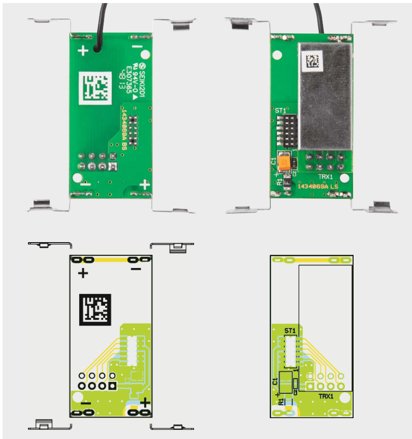
Bild 4: Die mit dem Transceiver-Modul bestückte Batterieplatine mit dem Bestückungsplan
