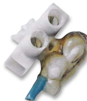
Geschmolzene Schraubklemme nach Verdrahten mit verzinneter Litze
