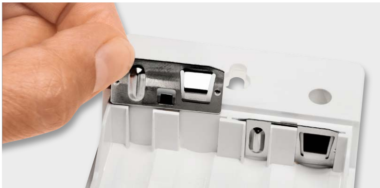
Bild 12: Das Einsetzen der Batterie-Brückenkontakte
