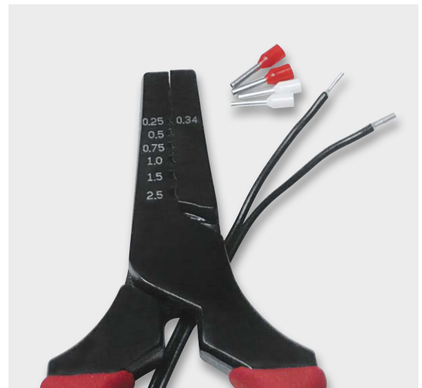
Bild 6: Flexible Litzenenden sollten mit Adernendhülsen versehen werden, hier ein Beispiel für eine Zuleitung von einem Steckernetzteil, daneben isolierte Adernendhülsen und eine einfache Crimpzange für Adernendhülsen.
