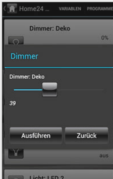
Bild 13: Steuerung eines Dimmers
