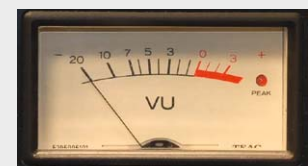
Ein analoges VU-Meter, hier bereits mit einem separaten LED-Indikator (Quelle: Wikipedia [1])
