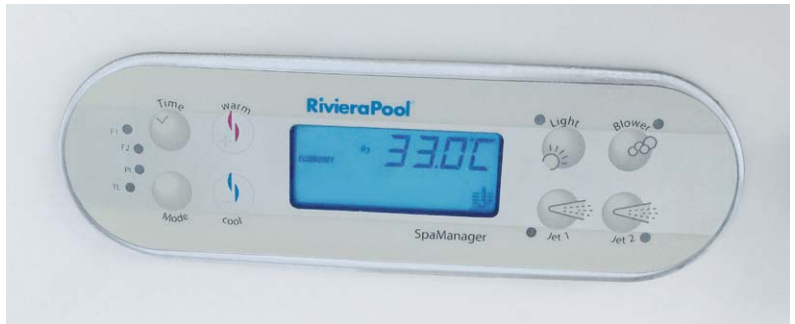
Bild 1: Das Bedienteil der Whirlpool-Steuerung
