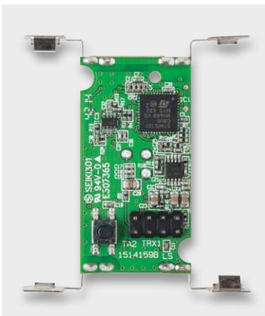
Bild 12: Die Platine mit bestückter Stiftleiste
