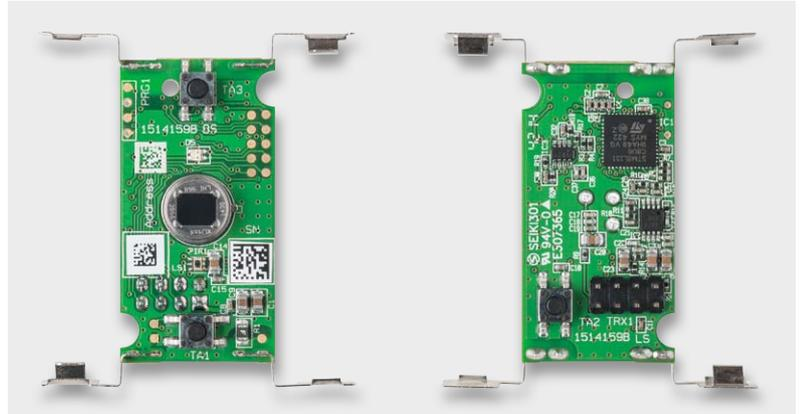
Bild 9: Die Platine mit den bestückten Batteriekontakten
