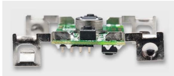
Bild 11: Die Batteriekontakte müssen senkrecht zur Platine stehen.
