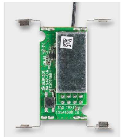
Bild 14: Platine mit bestücktem Transceiver-Modul
