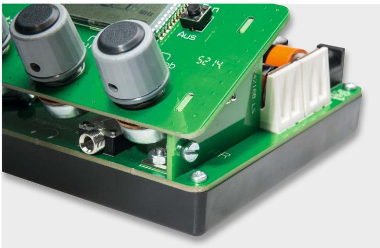
Bild 14: Hier ist der korrekt verschraubte Befestigungswinkel auf der rechten Seite zu sehen.
