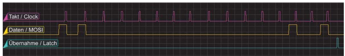
Bild 3: Signalverlauf 16-Bit-Schieberegister
