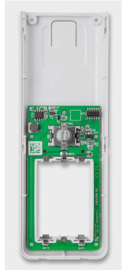
Bild 6: Die Lage der Batteriekontakte auf der Encoderplatine
