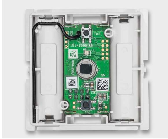
Bild 16: Die in das Gehäuse eingesetzte Platine
