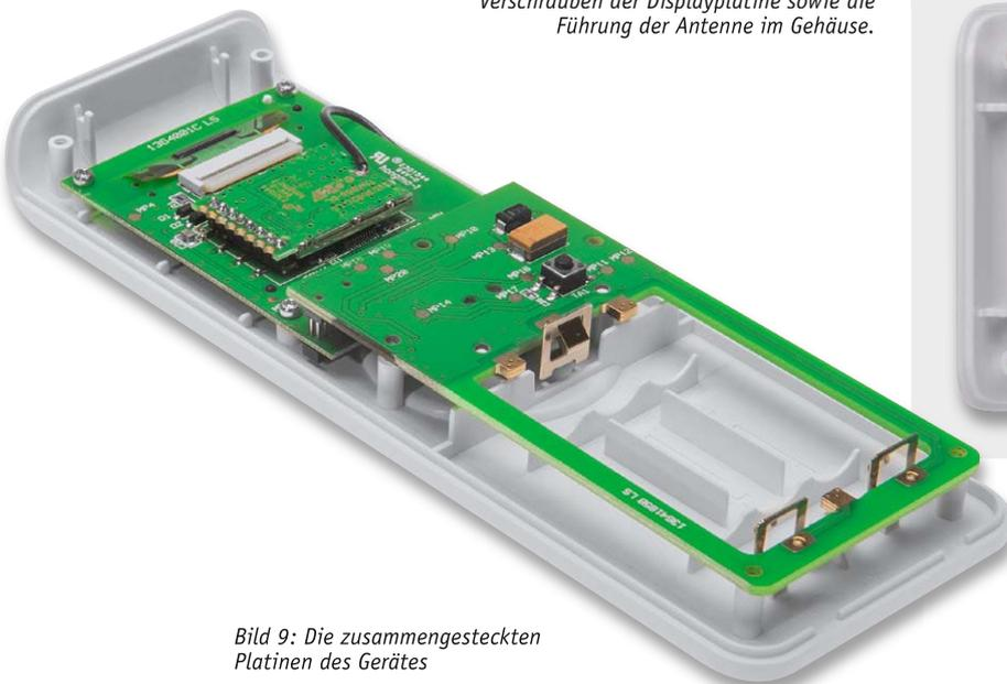
Bild 9: Die zusammengesteckten Platinen des Gerätes
