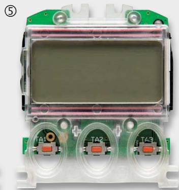
Jetzt kann die Basisplatine mit der Steckereinheit aufgelegt werden. Wenn die Leitungen entsprechend geführt sind, sollte es keine Kollision mehr zwischen der Displayplatine und der Basisplatine geben.
