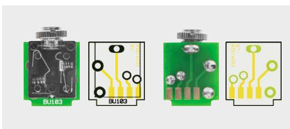
Bild 7: Die Kopfhörerbuchse wird in die Zusatzplatine eingelötet ...
