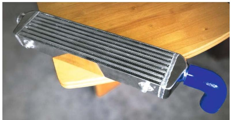
Bild 3: Als Wärmetauscher wird ein Laduluftkühler eingesetzt.
