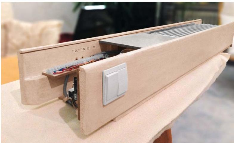
Bild 9: Über zwei Schalter werden die Betriebsarten eingestellt.
