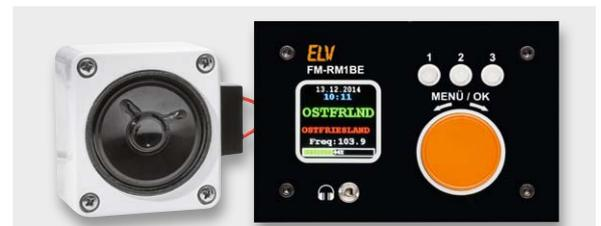
Bild 15: Das betriebsfertige Radio, hier ergänzt durch einen kleinen Lautsprecher
