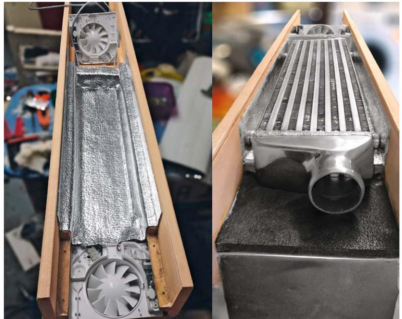
Bild 4: Die Schall- und Wärmeisolierung des Wärmetauschers
