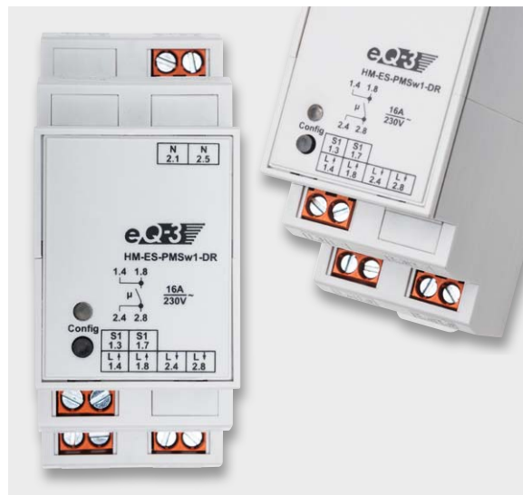
Bild 12: Hier ist im Überblick zu sehen, welche Abdeckungen in das Gehäuse einzusetzen sind.
