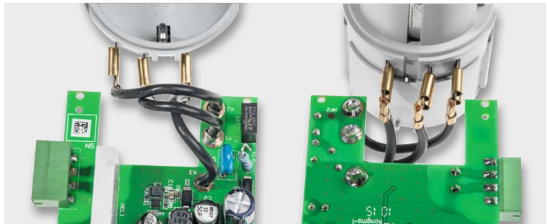
Bild 4: Der Anschluss der Steckverbinder an den Steckdoseneinsatz
