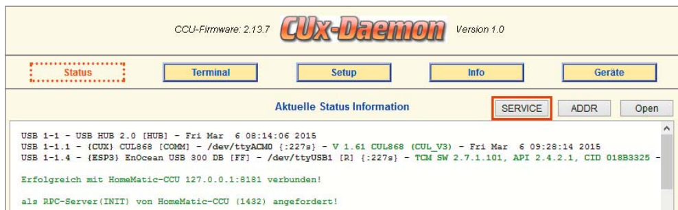
Bild 2: Über die CUXD-Startseite erfolgt via Servicebutton die Verzeichniserstellung auf der Speicherkarte.
