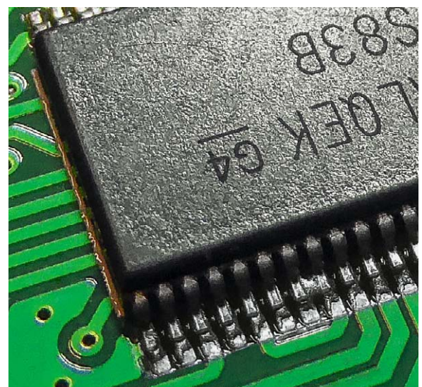
Bild 17: Bis auf eine Lötbrücke ebenfalls gelungen: der Schaltkreis mit 0,3 mm Pinabstand – von Hand überhaupt nicht lötfähig.
