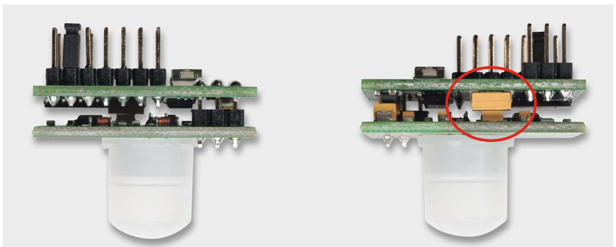
Bild 6: Bei der direkten Verbindung beider Module müssen die Platinen exakt parallel zueinander liegen. Dabei stützen die gekennzeichneten Kondensatoren die Platinen gegeneinander ab.
