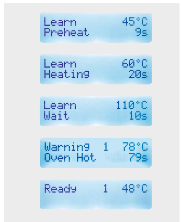
Bild 8: Beim Lernprozess ist jeder Schritt über den Controller verfolgbar.
