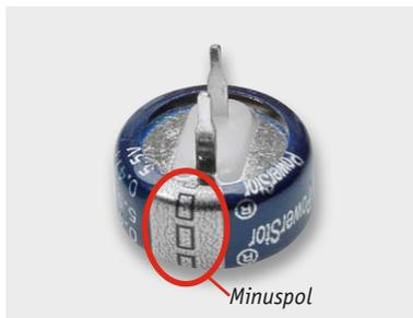
Bild 7: Am Gold-Cap ist der Minuspol gekennzeichnet.
