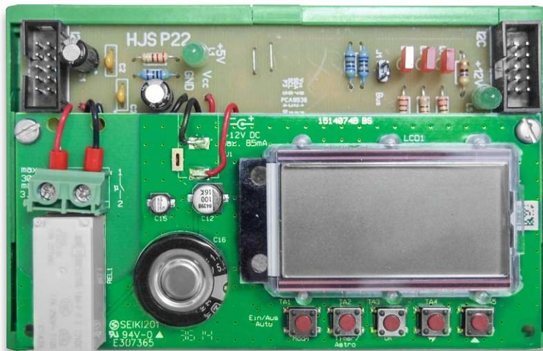
Bild 5: Das fertig aufgebaute WTMA1-Modul mit bestückter Wochenzeitschaltuhr
