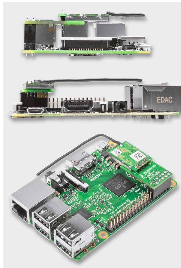
Bild 8: Verlegung der Antenne
