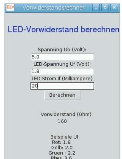
Bild 14: Tkinter-LED-Vorwiderstandsrechner
