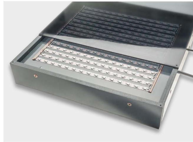
Bild 14: LED-Matrix mit erkennbarer Frontplatte
