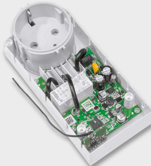
Bild 8: Hier ist die eingesetzte und festgeschraubte Platine zu sehen, auch die Steckereinheit ist bereits im Gehäuse platziert.
