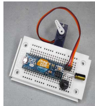
Bild 2: Durch den mitgelieferten Arduino Micro ist der Einstieg in die Sensor- und Steuerungstechnik besonders einfach.
