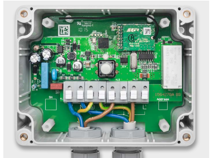
Bild 11: Der Anschluss der Leitungen erfolgt über die Cage-Clamp-Steckklemmen: Betätigungstaster mit einer Schraubendreherklinge drücken, die auf 10–11 mm abisolierten Leitungsenden einführen, loslassen.
