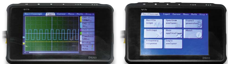
Bild 3: Mini-Oszilloskop auf ARM-Prozessorbasis mit Open-Source-Software
