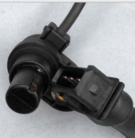
Die Messung des Sensorsignals an einem Luftmassensensor
