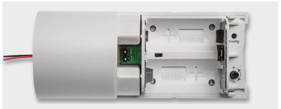
Bild 12: Die mit dem Gehäuse verschraubte Platine inklusive Batteriehalter
