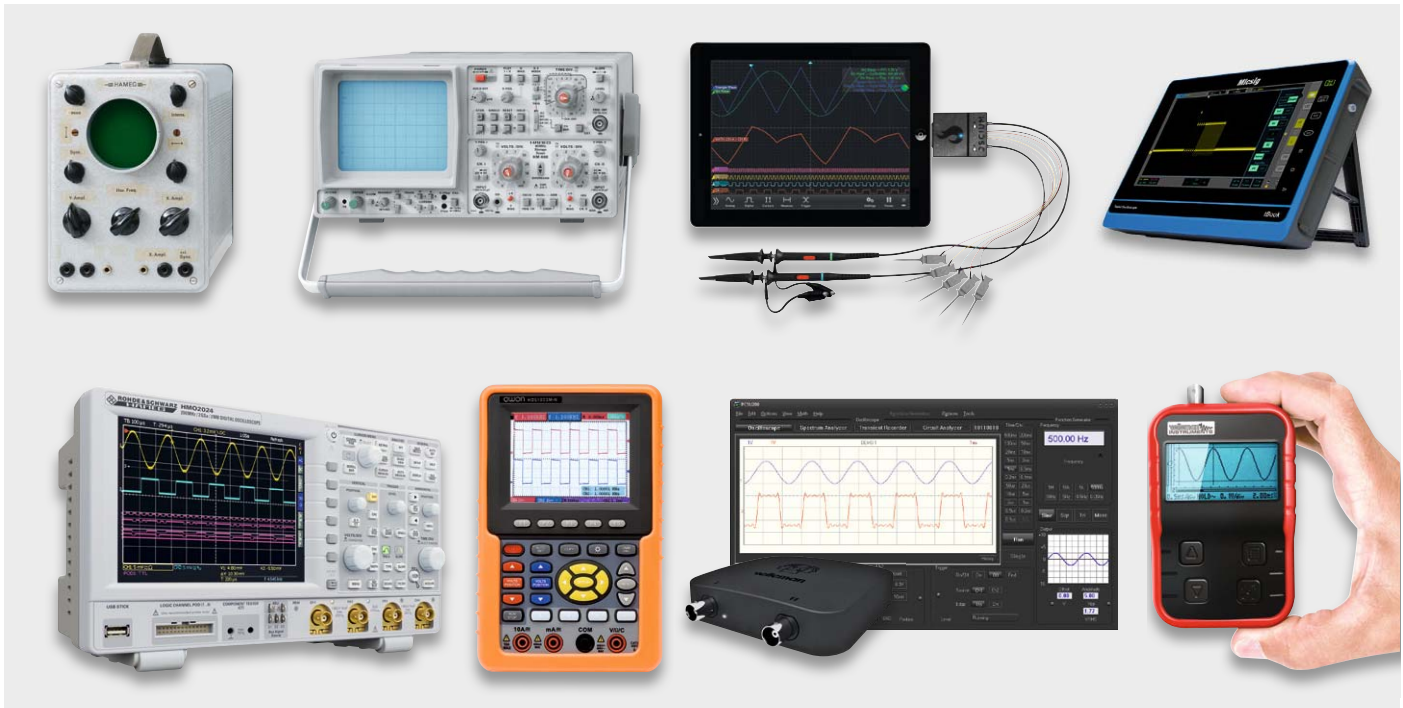
Bild 1: Oszilloskope gibt es in vielfältigen Formen – vom historischen Katodenstrahl-Oszilloskop bis hin zum App-basierten Messvorsatz für den Tablet-PC.
