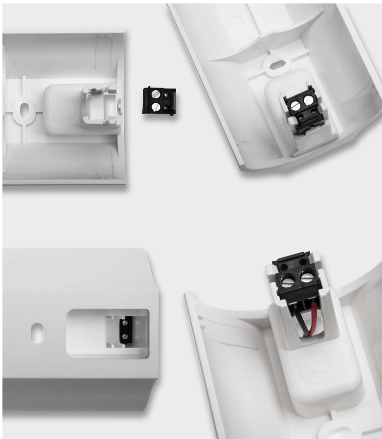
Bild 16: So erfolgt das Einsetzen und Verdrachten der Anschlussklemme KL1 im Wandhalter.
