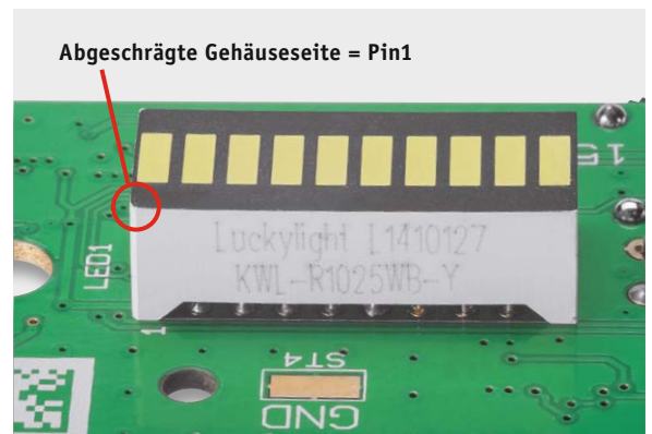
Bild 5: Die Polung der LED-Anzeige ist an der abgeschrägten Gehäusekante an Pin 1 zu erkennen.
