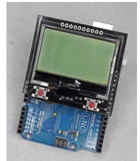
Bild 1: Das Grafikdisplay des Maker Kits wird über einen Arduino Uno angesteuert.
