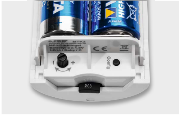
Bild 1: Das Lautstärke-Einstellpotentiometer ist ebenso unterhalb des Batteriefachs zu finden wie der Config-Taster für die Konfiguration und der micro-SD-Kartenschacht.
