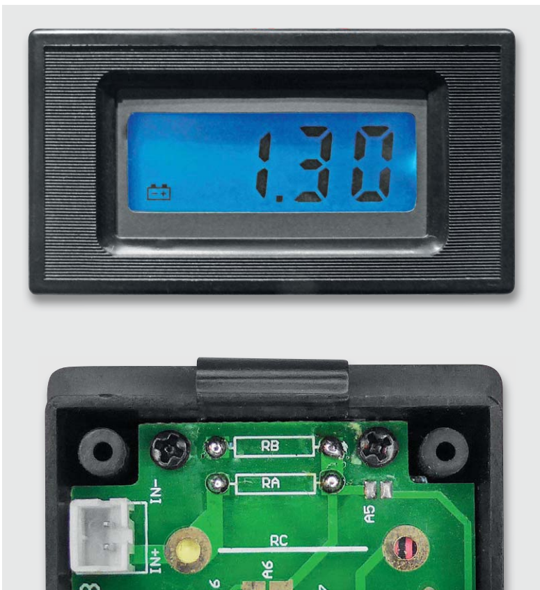
Bild 8: Preiswerte Panelmeter wie das hier gezeigte, weitverbreitete PM435 können als Anzeige eingesetzt werden. Sie sind über Spannungsteilerwiderstände (RA/RB) bzw. Shunts (RC) für die Anzeigeaufgabe konfigurierbar.
