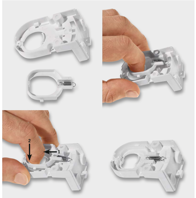
Bild 19: ... um sie dann in das Halterungsunterteil einzuhaken. Danach wird die Feder gespannt (1) und der Riegel in das Unterteil der Halterung eingeführt (2).
