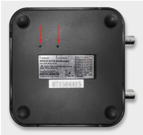
Bild 3: Auf der Unterseite finden sich der Abnahmepunkt für das Tastkopf-Prüfsignal und die Reset-Taste für den Access-Point.
