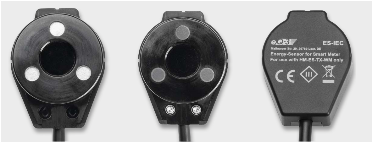
Bild 12: Nachdem man sich vergewissert hat, dass die Anschlussleitung weit genug ins Gehäuse eingeschoben wurde, wird dieses mit den beiden TORX-Schrauben verschlossen und es sind die drei KlebefüÙe aufzukleben. Rechts das Gehäuse von der Unterseite gesehen.
