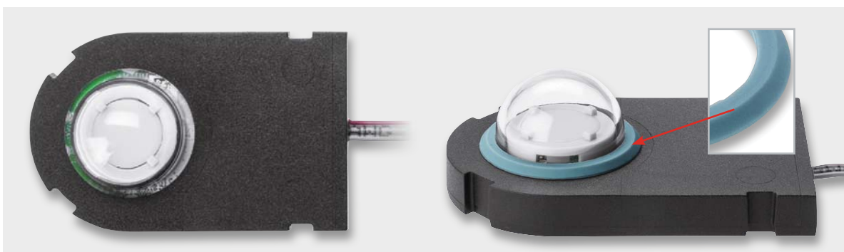
Bild 10: Die hier bereits vergossene Platine samt Sensor. Hier ist noch der Dichtring mit der abgeschrägten Seite nach oben aufzusetzen.
