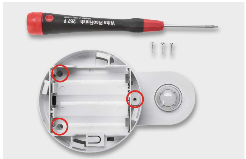
Bild 17: Nach dem Aufsetzen des Batteriefachs ist dieses mit 3 TORX-Schrauben zu befestigen.
