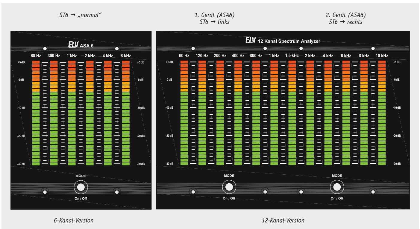
Bild 12: Die Frontplatten der 6-Kanal- und 12-Kanal-Version mit Zuordnung der Steckbrücke ST6
