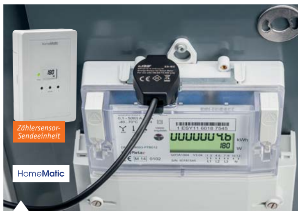
25 Energie-Sensor für Smart Meter Der Sensor liest die optische Schnittstelle von Smart Metern nach IEC 62056-21 (IEC 1107) aus und übergibt sie an die Sendeeinheit des HomeMatic Energiezähler-Erfassungssystems
