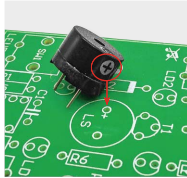
Bild 4: Der Signalgeber muss polrichtig eingesetzt werden.
