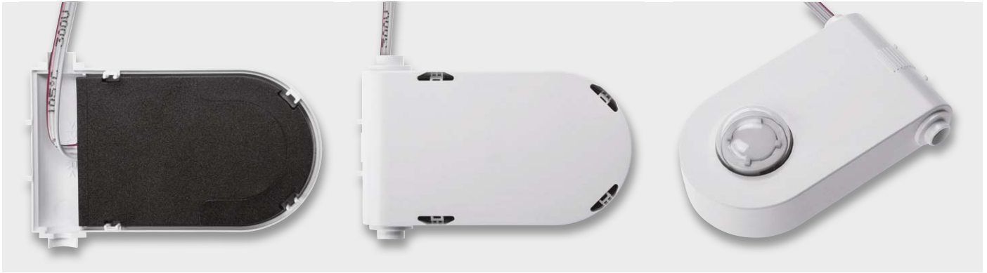
Bild 11: Das Einsetzen des vergossenen Sensormoduls: links das Einlegen in die Gehäuseoberschale mit nach oben herausgeführtem Flachbandkabel, in der Mitte die Ansicht mit aufgesetzter Unterschale. Rechts ist die komplett zusammengesetzte Einheit zu sehen.
