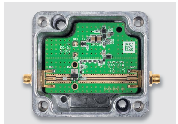
Bild 8: SMA-Buchsen positioniert und auf der Oberseite angeheftet
