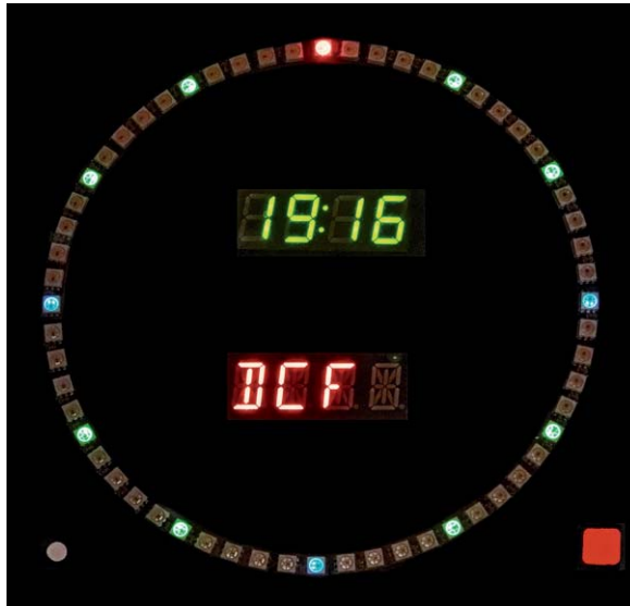
Bild 9: Die Uhrzeitanzeige – hier läuft die DCF77-Synchronisierung.
