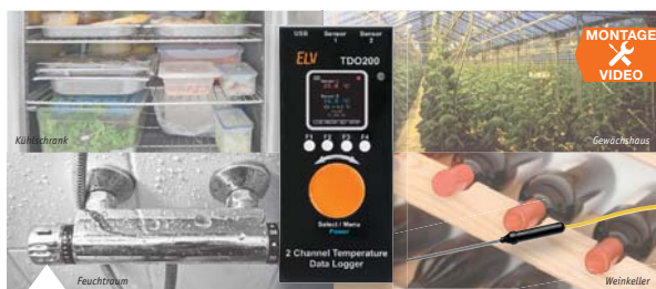
40 2-Kanal-Temperatur-Datenlogger, Teil 2 Ausdauernder Datensammler mit bis zu 260.000 Datensätzen in bis zu 180 Tagen – der Aufbau
