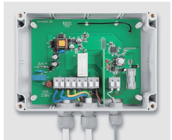
Innenansicht des Homematic Funk-Sollwertgebers
