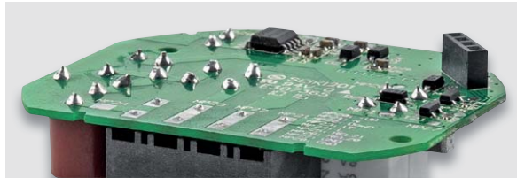
Bild 12: Alle auf der Platinenunterseite verlöteten Bauteilanschlüsse sind auf max. 1,2 mm zu kürzen.
