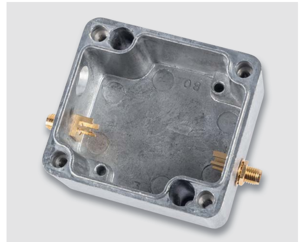
Bild 6: Metallgehäuse mit eingebauten SMA-Buchsen (senkrecht gestellt)
