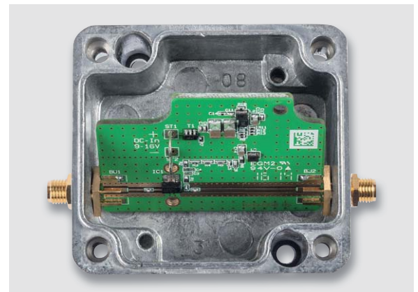
Bild 7: Leiterplatte senkrecht in die SMA-Buchsen eingeschoben
