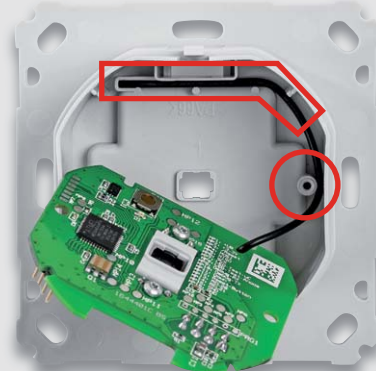
Bild 15: Die Antenne des Transceivers ist genau wie hier gezeigt einzulegen.
