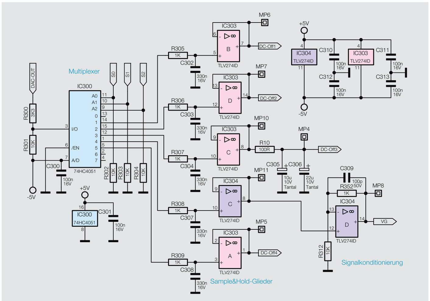
Bild 6: Die Sample-and-Hold-Schaltung
