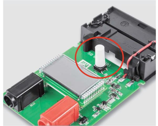
Bild 17: Den Abschluss der Vormontage bildet das Aufsetzen der Tasterkappe auf TA1.
