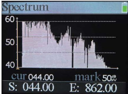
Bild 7: Spektrum für DVB-C mit HD 3 Combo
