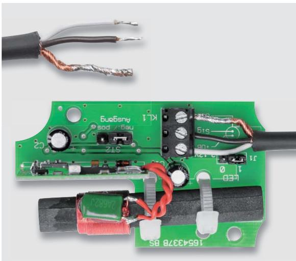
Bild 9: So werden die Kabelenden abisoliert und an die Klemme KL1 angeschlossen.
