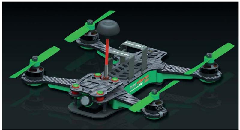
Bild 10: Eine hochwertige Rundstrahlantenne wie die Cloverleaf-Antenne auf dem Horizon Blade Vortex 250 Pro FPV sichert eine gute Videokanal-Reichweite bei allen Flugmanövern.
