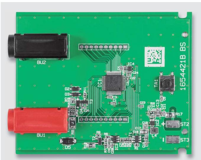
Bild 10: So erfolgt die richtige Bestückung der Messbuchsen.
