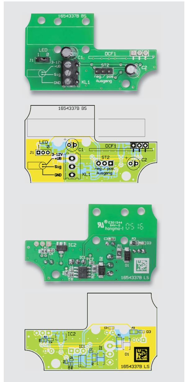
Bild 5: Die Platinenfotos und die Bestückungspläne des DCF-Moduls; oben die Oberseite mit bedrahteten Bauteilen, unten die Unterseite mit SMD-Bestückung
