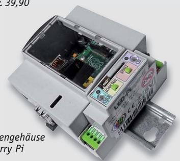
Der Hutschienenplayer empfängt via USB serielle Daten im TPM2-Format und ist über eine Datei auf der einsteckbaren SD-Karte umfangreich konfigurierbar.
