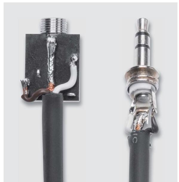
Bild 11: So werden die Kabel am Klinkenstecker bzw. an der Klinkenbuchse angelötet.
