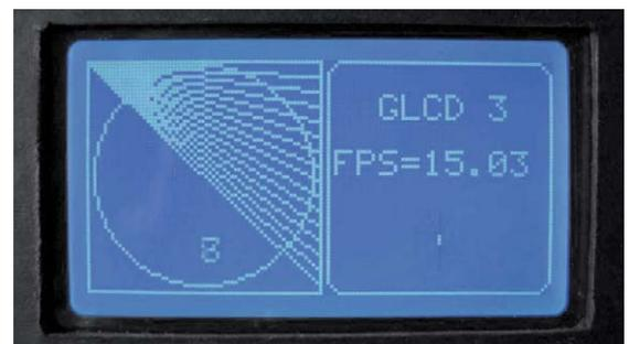
Bild 1: Arduino-Testausgabe auf dem Grafikdisplay
