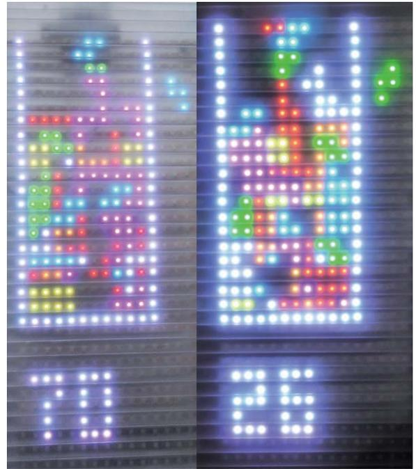
Bild 12: Das mit Doppelstegplatten und LED-Stripes bestückte Display unseres Nachbaus, links am Tage, rechts bei Dunkelheit
