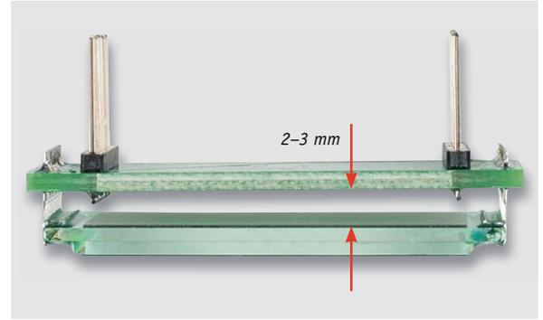
Bild 8: Das Display ist mit einem Abstand von 2-3 mm über der Platine einzulöten.
