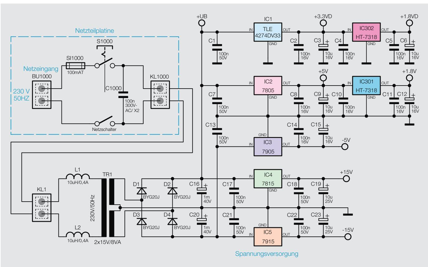
Bild 3: Schaltbild der Spannungsversorgung beim DDS 8100
