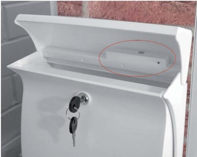
Bild 1: Anbringung des optischen Homematic Funk-Tür-/Fensterkontakts im Briefkasten
