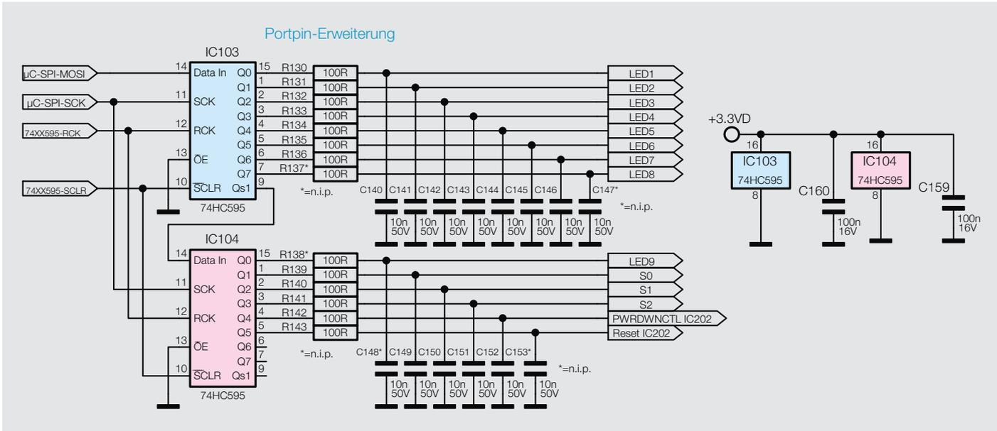
Bild 5: Schaltbild der beim DDS 8100 eingesetzten Portpin-Erweiterung
