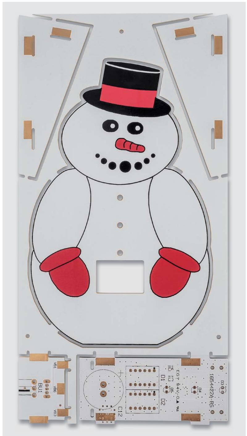
Bild 2: Die entlang der Perforation herausbrechbaren Platinen werden auf einem „Nutzen“ geliefert.
