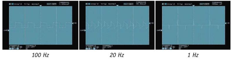
quenzbereich bis hinunter zu 0,25 Hz genutzt werden. Im geöffneten Zustand wird das Ausgangssignal über C39 kapazitiv entkoppelt. Der DC-Anteil des Signals wird dadurch eliminiert, allerdings ist nun eine untere Grenzfrequenz von 8 Hz vorhanden, d. h. dass Signale mit einer Frequenz von unter 8 Hz entsprechend gedämpft werden ...“
