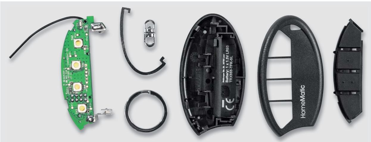
Bild 4: Die Einzelteile des Funk-Handsender-Bausatzes
