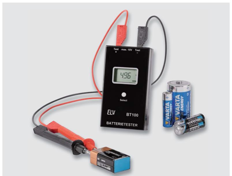
Bild 20: Das fertig aufgebaute Gerat im Betrieb
