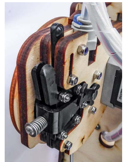
Bild 13: Auch der Extruder besteht zu großen Teilen aus raffiniert verschachtelten Holzteilen.
