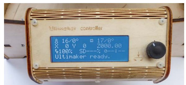
Bild 6: Der ebenfalls in einem Holzgehäuse untergebrachte Controller ermöglicht das autonome Arbeiten ohne angeschlossenen Computer.
