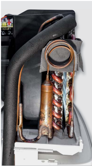
Bild 6: Hier ist das druckmindernde Kapillarrohr zu sehen.
