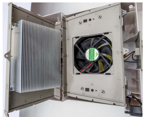
Bild 17: Die heiße Seite des Peltierelements, rechts der davor sitzende Ventilator
