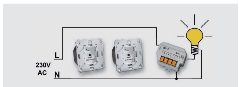
Bild 8: Wechselschaltung mit zwei Homematic Funk-Wandsendern, 2fach, für Markenschalter, Batteriebetrieb und Homematic Funk-Schaltaktor, Unterputz
