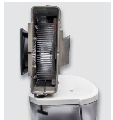
Bild 15: Das Innenleben des Peltier-Geräts, oben das Peltierelement und der Ventilator, unten der Kondensattank
