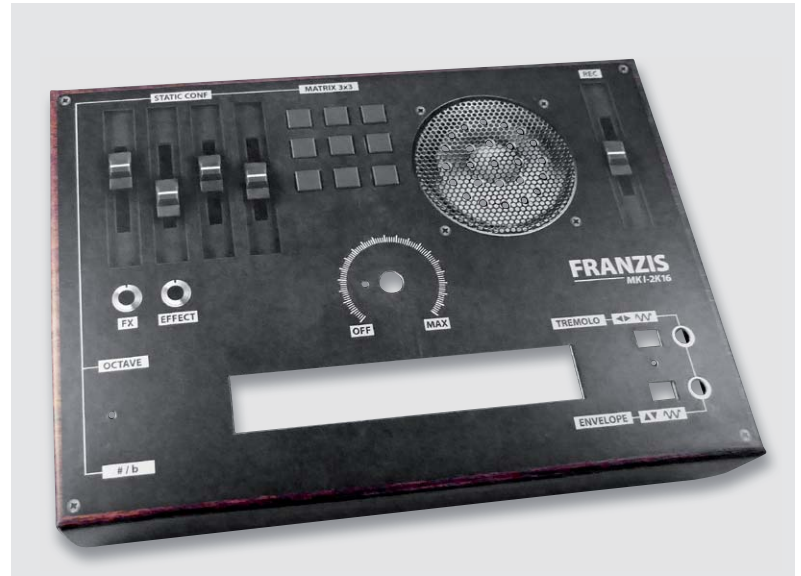
Bild 2: Die Verpackung des Bausatzes dient als fertig bearbeitetes Gehäuse für das Gerät.
