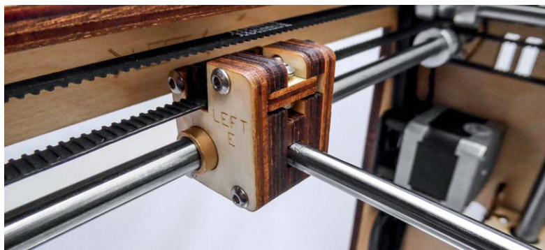
Bild 11: Ausgeklügelte Konstruktionen – die Führungsblöcke für die X-/Y-Achsen
