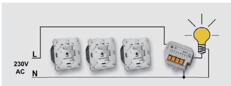
Bild 13: Kreuzschaltung mit drei Homematic Funk-Wandsendern, 2fach, für Markenschalter, Batteriebetrieb und Homematic Funk-Schaltaktor, Unterputz
