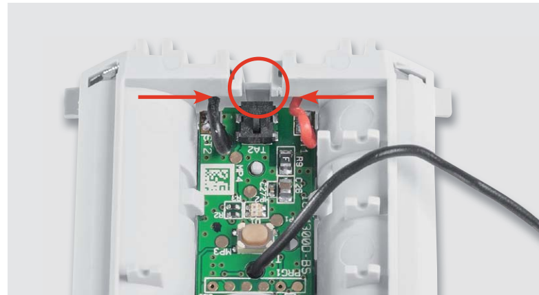
Bild 10: Die Batterieleitungen sind so zu führen, dass sie den Sabotagekontakt nicht blockieren.
