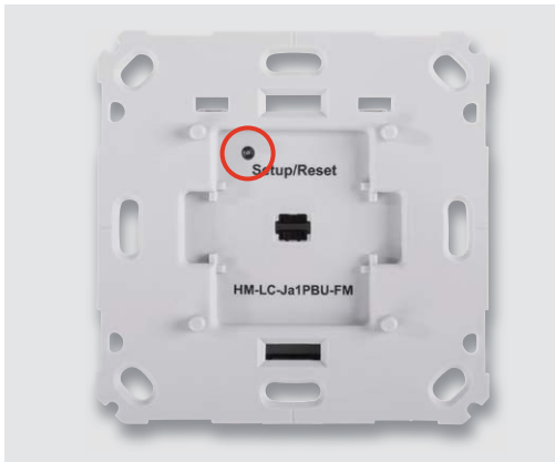
Bild 14: Nach dem Zusammenbau des Gehäuses ist mit einem spitzen Gegenstand die Beweglichkeit des Tasterstößels zu testen.
