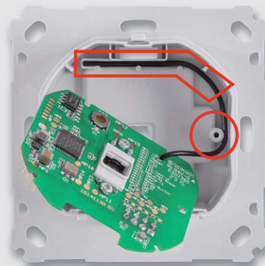
Bild 9: ... danach die Transceiver-Antenne fixiert ...
