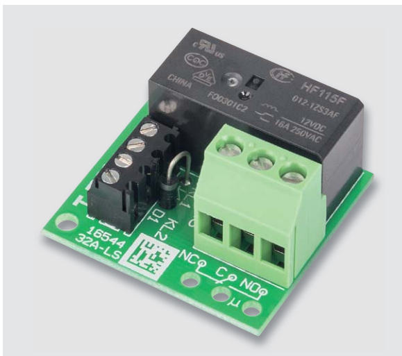
Bild 7: Die vollständig bestückte Platine des Relais-Schaltmoduls
