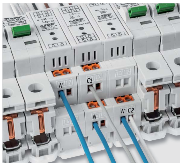
Bild 13: So erfolgt die Verdrahtung der beteiligten Bausteine, hier mit einem Schalt- und einem Dimmaktor.
