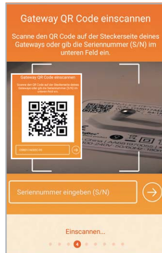
Bild 6: Dann wird aus der App heraus der QR-Code des WLAN-Gateways eingescannt, alternativ kann die Seriennummer manuell eingegeben werden.
