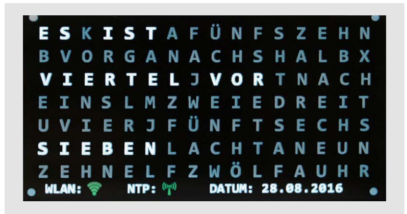
Bild 5: Die Uhrenanzeige 1 ist in Form der bekannten WordClock gestaltet.
