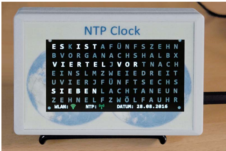
Bild 2: Die in ein dekoriertes Gehäuse eingebaute Uhr wird von einem externen 5-V-Netzteil versorgt.
