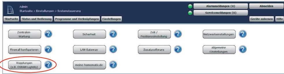
Bild 16: Um das LIGHTIFY Gateway nun mit der CCU2 zu koppeln, öffnet man in der CCU2 „Einstellungen“ → „Systemsteuerung“ und hier den Menüpunkt „Kopplungen“ (z. B. OSRAM LIGHTIFY).
