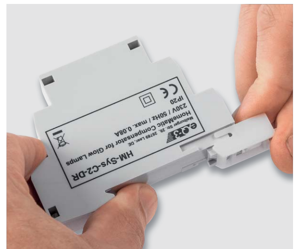
Bild 10: Zum Schluss erfolgt, wie hier gezeigt, das Aufsetzen des Rastschiebers.
