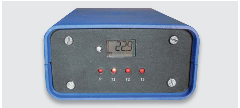
Bild 7: Eine Klima-Messstation mit I 2 C-Sensoren im Eigenbau
