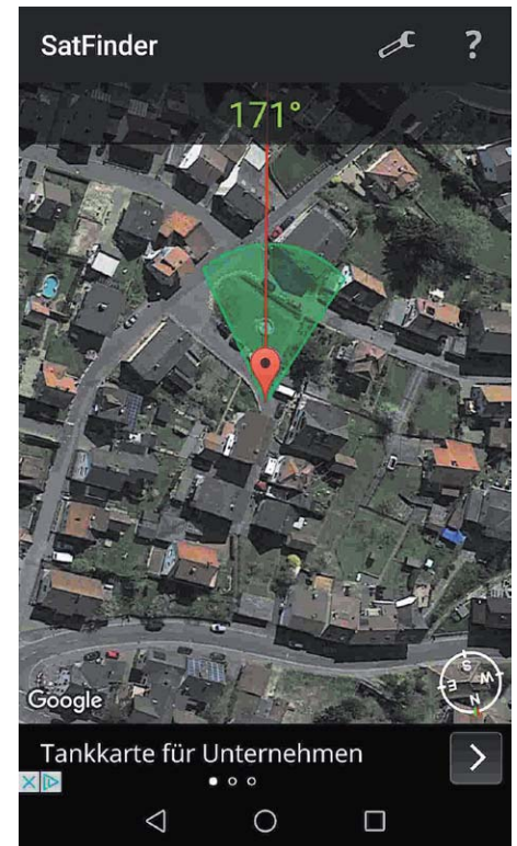
Bild 6: Der Peilstrahl in Richtung des Satelliten in der Vogelperspektive auf das Satellitenantennenumfeld
