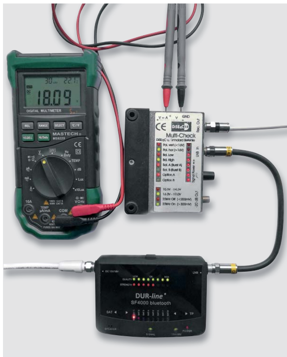
Bild 10: Diese Messanordnung bestätigt, dass der SF 4000 BT die Gleichspannungswerte ohne und mit überlagerter 22-kHz-Modulation zur Anwahl von Polarisation und Band korrekt erzeugt.
