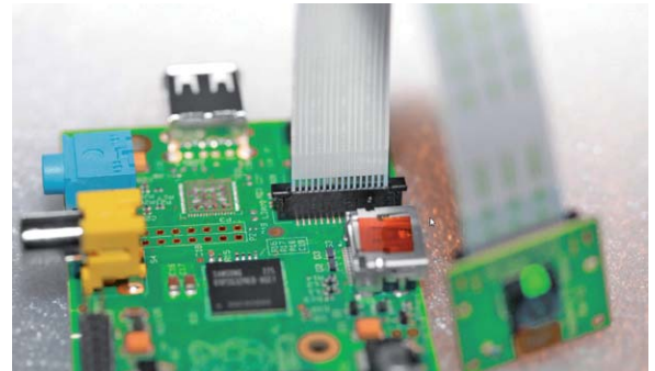
Bild 3: Beim Anschluss in den CSI-Pfosten zeigen die Anschlüsse des Flachbandkabels in Richtung HDMI-Anschluss auf der Raspberry-Pi-Platine.
