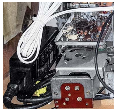
Bild 10: Das Notebook-Netzteil wurde mit im Gehäuse untergebracht.
