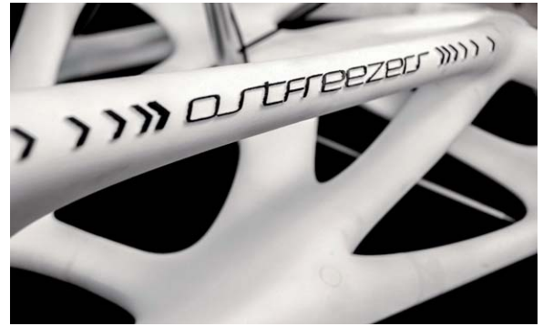
Für das Akkuschauber-Rennen 2016 konstruierte Theresa Schill mit anderen Studierenden ein organisches Liegerad, dessen Bestandteile im 3D-Drucker gefertigt wurden. Bild: Hochschule Emden/Leer
