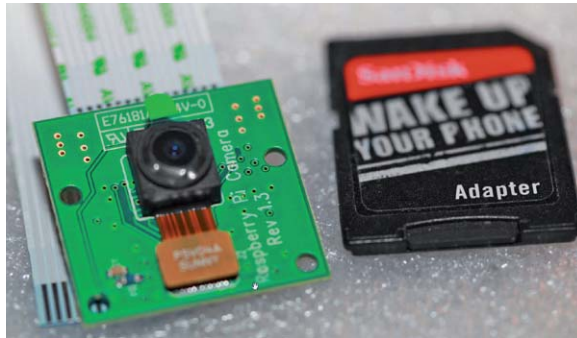
Bild 2: Das im Juni 2013 ausgelieferte Raspberry-Pi-Kameramodul (Best.-Nr. CO-11 56 27) trägt die Revision V1.3 und ist in etwa so groß wie eine SD-Karte.
