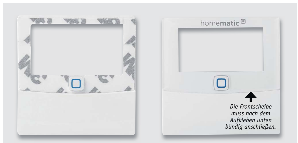
Bild 7: Nach dem Abziehen der Schutzfolie wird die Frontscheibe des Sensorgehäuses aufgeklebt.
