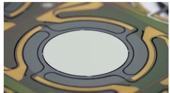
Bild 4: In MEMS-Technik ausgeführter Prototyp eines Smartphone-Lautsprechers (Bild: Fraunhofer Institut für Siliziumtechnologie ISIT)
