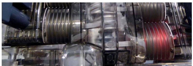
Bild 6: Simulieren die Zündfunken und sind dank transparenter Abdeckungen gut zu sehen – aufblitzende LEDs.
