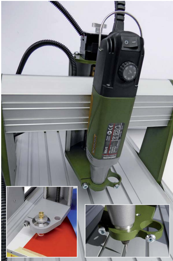
Bild 1: Die Spannvorrichtungen ermöglichen den Anbau zahlreicher Werkzeuge und Hilfseinrichtungen.
