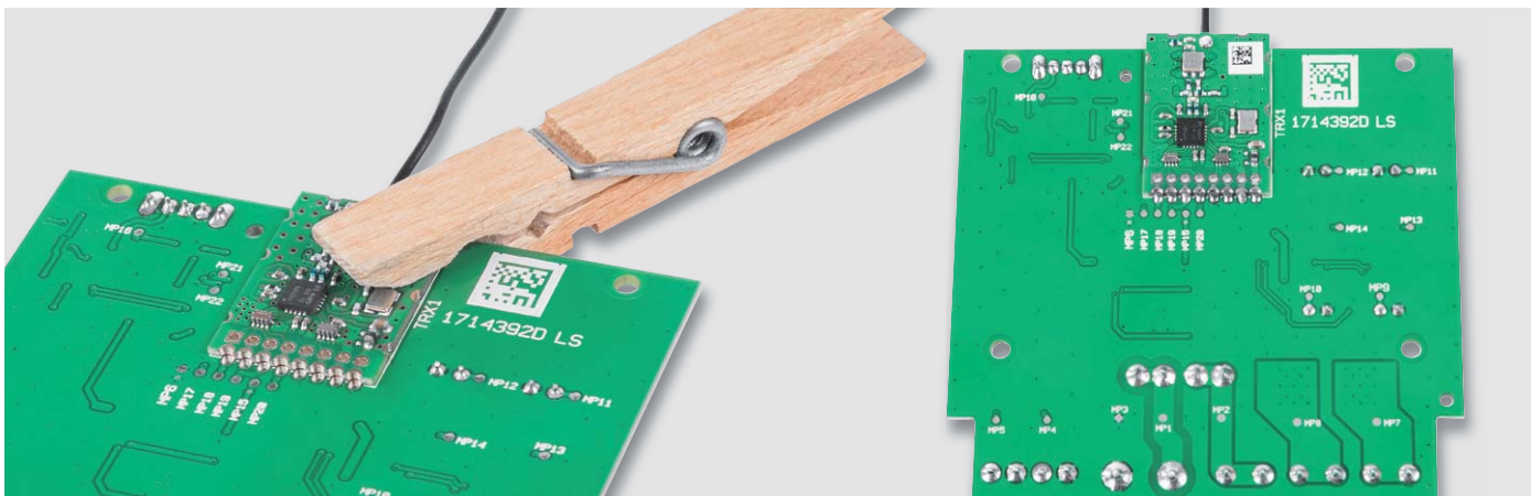
Bild 20: Zum Auflöten des Transceiver-Moduls sollte dieses fixiert werden, um eine exakte Lage beim Verlöten zu erhalten. Es hat sich bewährt, zuerst nur einen Anschluss zu verlöten, die Lage des Moduls zu kontrollieren und danach alle restlichen Anschlüsse zu verlöten.
