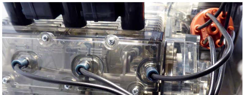
Bild 3: Ein real funktionierender Zündverteiler steuert die (LED-)Kerzen an.
