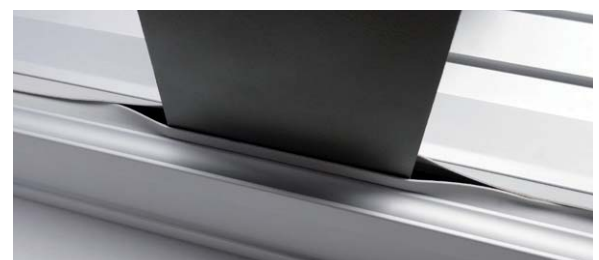
Bild 4: Selbstschlie- ßende Gummilippen schützen die Spindeln vor unnötigem Verschleiß.
