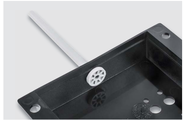
Bild 22: Hier ist der in die Gehäuseoberseite eingesetzte Antennenhalter zu sehen, in den im nächsten Schritt ...
