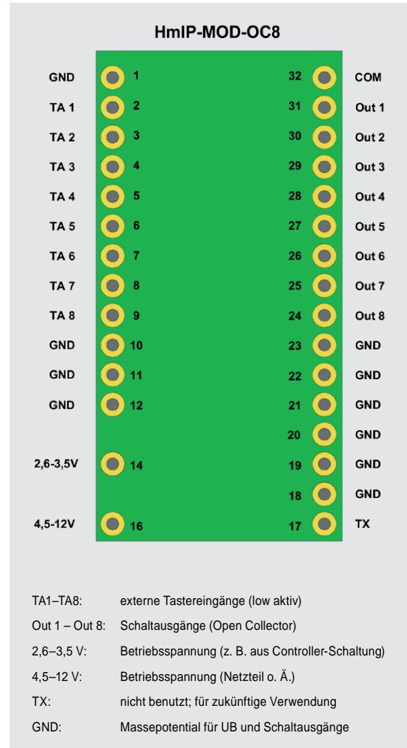
Bild 12: Anschlussbelegung der Stiftleisten
