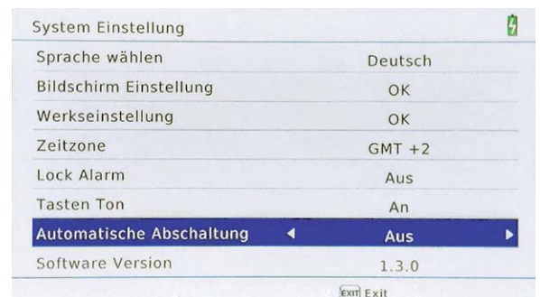
Bild 5: Im Menü System-Einstellung werden die Grundeinstellungen wie Menüsprache, Helligkeit, Farbe und Kontrast, Zeitzone, Tastenton usw. vorgenommen.
