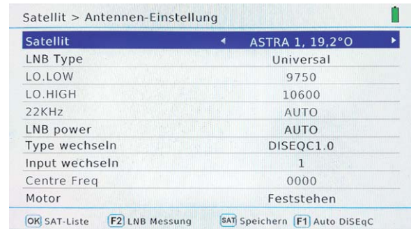
Bild 8: Hier werden elementare Einstellungen in Bezug auf den vorliegenden Antennentyp getroffen, z. B. Typ des LNBS, seine Lokaloszillatorfrequenzen und Betriebsspannungen, DiSEqC-Typ usw.
