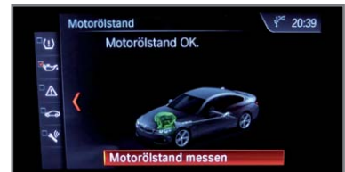
Bild 3: Ersatz für den alten Ölpeilstab – Motorölstandsanzeige im Bordcomputer
