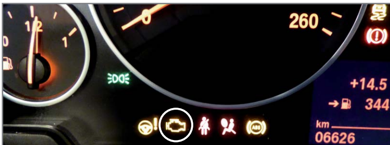
Bild 1: Vor dem Motorstart muss die Motorkontrollleuchte zur Kontrolle aufleuchten. Leuchtet sie danach auf, liegt ein Fehler im Motor-/Abgasmanagement vor.
