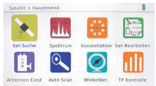
Bild 6: Das Satelliten-Hauptmenü ist der Verteiler auf die mit dem Satellitenempfang verbundenen Grundaufgaben: Sat-Suche, Anzeige von Spektrum und Konstellationsdiagramm, Programmsuche, Azimut- und Elevationsberechnung, Einstellungen auf den verwendeten LNB-Typ usw.
