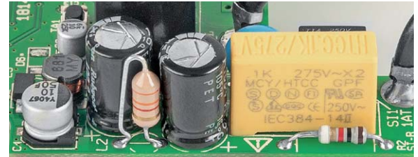
Bild 4: Detailaufnahme der stehenden Bestückung vom L2
