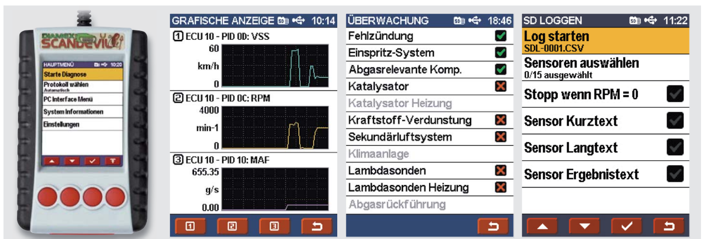
Bild 10: Mit einem Multifunktionsscanner können Live- und Protokolldaten grafisch visualisiert, ein Log aufgenommen und Daten an einen PC übergeben werden. Der Scandevil kann sogar bei der Einstellung von Autogas-Anlagen helfen.
