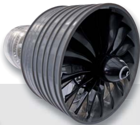
Bild 11: Der vorn auf das Triebwerk montierte Fan
