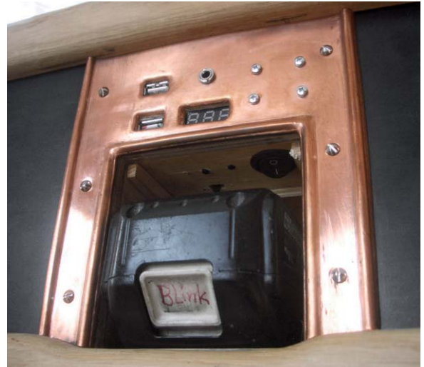
Bild 2: Die Geräterückseite mit Akkufach und Anschlüssen
