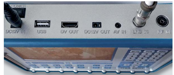
Bild 3: In der Geräteoberseite finden sich neben dem Ein-Aus-Schalter alle Buchsen, die zur elektrischen Versorgung des Megasat HD 5 Combo mit Betriebsenergie und Eingangssignalen sowie zum Anschluss von HDMI-Monitor, externer Kamera und USB-Speicher erforderlich sind.
