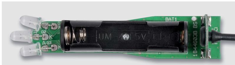
Bild 4: So erfolgt das Einlöten des Batteriehalters.
