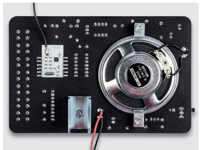
Bild 8: Die vollständig bestückte Rückseite des Radio-Bausatzes
