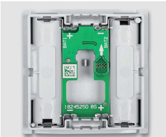
Bild 14: Die in das Gehäuse eingesetzte Batterieplatte
