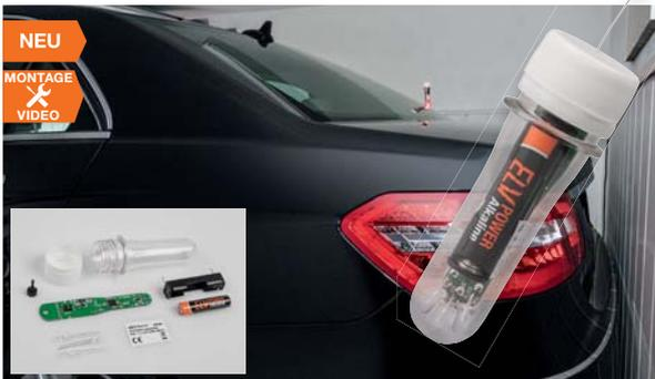
Der Erschütterungssensor im PET-Rohling ist vor allem für sicheres, unkompliziertes Einparken z. B. in einer vollen Garage konzipiert. Ein Anstoßen an einer Autoscheibe registriert der Sensor mit einer auffälligen Blinkfolge.
