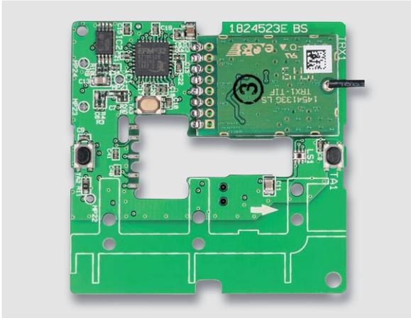
Bild 8: Die Basisplatine mit dem aufgelöteten TRX1-Funkmodul
