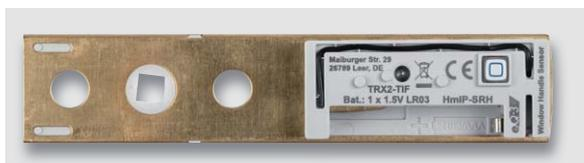
Bild 10: So wird die Antenne exakt in das Gehäuse eingelegt.
