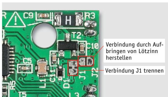
Verbindung durch Aufbringen von Lötzinn herstellen
