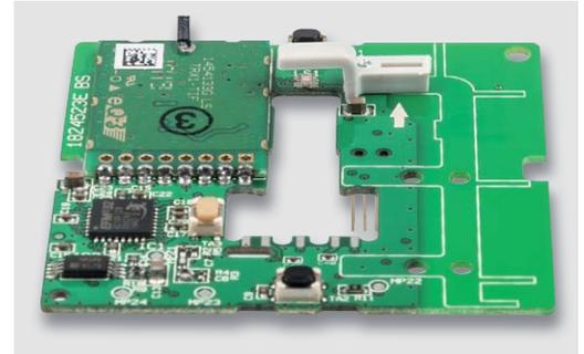
Bild 10: Die Basisplatine mit dem aufgeschraubten Hilfsträger
