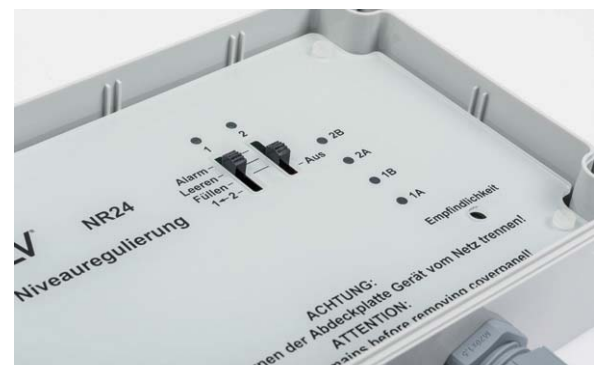
Bild 2: Die verschiedenen Betriebsmodi werden für beide Schaltkanäle getrennt über zwei Schiebeschalter gewählt.
