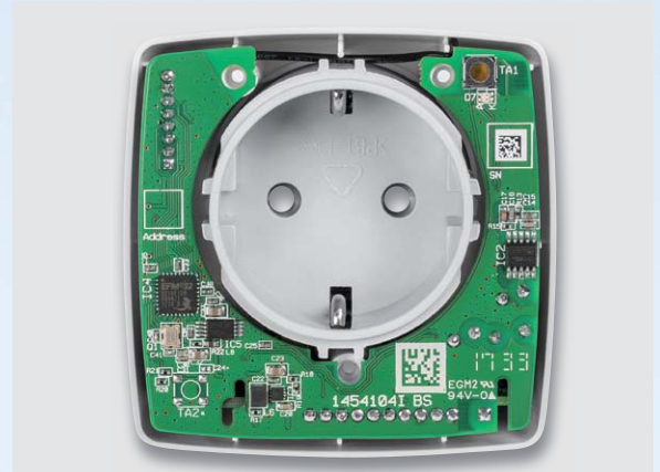
Bild 14: Die Antenne muss durch die Platine festgeklemmt sein, damit sie nicht verrutschen kann.
