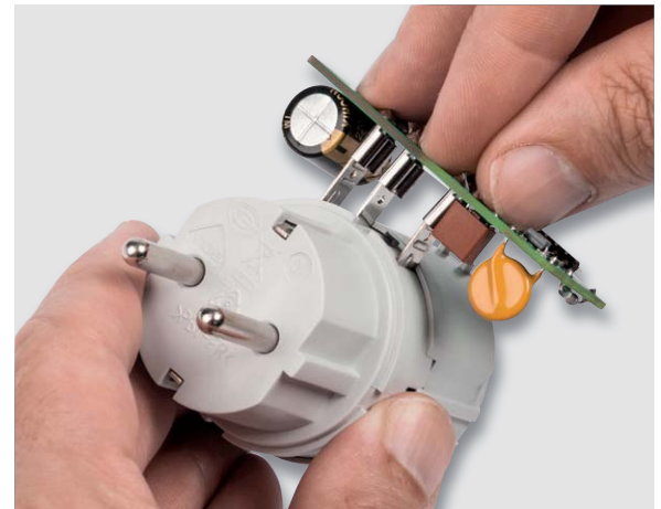
Bild 10: So erfolgt das Aufstecken der bestückten Netz-/Speicher-kondensatorplatine auf die Stecker-Steckdosen-Einheit.
