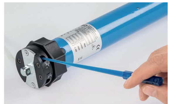
Bild 9: Die Einstellung eines mechanischen Rohrmotors erfolgt über flexible Stellstifte, die in die jeweilige Aufnahme für die obere und untere Endlage gesteckt werden.
