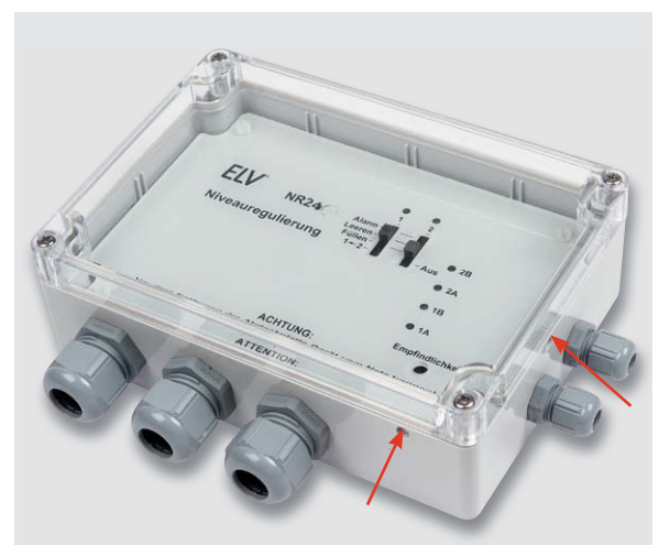
Bild 27: ... und gegebenenfalls eine der beiden Entwässerungsöffnungen durchstoßen oder aufgebohrt.
