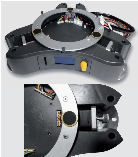
Bild 2: Drei empfindliche Piezo-Sensoren melden jede Belastungsdifferenz auf der Druckfläche und ermöglichen so eine automatische Kalibrierung.
