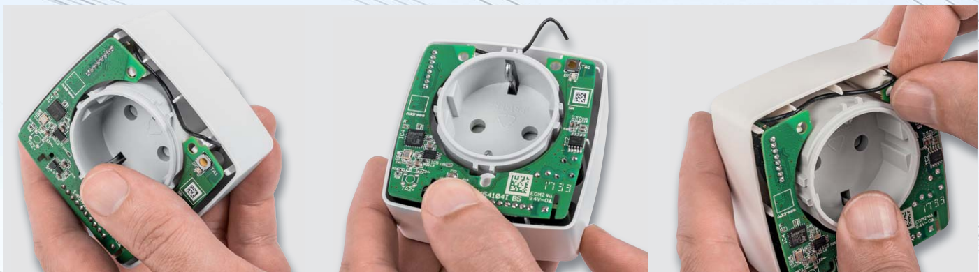
Bild 13: So wird der Antennendraht geführt, abgewinkelt und schließlich fixiert.
