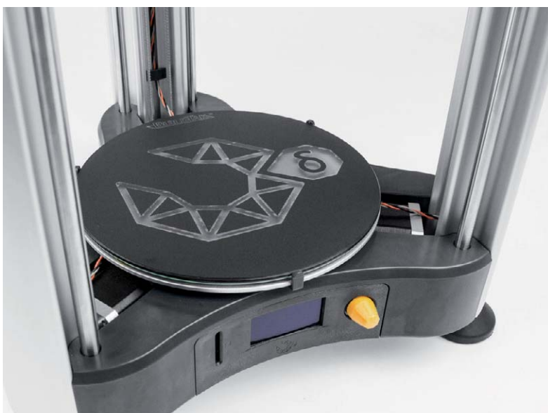
Bild 11: Mit dem Aufkleben der BuildTak-Druckunterlage auf die Glasplatte und deren Einlegen in die Druckplattform ist der Aufbau abgeschlossen.
