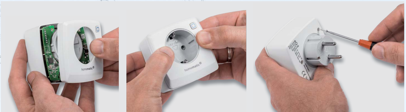
Bild 15: Den Abschluss des Aufbaus bildet das Aufsetzen und Verschrauben der Gehäuseoberchale.
