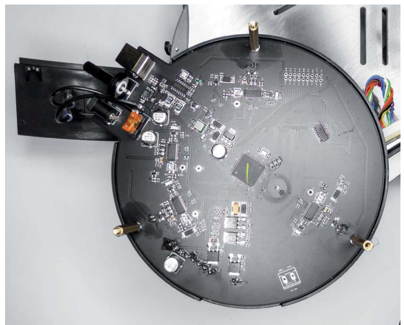
Bild 7: Die gesamte Elektronik ist auf einer Platine im Fuß des 3D-Druckers verbaut.
