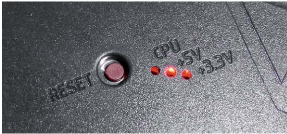
Bild 8: Kann bei auftretenden Fehlern hilfreich sein – Reset-Taste und Betriebsanzeigen unter der Druckplattform
