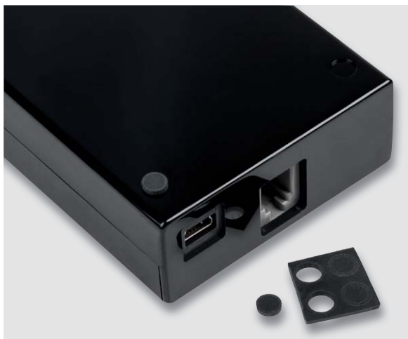
Bild 29: Ankleben der 4 Gehäusefüße an der Gehäuseunterseite
