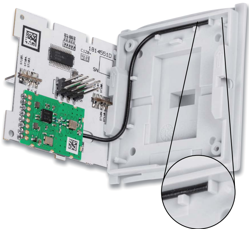
Bild 12: Die Antenne des Transceivermoduls ist genau wie hier gezeigt einzulegen.
