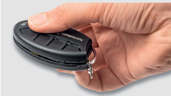
Bild 16: Zum Zusammensetzen der Gehäuseschälten ist zunächst die Gehäuseoberschale von der Batterieseite her seitlich einzusetzen (oben), danach drückt man beide Gehäuseschalen bis zum Einrasten zusammen.
