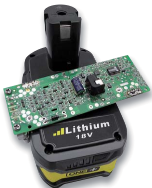
Bild 6: Aufwendiges BMS für einen 18-V-Werkzeugakku
