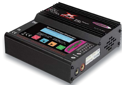
Bild 9: In dieser und ähnlichen Ausführungen zigtausendfach bewährt – typische Modellbaulader mit Balancerports für Lithium-Akkus. Bild: Jamara
