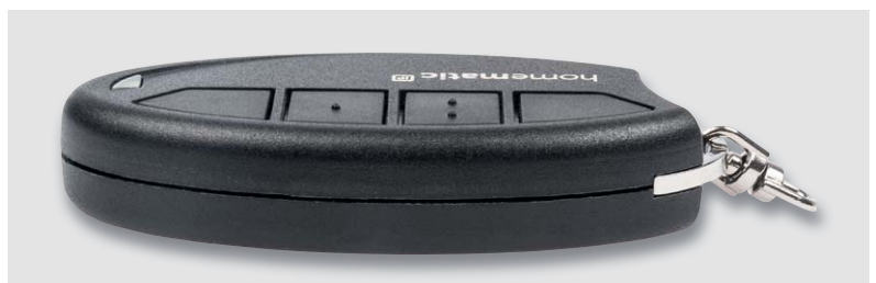
Bild 18: Zum Abschluss erfolgt eine Rundum-Kontrolle auf ein gleichmäßiges Spaltmaß zwischen den Gehäuseschalen.
