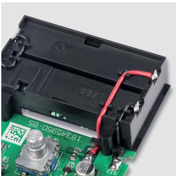
Bild 25: Anlöten der Batterie-Anschlussleitungen an die Löt pads der Leiterplatte
