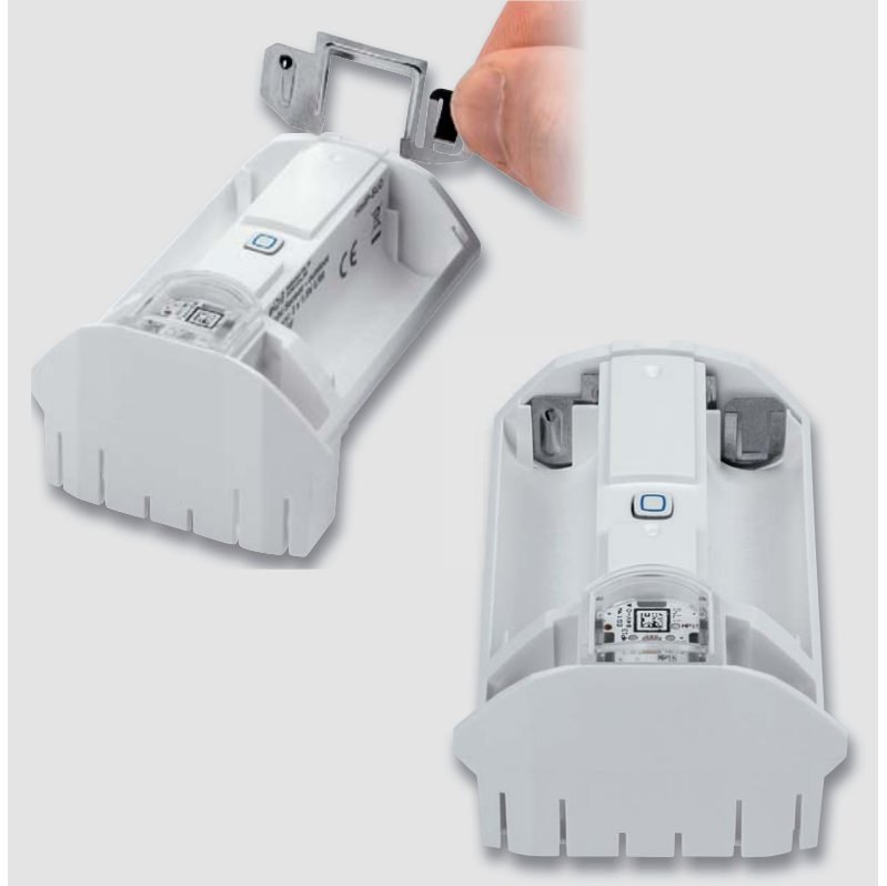
Bild 17: Das Einsetzen des gegenüberliegenden Batteriekontakts: Eindrücken, bis er sicher verrastet ist.
