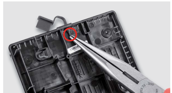
Bild 6: Mithilfe einer Spitzzange wird der USB-Blindstopfen durch die Öffnung gezogen.
